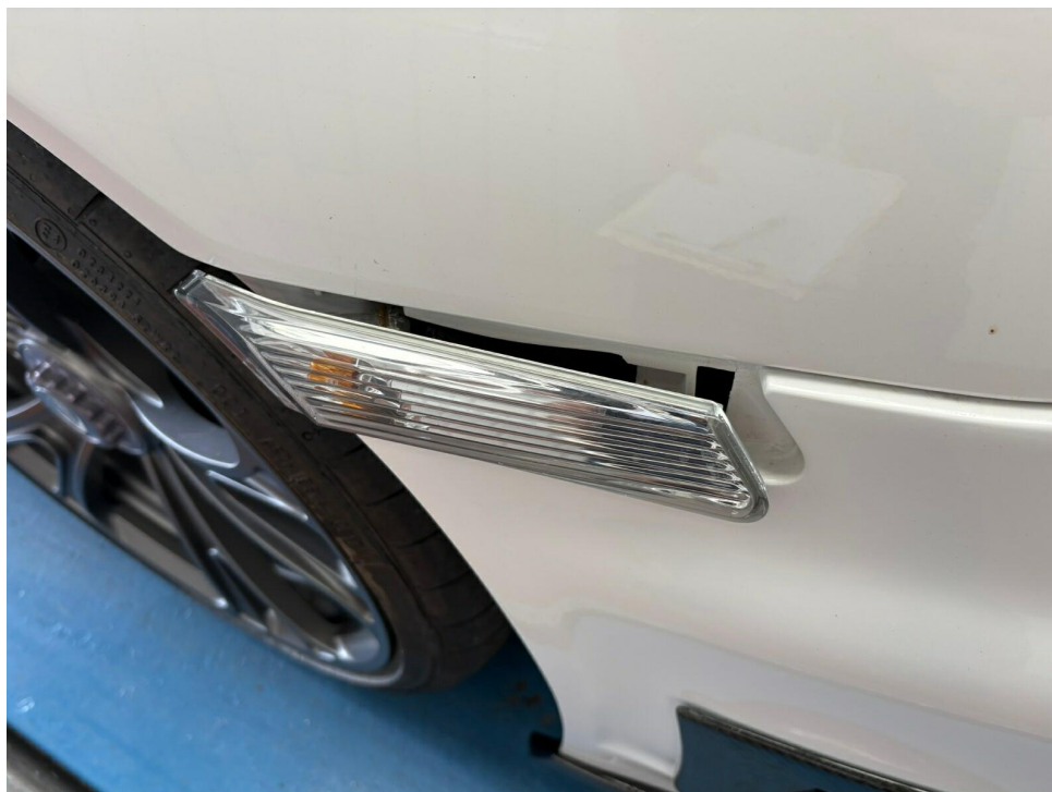
Bild 43 : Blinker seitlich recht ausgebrochen
