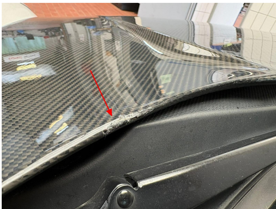
Bild 37 : Carbon Fronthaube gebrochen
