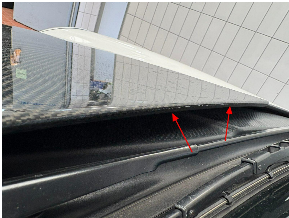
Bild 38 : Carbon Fronthaube gebrochen
