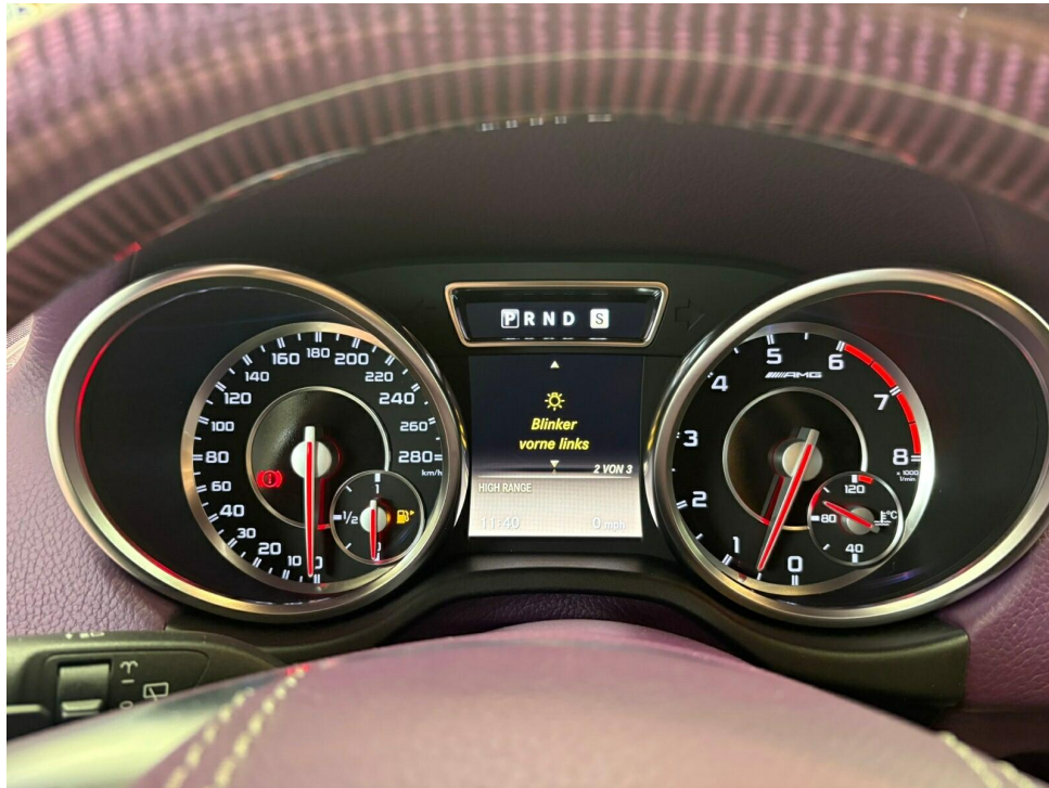
Bild 49 : Fahrtrichtungsanzeiger vorne und hinten links defekt
