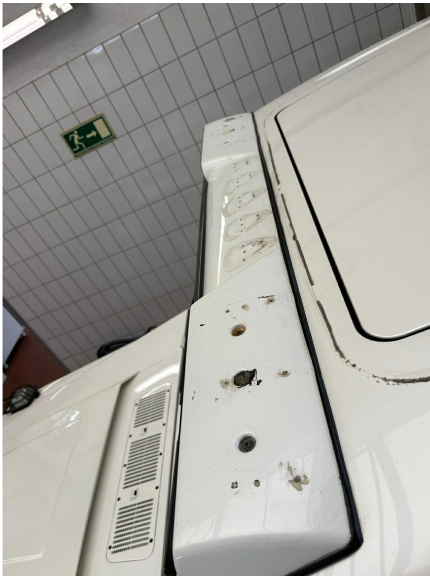
Bild 32 : Dachspoiler/Windabweiser Schiebedach fehlt
