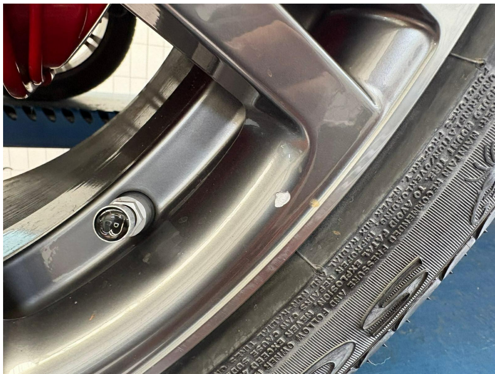
Bild 43 : Felge hinten links mehrfach verschrammt
