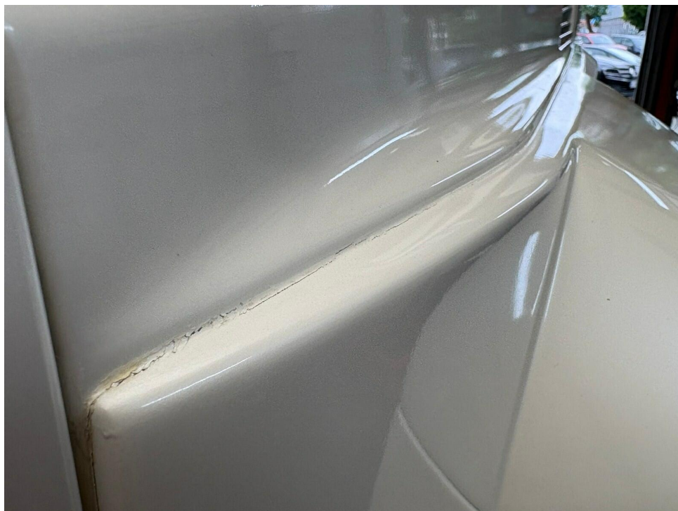
Bild 38 : Kotflügel/Kotflügelverbreiterung unsachgemäß instandgesetzt, Lack gebrochen
