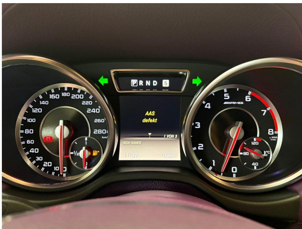
Bild 48 : Fehlermeldung "AAS defekt" im Display
