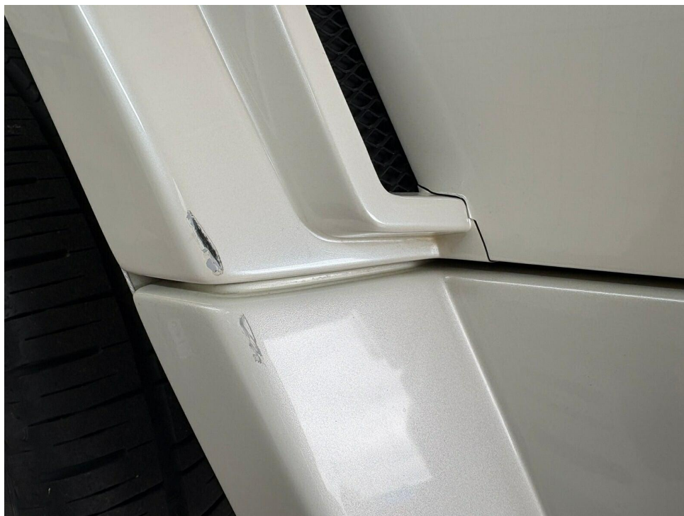
Bild 45 : Radlaufverkleidung hinten links gebrochen
