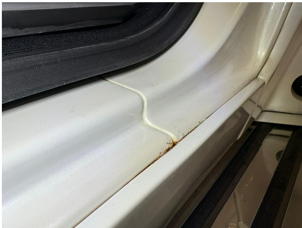
Bild 41 : Schweller vorne rechts korrodiert
