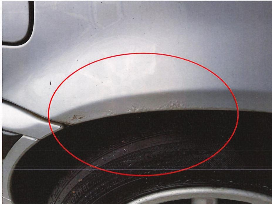
Bild 15 : Radlauf angerostet
