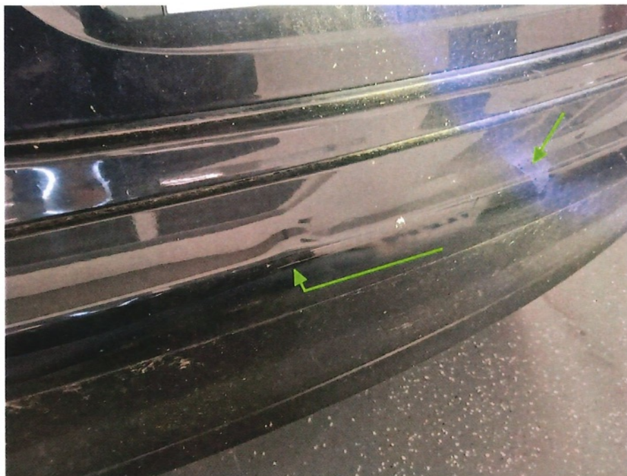
Bild 19 : Nicht reparierter Vorschaden: Stoßfänger hinten nicht fachgerecht instandgesetzt
