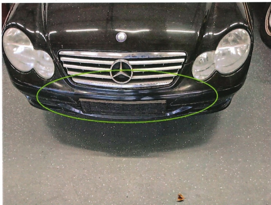
Bild 8 : Nicht reparierter Vorschaden: Stoßfänger vorne Klarlack matt
