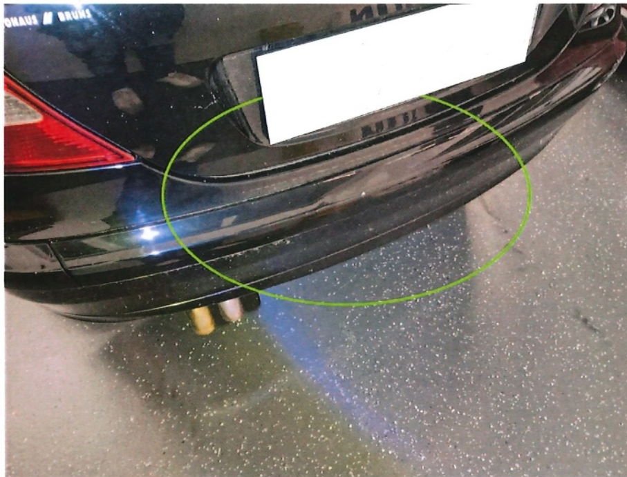
Bild 17 : Nicht reparierter Vorschaden: Stoßfänger hinten nicht fachgerecht instandgesetzt
