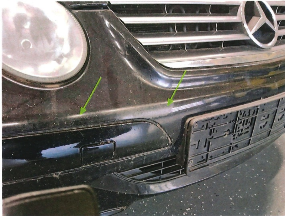
Bild 9 : Nicht reparierter Vorschaden: Stoßfänger vorne Klarlack matt
