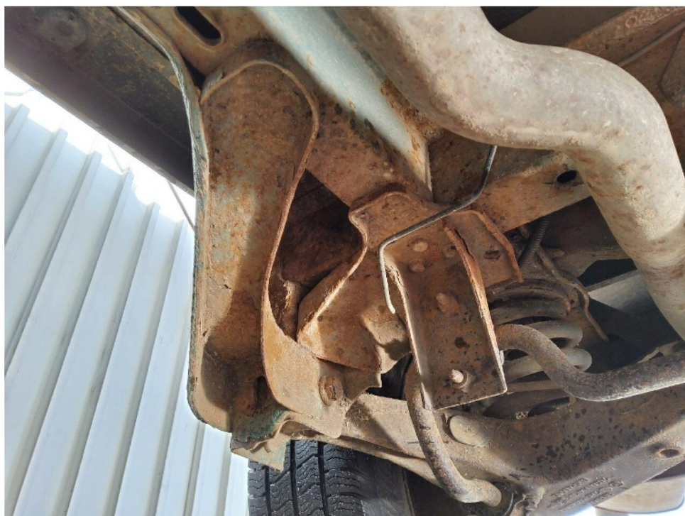
Bild 12 : Korrosion an Achteilen und der Karosserie
