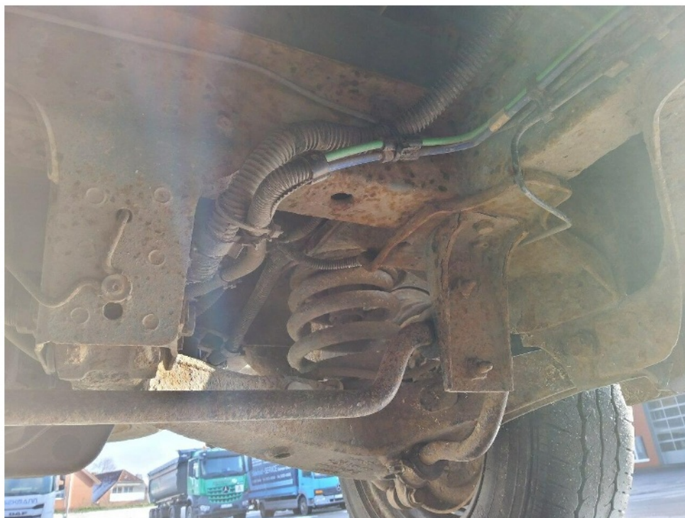
Bild 13 : Korrosion an Achteilen und der Karosserie
