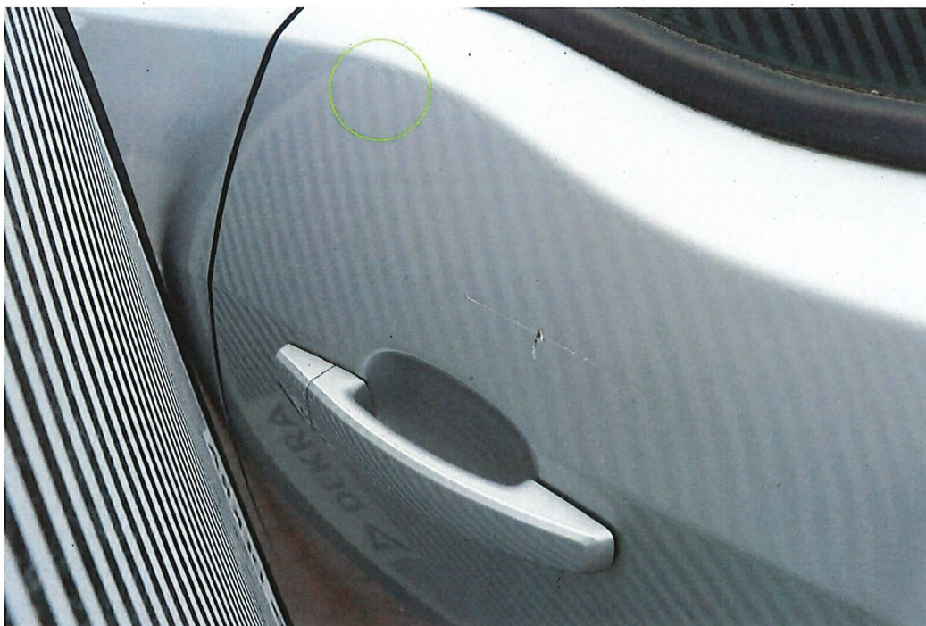
Bild 10 : Fondtür links verkratzt mit Korrosionsbildung und eingedellt
