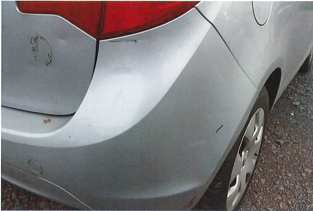
Bild 13 : Hintere Stoßfängerverkleidung verkratzt und gebrochen
