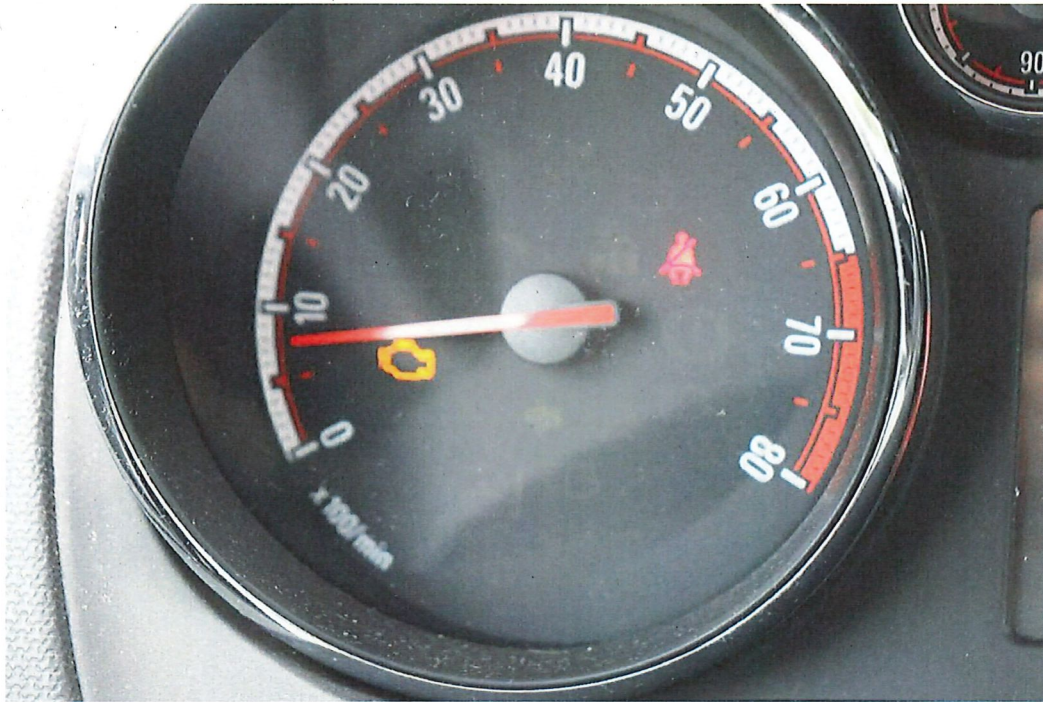
Bild 5 : Motorkontrollleuchte signalisiert Fehlfunktion
