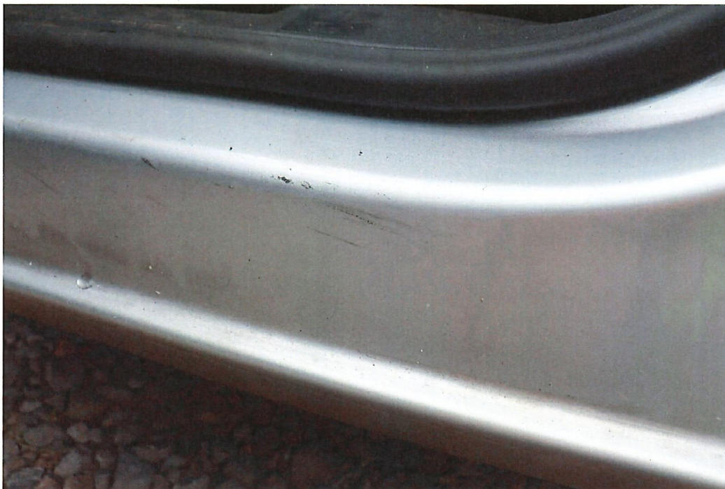
Bild 7 : Einstieg vorne links verschrammt
