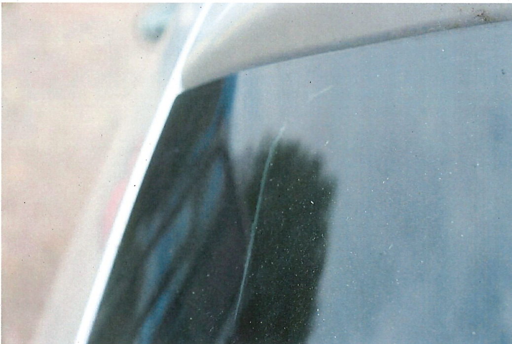
Bild 16 : Heckscheibe Dichtung eingerissen
