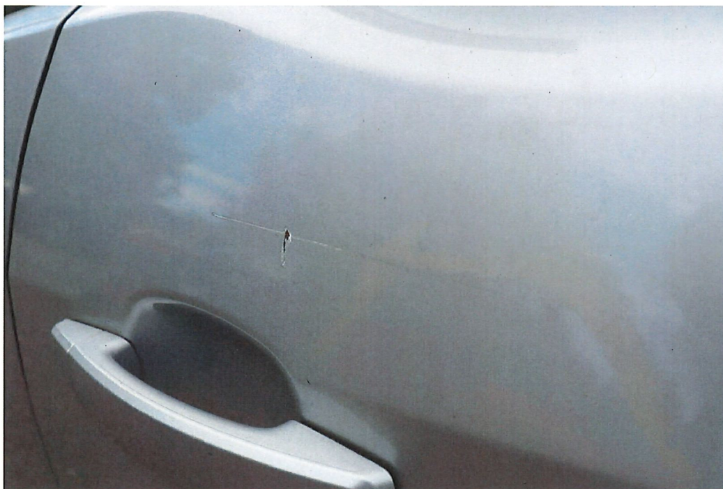
Bild 9 : Fondtür links verkratzt mit Korrosionsbildung und eingedellt
