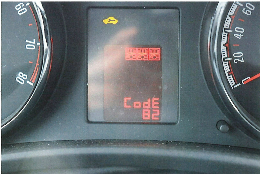
Bild 6 : Kombiinstrument signalisiert Fehlfunktion (Fehlercode 82)
