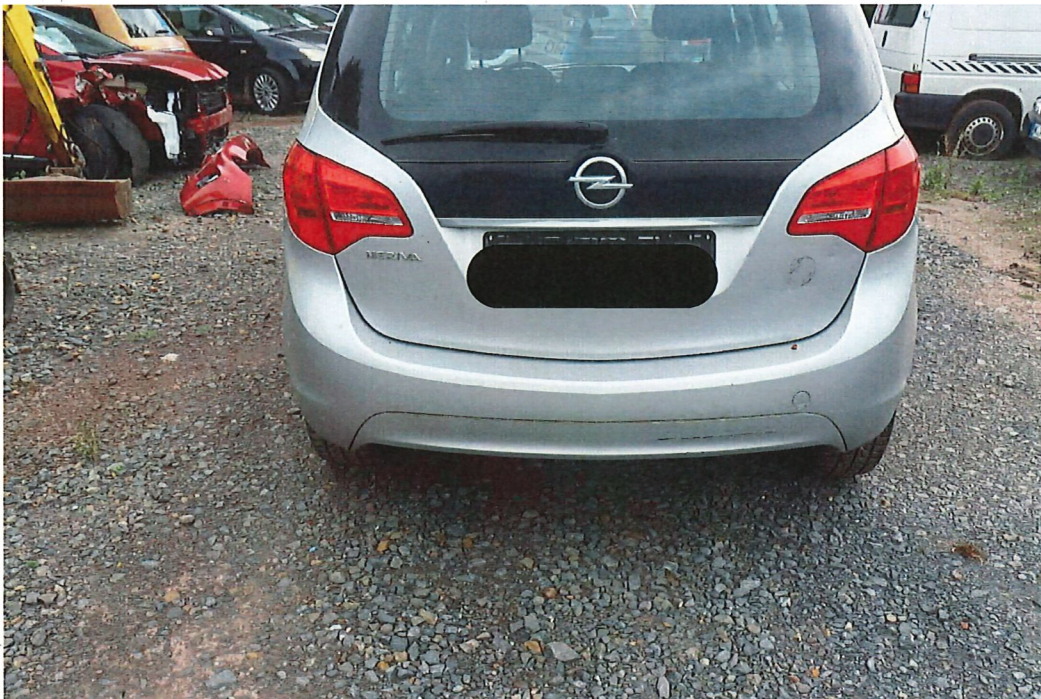
Bild 12 : Hintere Stoßfängerverkleidung verkratzt und gebrochen
