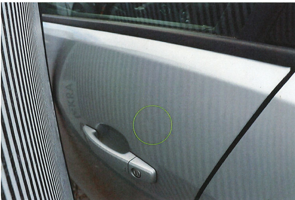
Bild 8 : Fahrertür verkratzt und eingedellt
