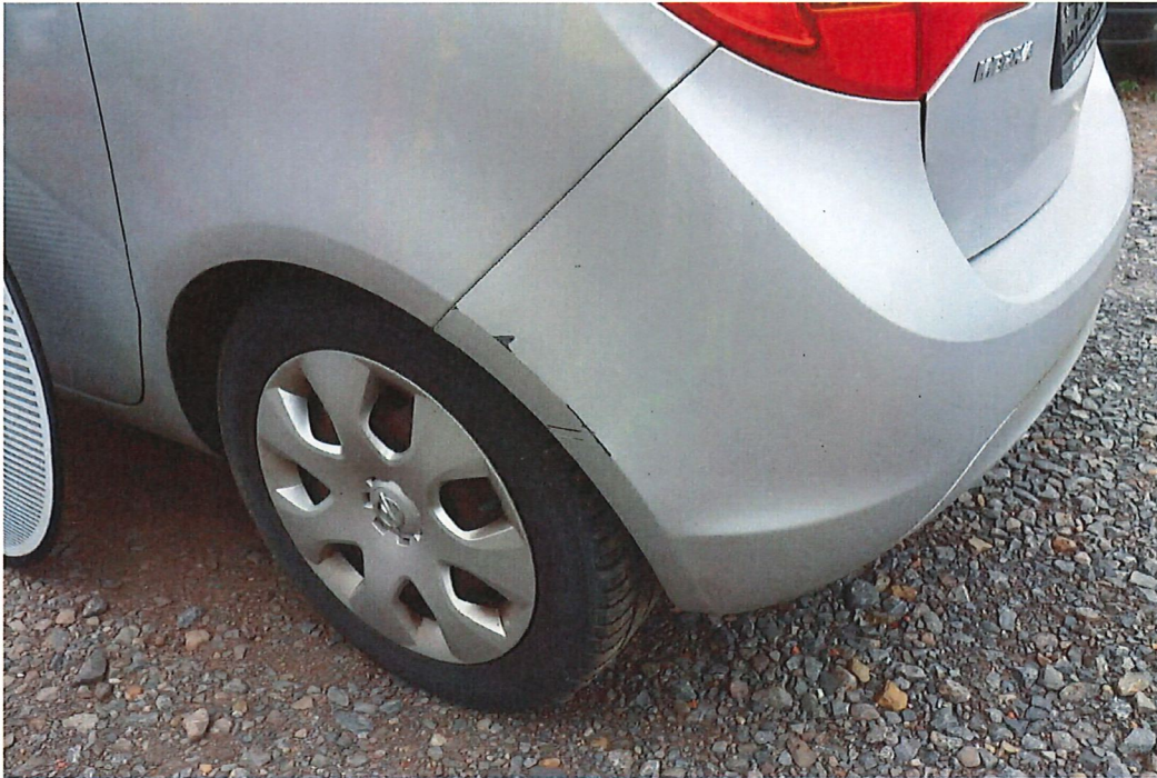
Bild 11 : Hintere Stoßfängerverkleidung verkratzt und gebrochen
