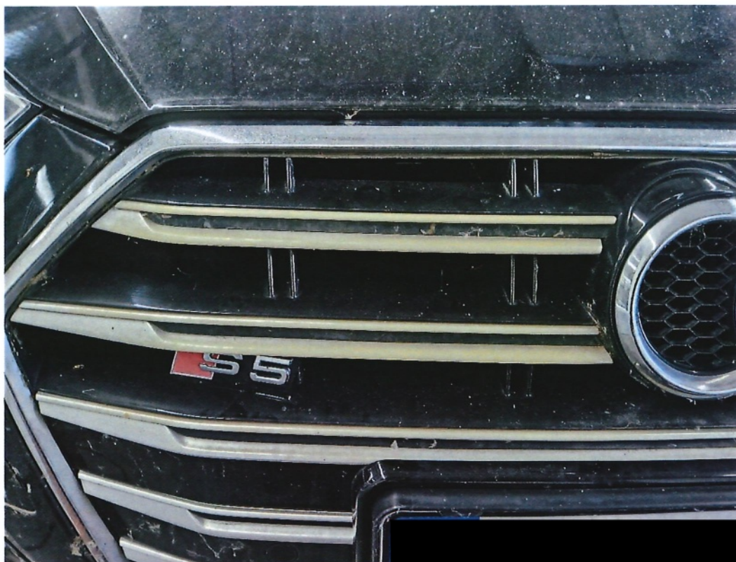
Bild 9: detaillierterer Blick auf die ausgeblinden Chromzierleisten im Frontbereich (beispielhaft)
