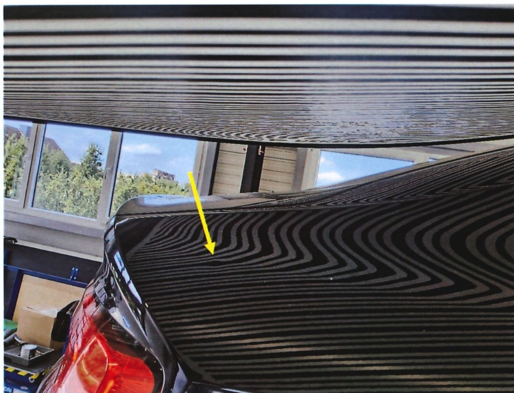
Bild 16: Blick auf die in der hinteren rechten Seitenwand vorhandene Eindellung
