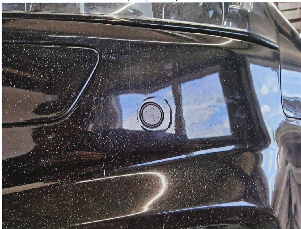
Bild 10: beispielhaft für die an den Ultraschallsensoren (Einparkhilfe) vorhandenen Verwerfungen in der Stoßfängerverkleidung
