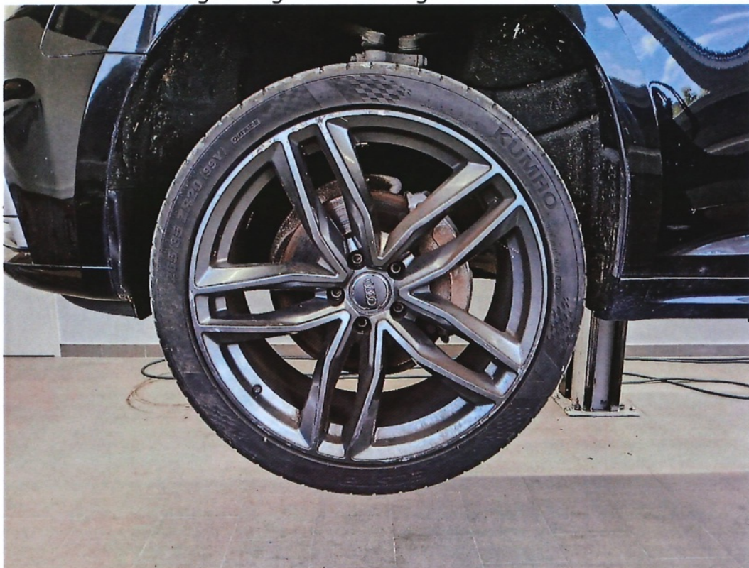
Bild 6: Übersicht der montierten Rad-Reifenkombination (Nachweise der Zulässigkeit fehlt und beispielhafte Darstellung des Zustands der Fahrzeugfelgen (mehrfache Kratz- und Schrammspuren mit Materialabtrag)
