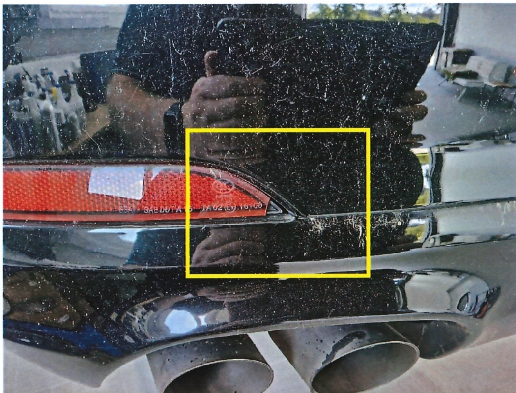
Bild 15: Blick auf einen gebrochenen Reflektor an der hinteren Stoßängerverkleidung (hier im Bild linke Seite)
