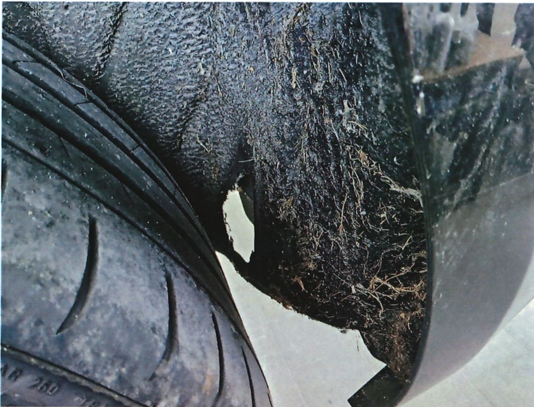
Bild 13: Blick auf die durchgescheuerte Radhausinnenverkleidung (Hinterachse links)
