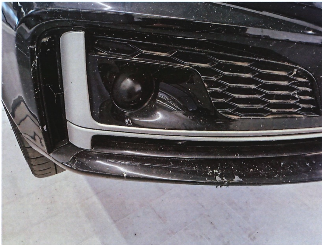
Bild 8: detaillierterer Blick auf die im Frontbereich vorhandenen Lackabplatzungen (beispielhaft)
