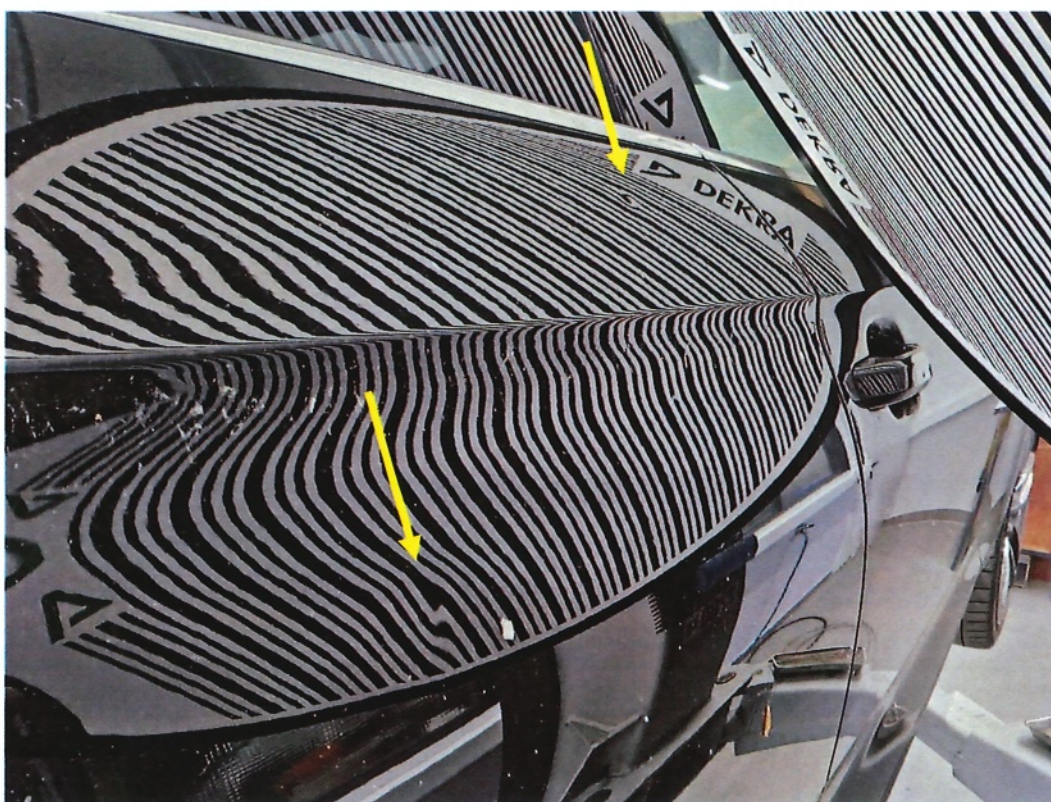
Bild 18: Blick auf die in der hinteren rechten Tür vorhandenen Eindellungen
