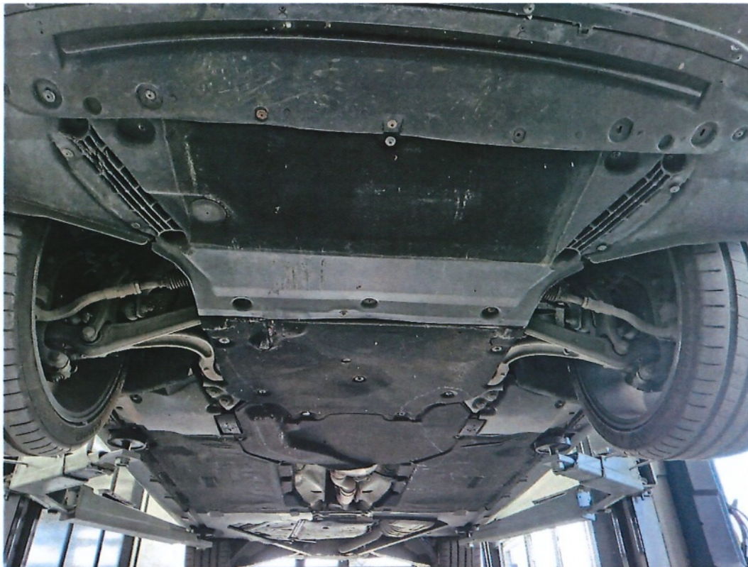
Bild 21: Blick auf die verkratzte, verschürfte und verschrammte Unterbodenverkleidung im Frontbereich (mit teilweise fehlenden Befestigungsmitteln)
