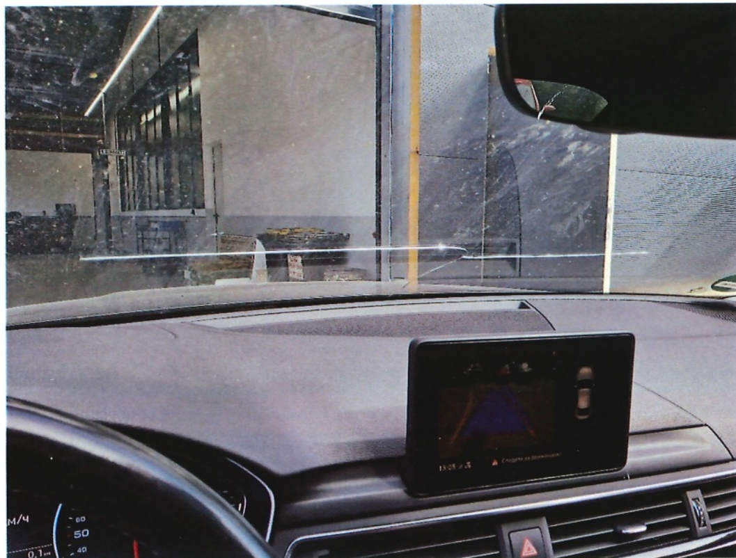
Bild 24: Blick auf die vorhandene Rissbildung in der Frontscheibe
