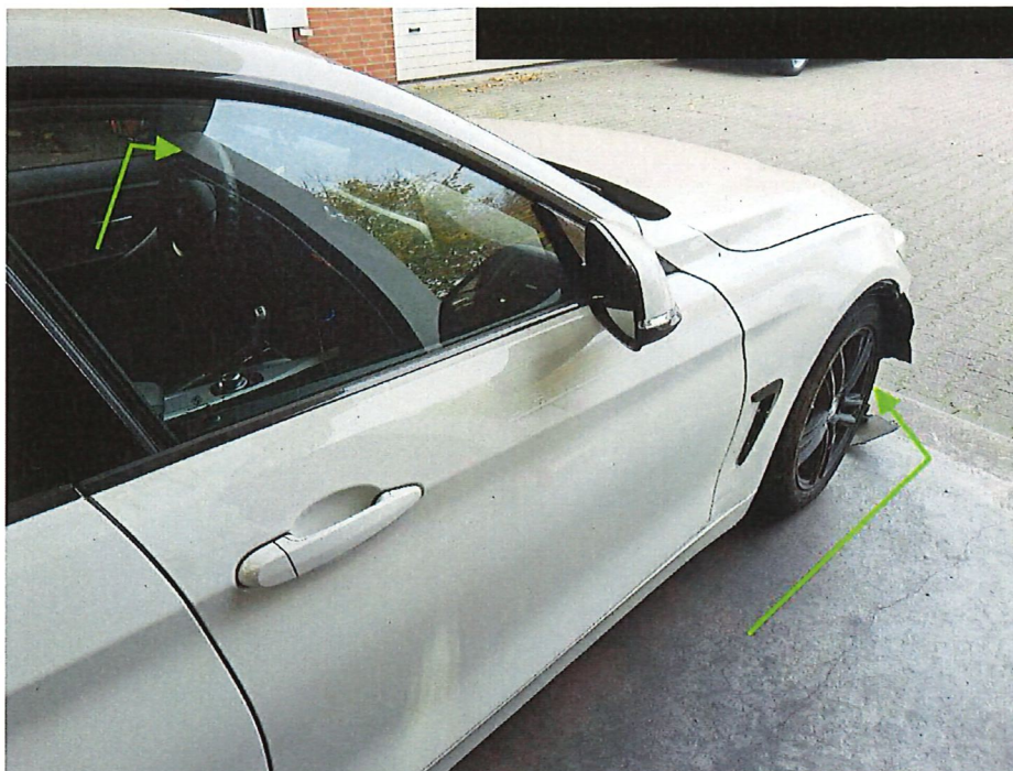
Bild 25 : Rad vorne rechts zeigt Schiefstellung
