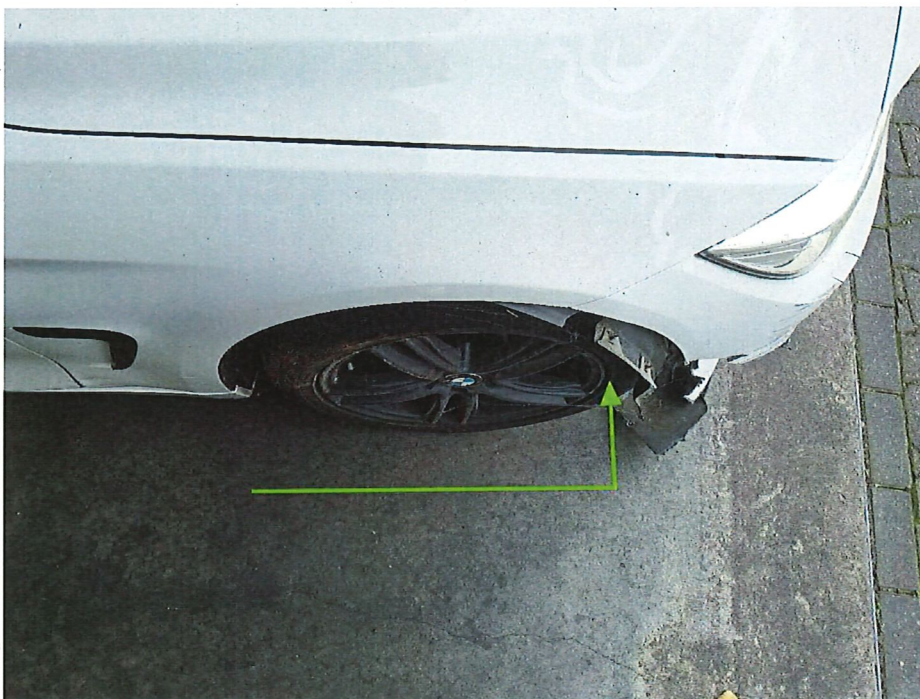
Bild 26 : Rad vorne rechts zeigt Schiefstellung
