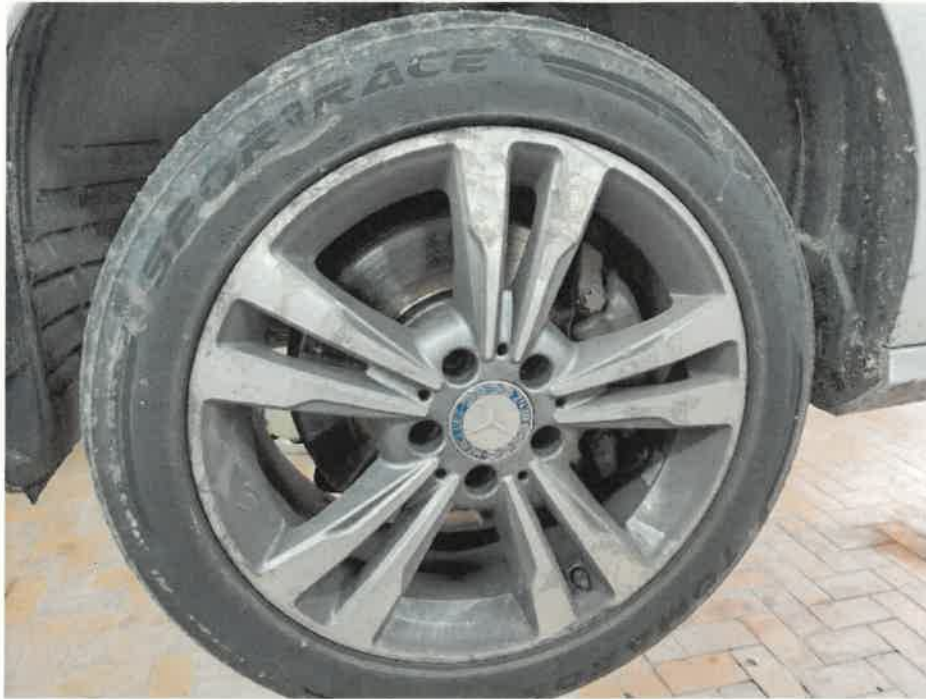
Bild 21 : Felge vorne links, korrodiert, smart repair
