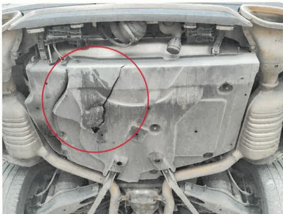
Bild 26 : Unterbodenverkleidung hinten gebrochen
