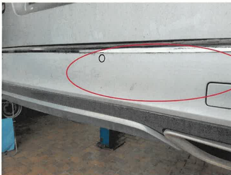
Bild 17 : Stoßfänger hinten Lackierung, zerkratzt, lackieren mit Lackaufbau
