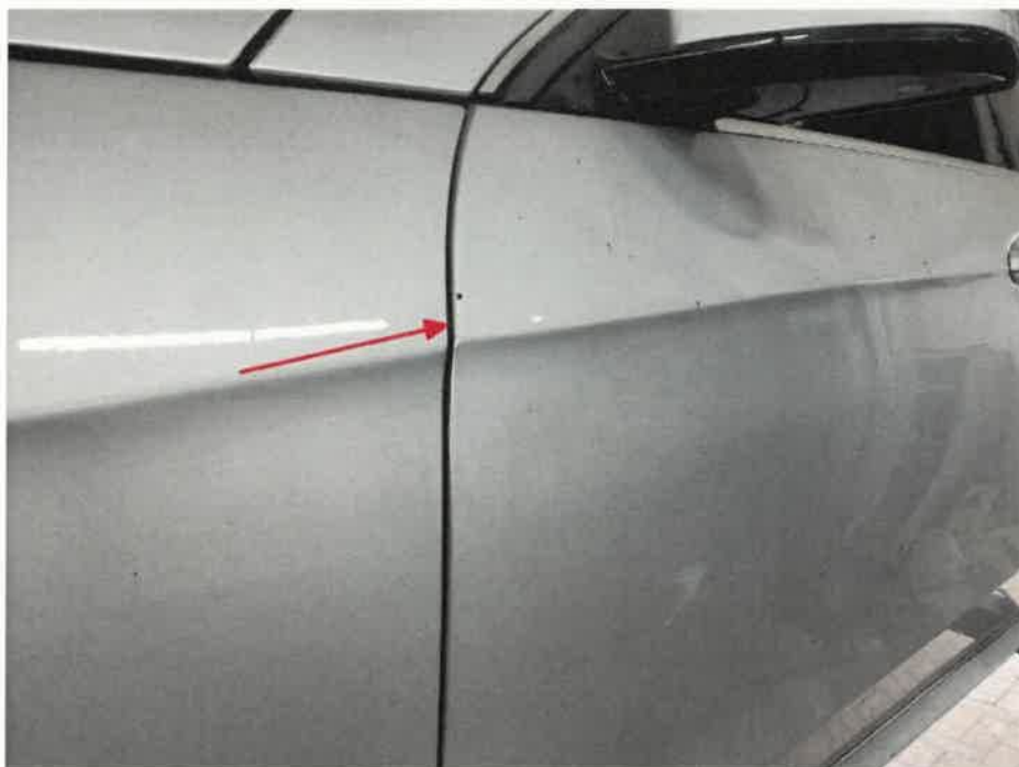
Bild 20 : Tür vorne links Türkante, Lackabplatzer
