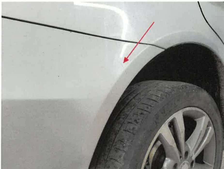
Bild 16 : Stoßfänger hinten Lackierung, zerkratzt, lackieren mit Lackaufbau
