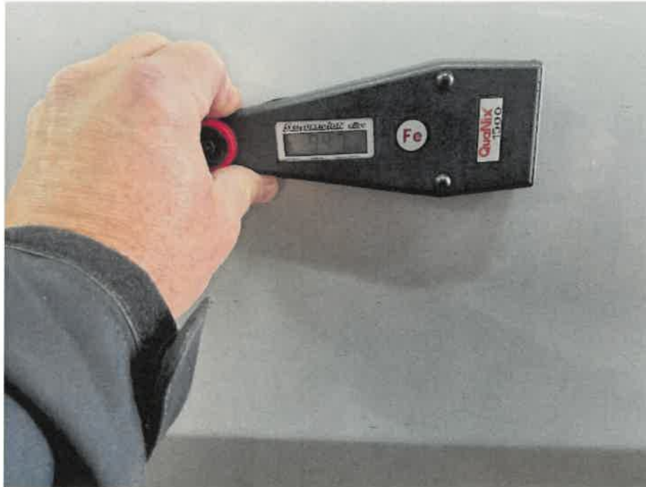
Bild 15 : gemessene Lackschichtdicke an der Tür vorne links (947 \mu )
