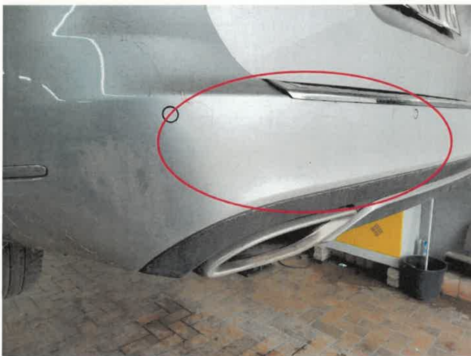
Bild 18 : Stoßfänger hinten Lackierung, zerkratzt, lackieren mit Lackaufbau
