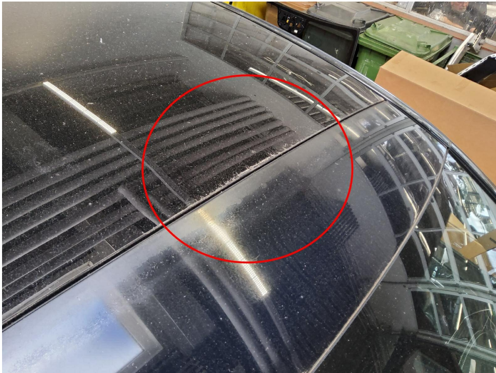
Bild 17 : Dach mit Lackfehler
