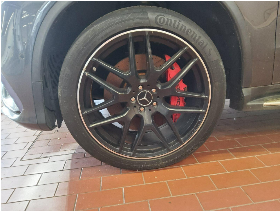
Bild 9 : Felge vorn links verkratzt
