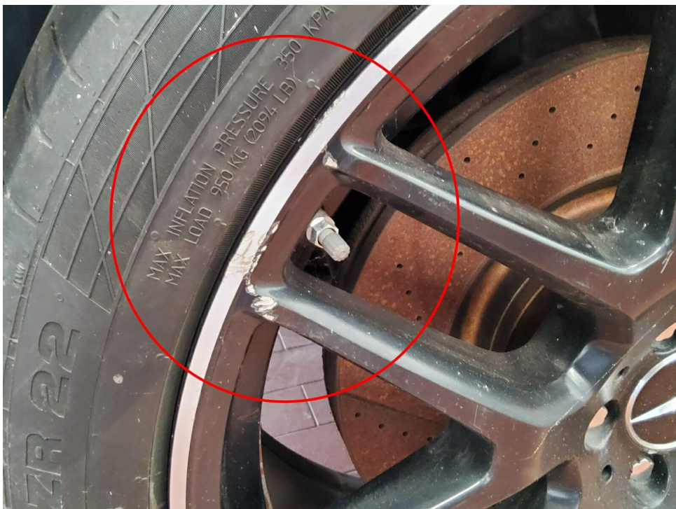
Bild 10 : Felge vorn links verkratzt
