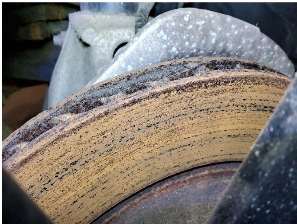
Bild 17 : Bresscheiben vorne und hinten korrodiert
