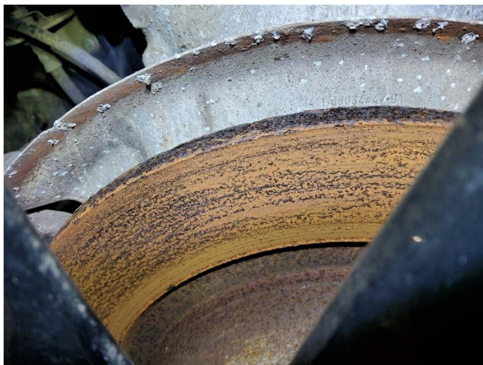
Bild 16 : Bresscheiben vorne und hinten korrodiert
