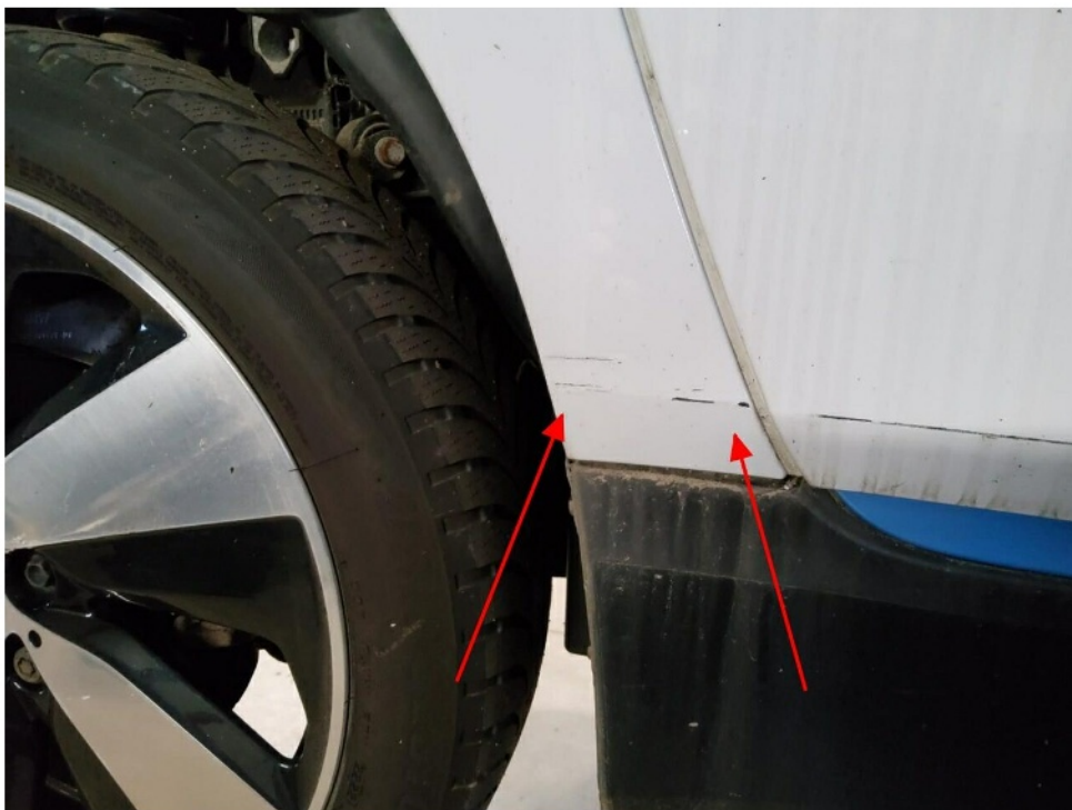
Bild 12 : Seitenteil hinten rechts Kniestück Lackierung, zerkratzt, lackieren mit Lackaufbau
