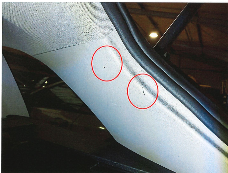
Bild 8 : Verkleidung D-Säule rechts innen verschrammt
