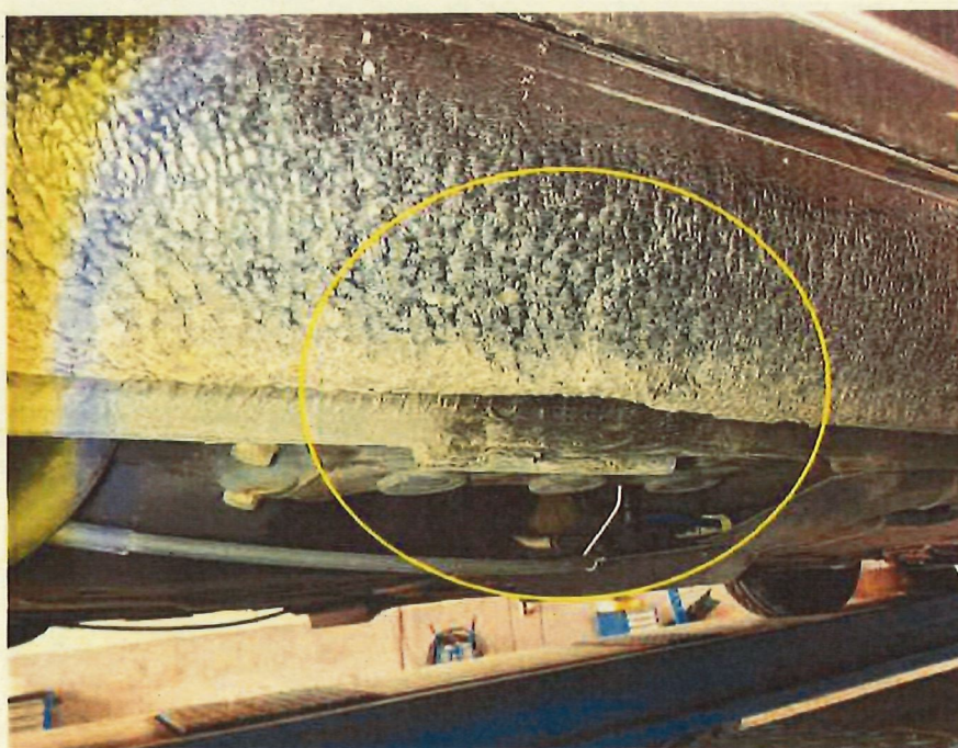
Bild 19 : Schweller rechts eingedrückt
