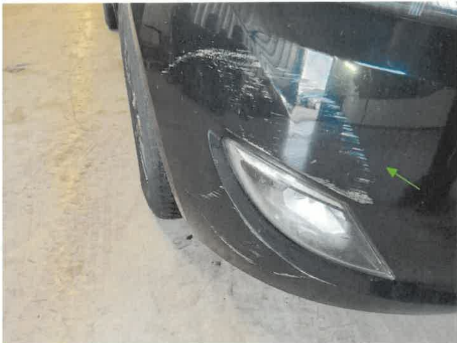
Bild 11 : Stoßfänger vorne Lackierung, verschrammt, smart repair
