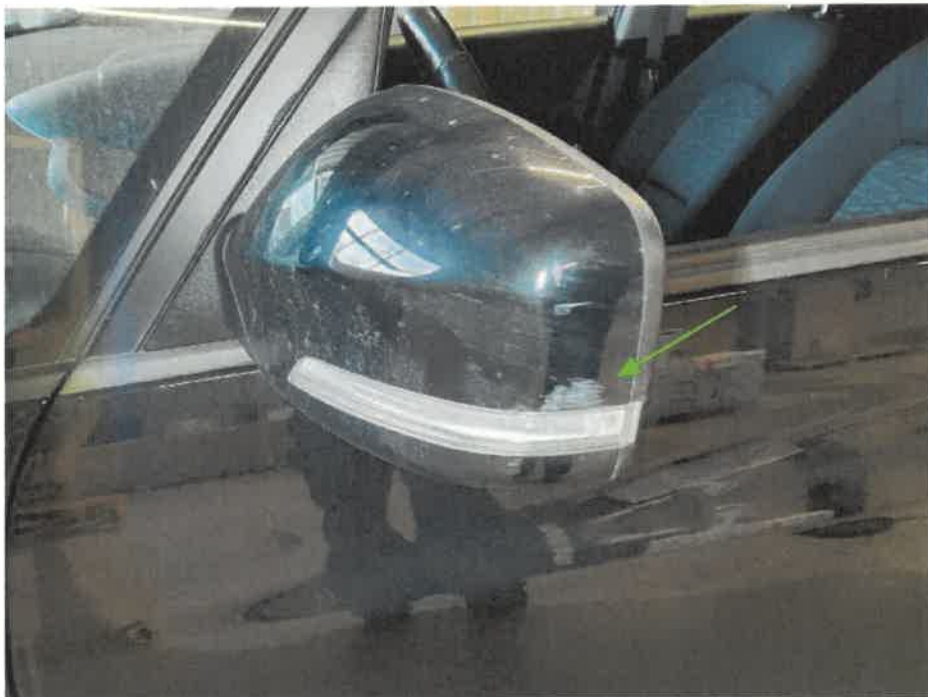
Bild 12 : Außenspiegel links Lackierung, zerkratzt, smart repair
