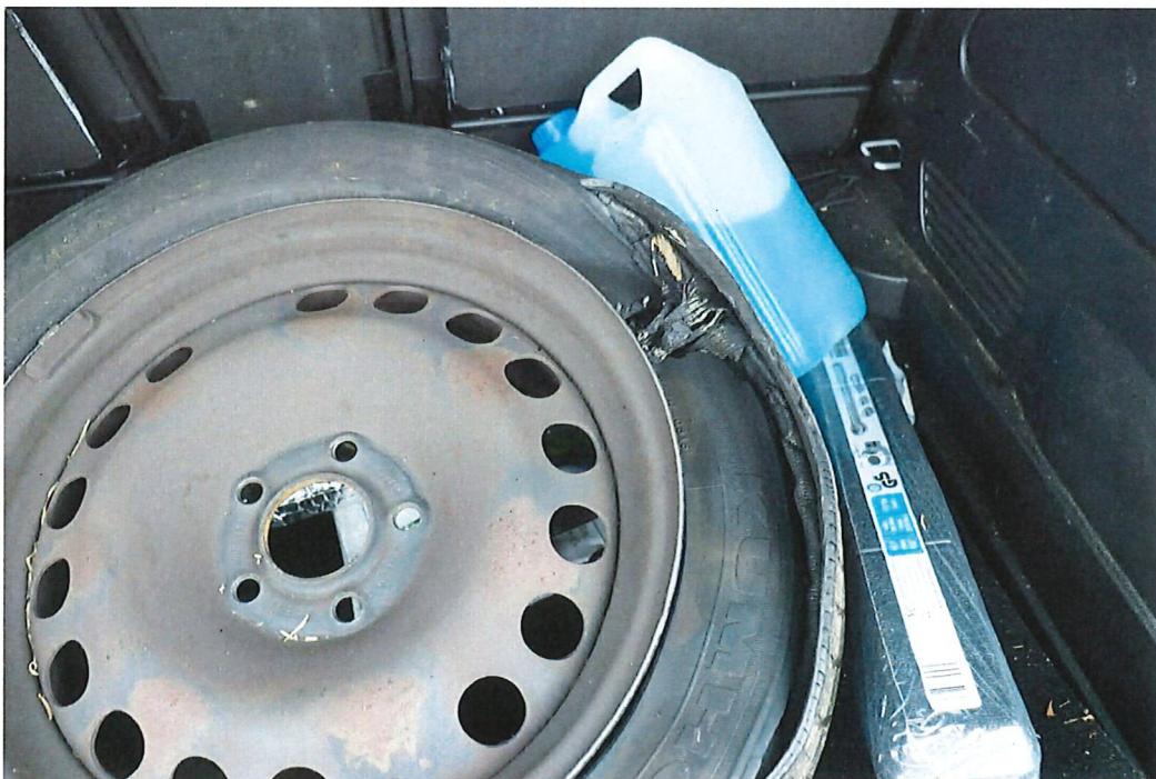
Bild 20 : Reifen vorne links geplatzt und demontiert
