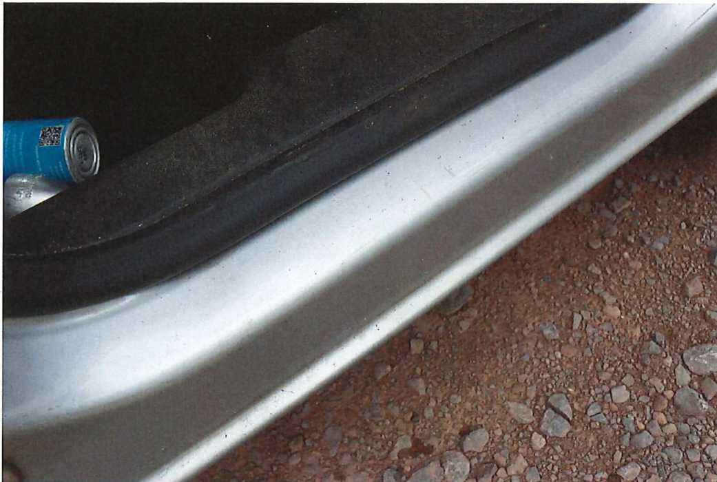
Bild 19 : Einstieg hinten links verkratzt und deformiert
