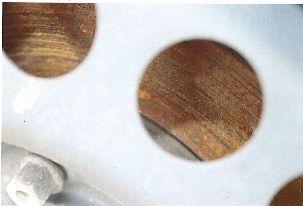
Bild 34 : Bremsscheiben an Vorder- und Hinterachse massive Standkorrosion
