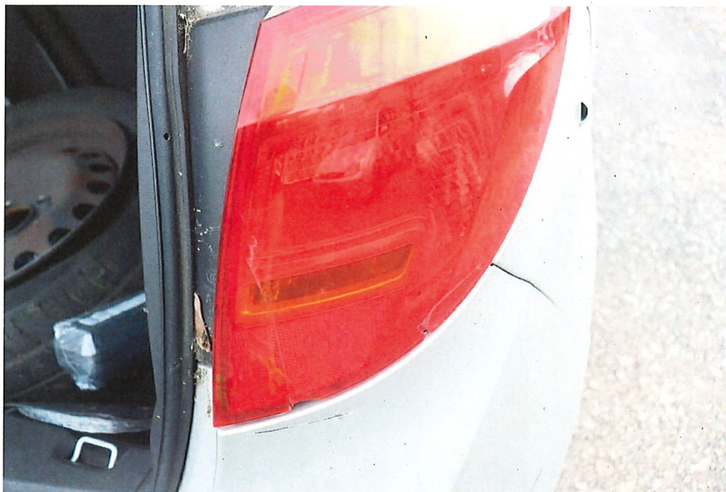
Bild 21 : Rückleuchte rechts gebrochen
