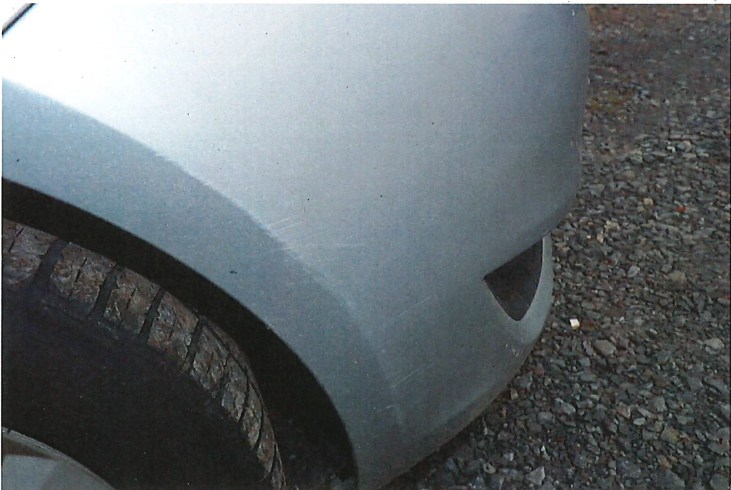
Bild 28 : Vordere Stoßfängerverkleidung verschrammt
