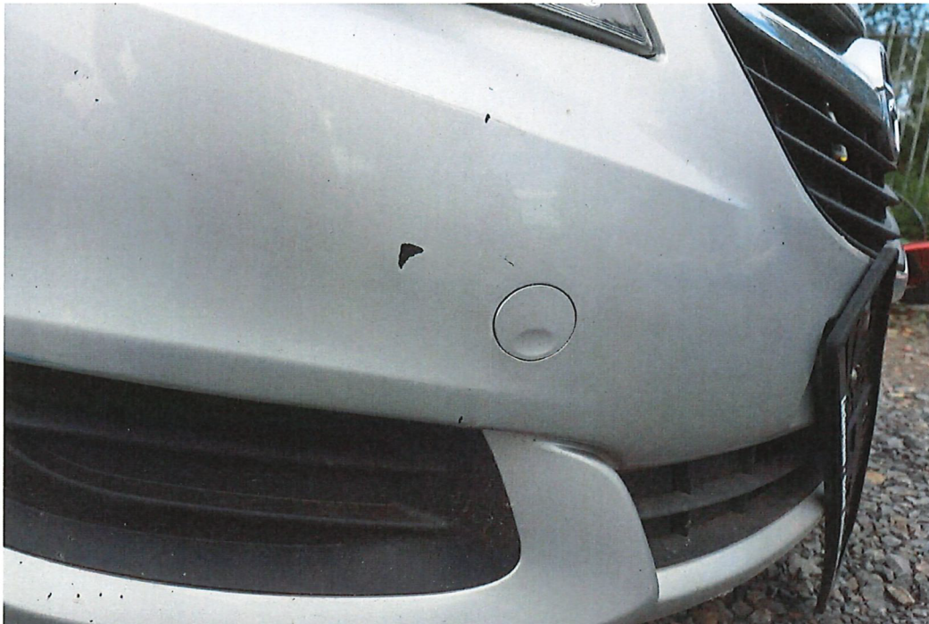
Bild 29 : Vordere Stoßfängerverkleidung verschrammt
