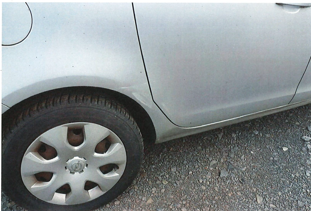
Bild 22 : Streifschaden rechte Fahrzeugseite (Seitenwand und Türen verschrammt und deformiert)
