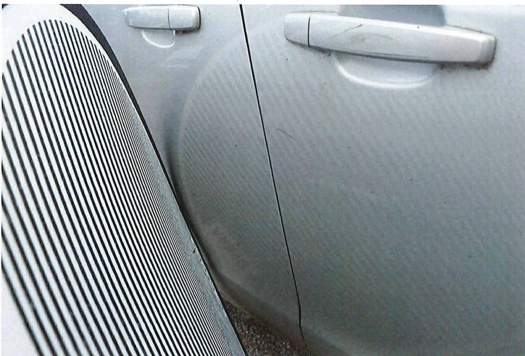
Bild 26 : Streifschaden rechte Fahrzeugseite (Seitenwand und Türen verschrammt und deformiert)
