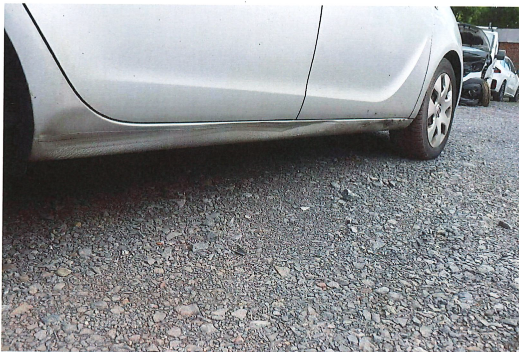
Bild 35 : Schweller rechts auf ganzer Bauteillänge eingedrückt
