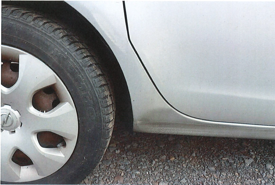
Bild 23 : Streifschaden rechte Fahrzeugseite (Seitenwand und Türen verschrammt und deformiert)
