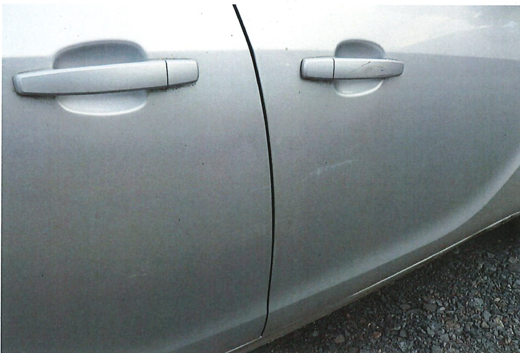
Bild 24 : Streifschaden rechte Fahrzeugseite (Seitenwand und Türen verschrammt und deformiert)
