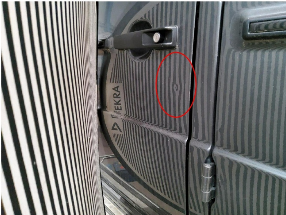
Bild 12 : Tür vorne links, eingedellt, drücken
