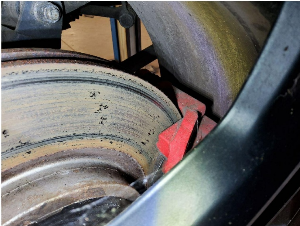
Bild 17 : Bremsen stark korrodiert
