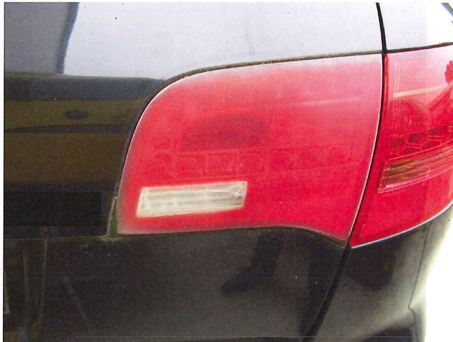
Bild 19 : Rückleuchte hinten rechts innen verwittert
