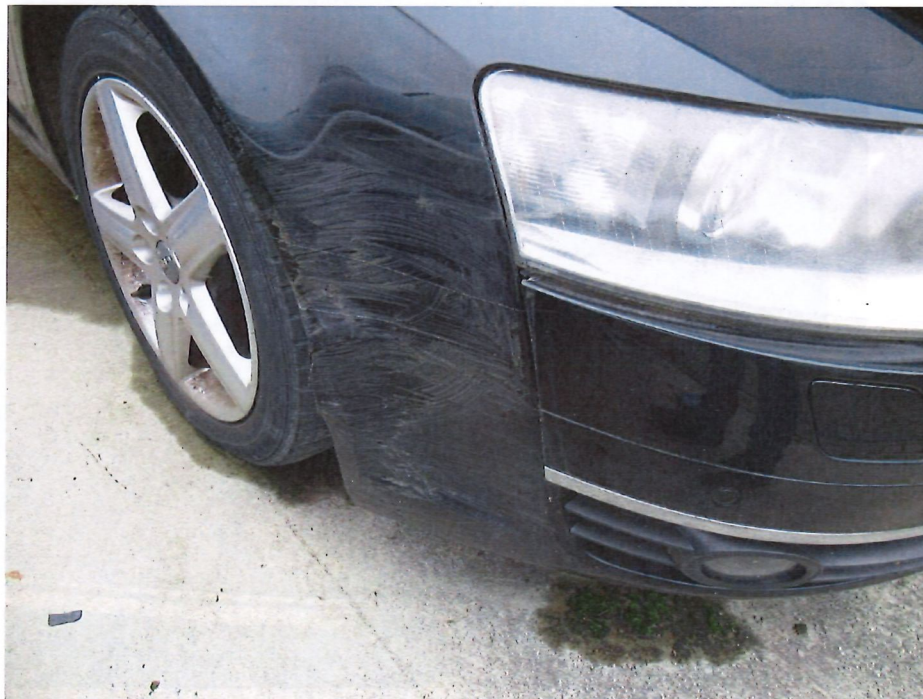
Bild 11 : Stoßfänger vorne verschrammt und verformt
