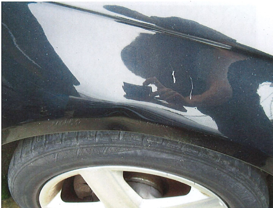
Bild 13 : Kotflügel rechts eingedrückt
