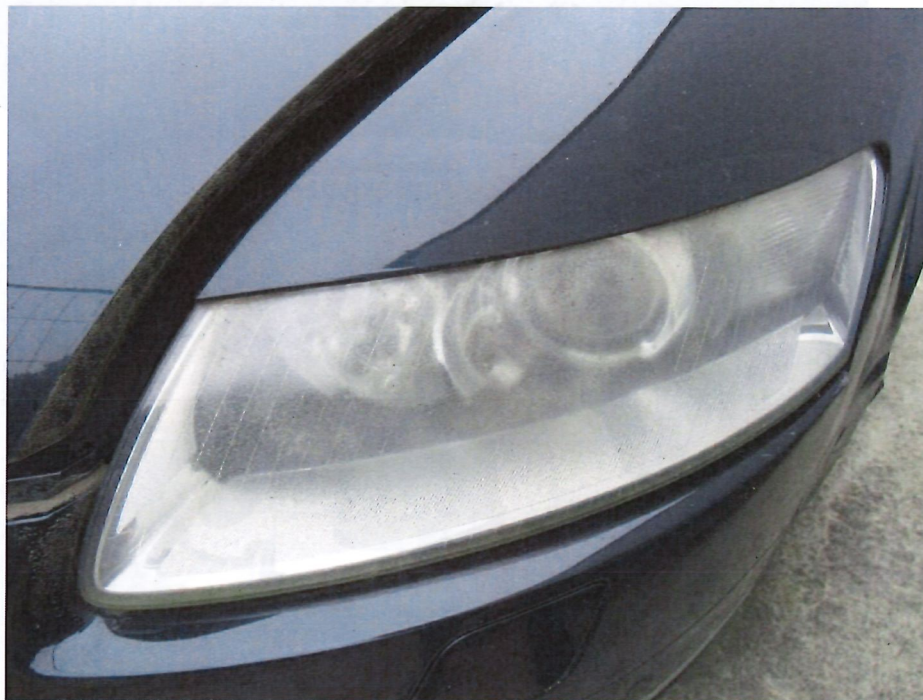
Bild 7 : Scheinwerfer links verwittert
