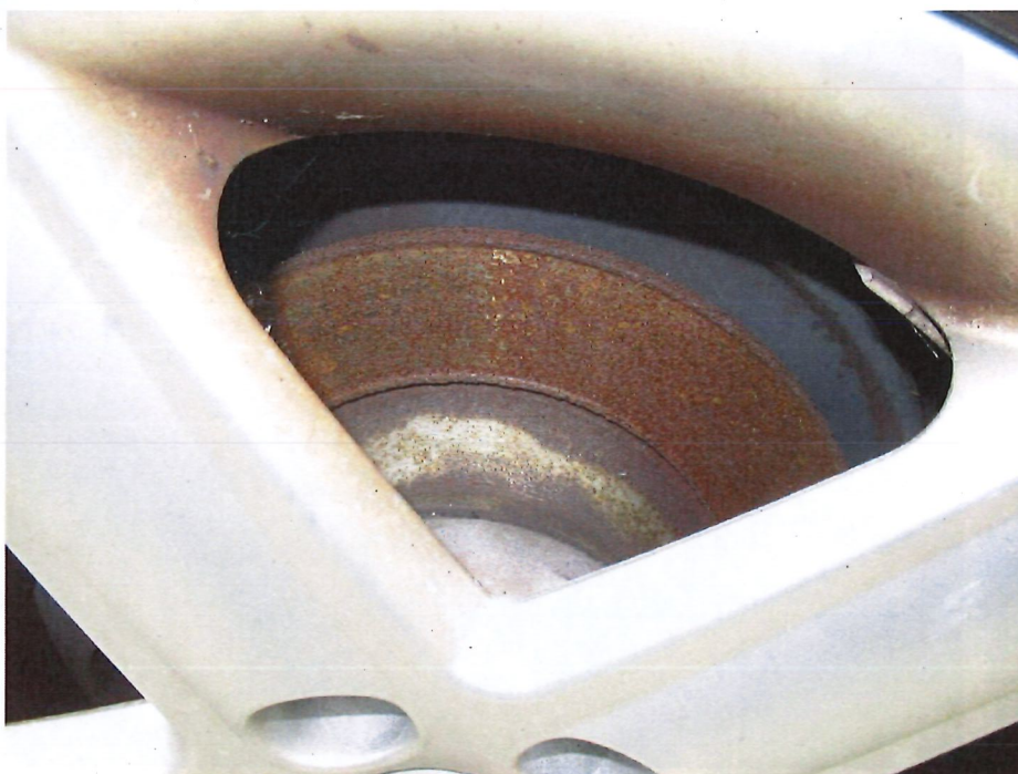
Bild 16 : Bremsscheiben Hinterachse korrodiert
