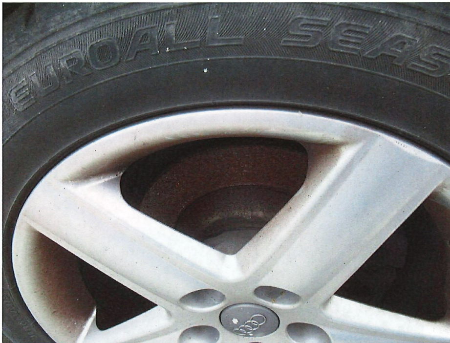
Bild 17 : Brems Scheiben vorne korrodiert
