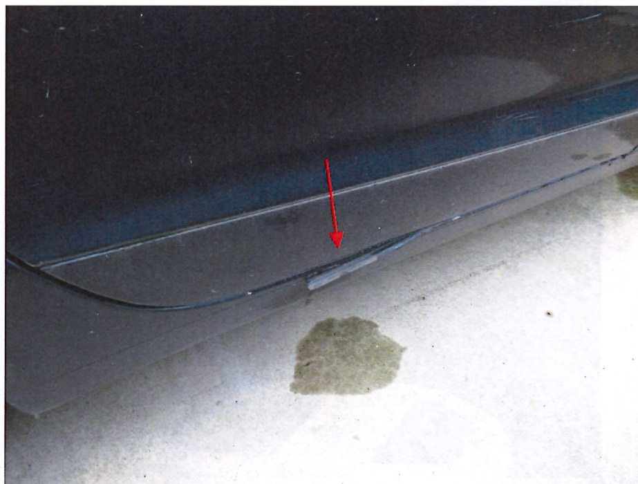
Bild 15 : Türdichtung hinten rechts lose
