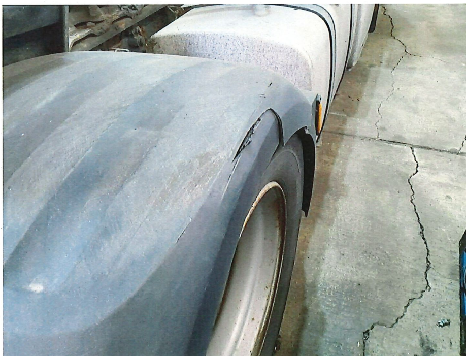
Bild 13 : Kotflügel hinten rechts gebrochen
