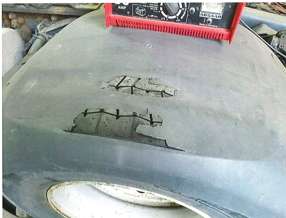
Bild 11 : Kotflügel hinten links durchgeschliffen
