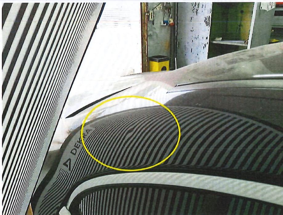
Bild 8 : Dachrahmen links deformiert
