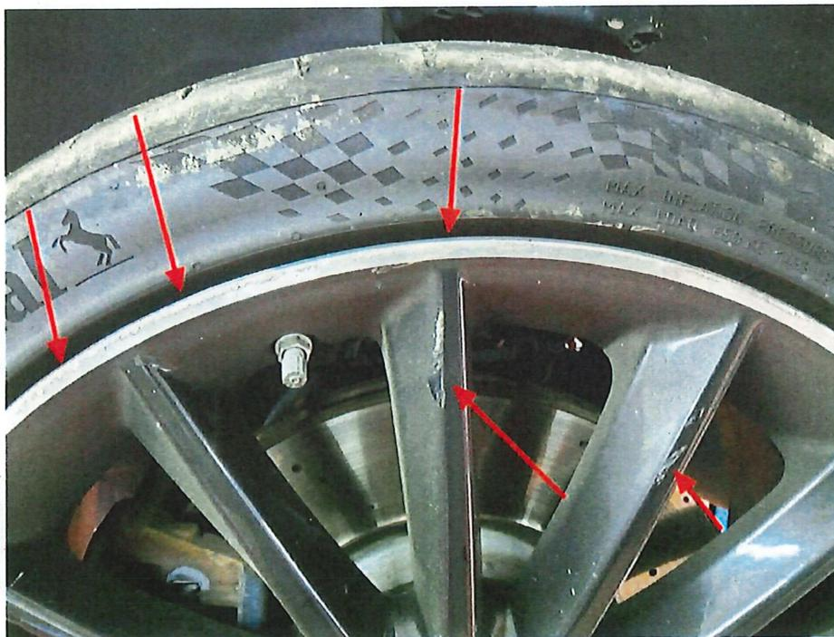
Bild 26 : Felge vorne links zerkratzt
