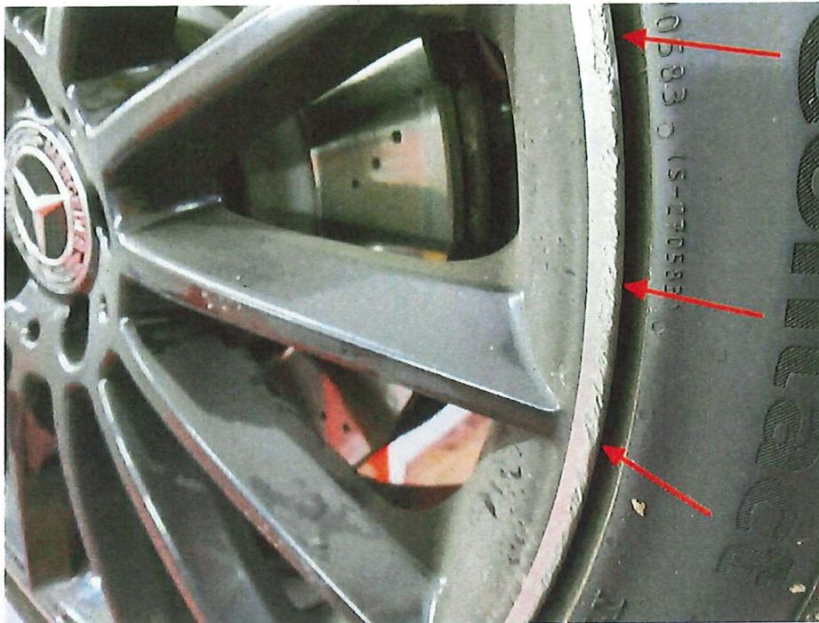
Bild 25 : Felge vorne links zerkratzt
