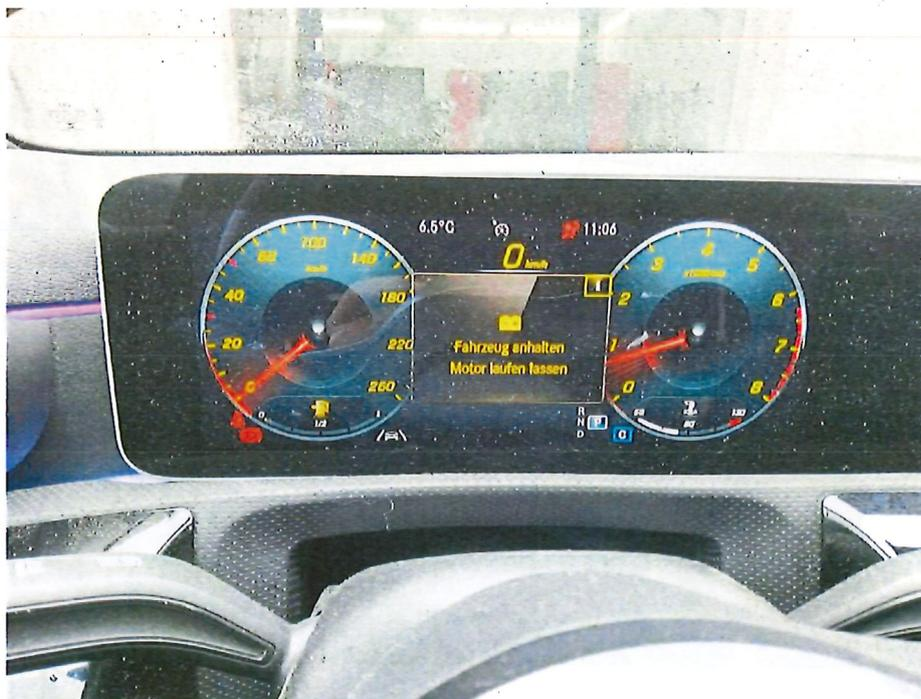
Bild 16 : Batterie defekt
