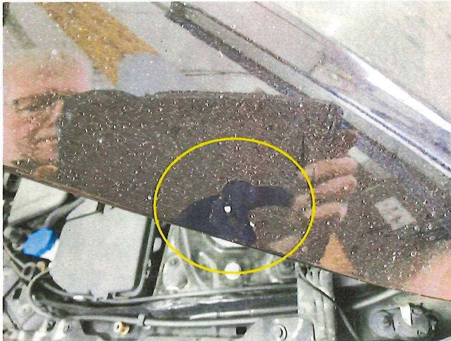
Bild 11 : Motorhaube Lackierung zahlreiche Steinschläge
