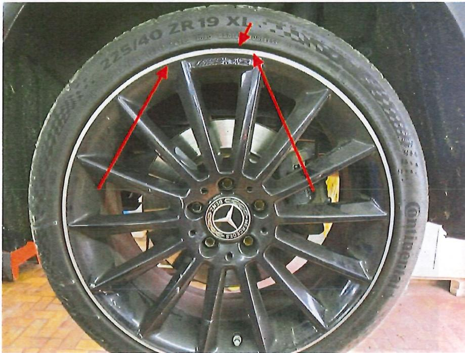
Bild 23 : Felge hinten links zerkratzt
