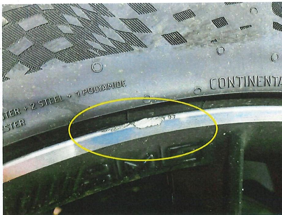
Bild 18 : Felge vorne rechts zerkratzt
