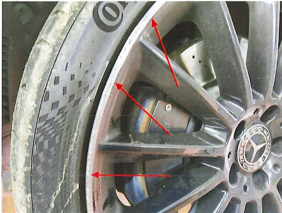
Bild 27 : Felge vorne links zerkratzt
