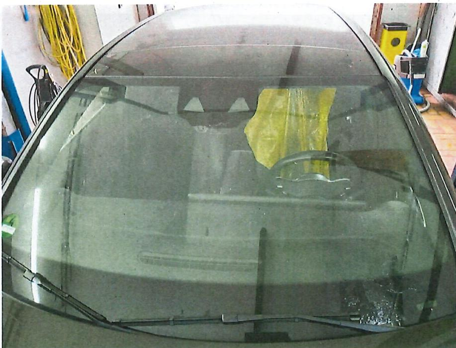
Bild 10 : Frontscheibe zahlreiche Steinschläge, Gebrauchsspur
