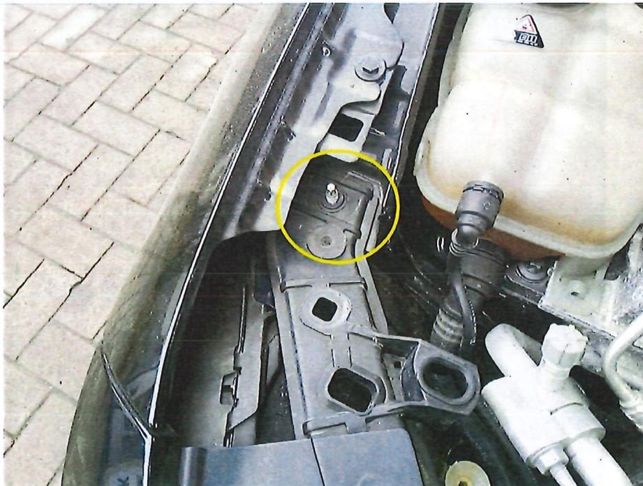
Bild 28 : Schlossträger rechts lose
