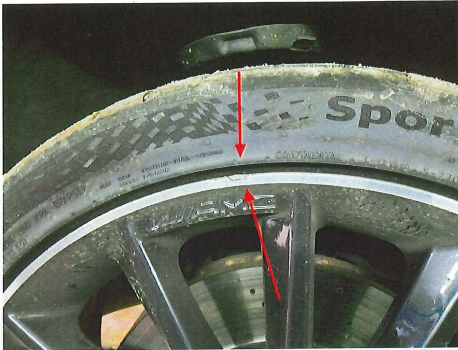
Bild 17 : Felge vorne rechts zerkratzt
