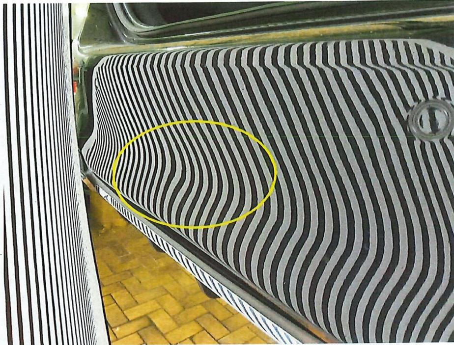
Bild 5 : Stoßfänger hinten deformiert
