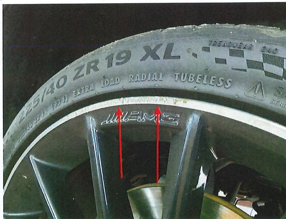
Bild 22 : Felge hinten links zerkratzt
