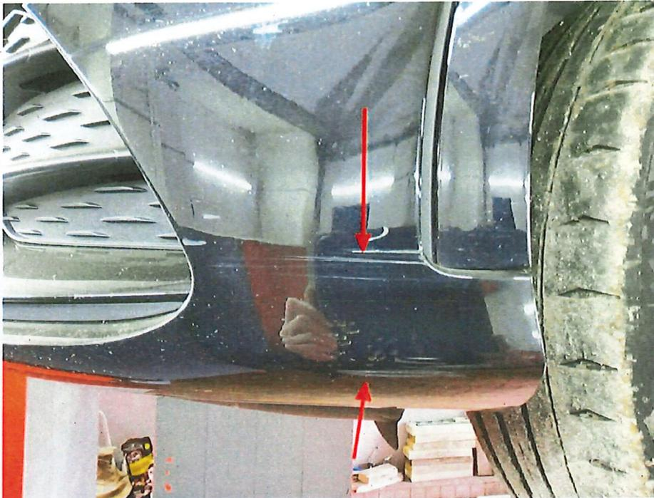
Bild 9 : Stoßfänger vorne Lackierung zerkratzt
