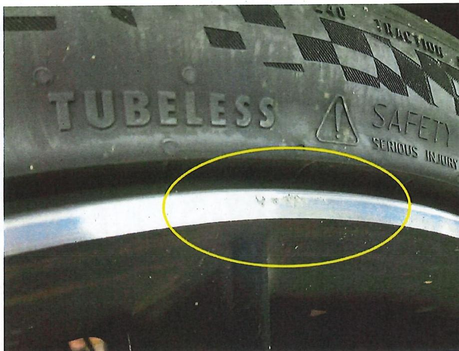
Bild 21 : Felge hinten rechts zerkratzt
