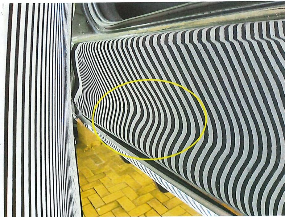
Bild 6 : Stoßfänger hinten deformiert
