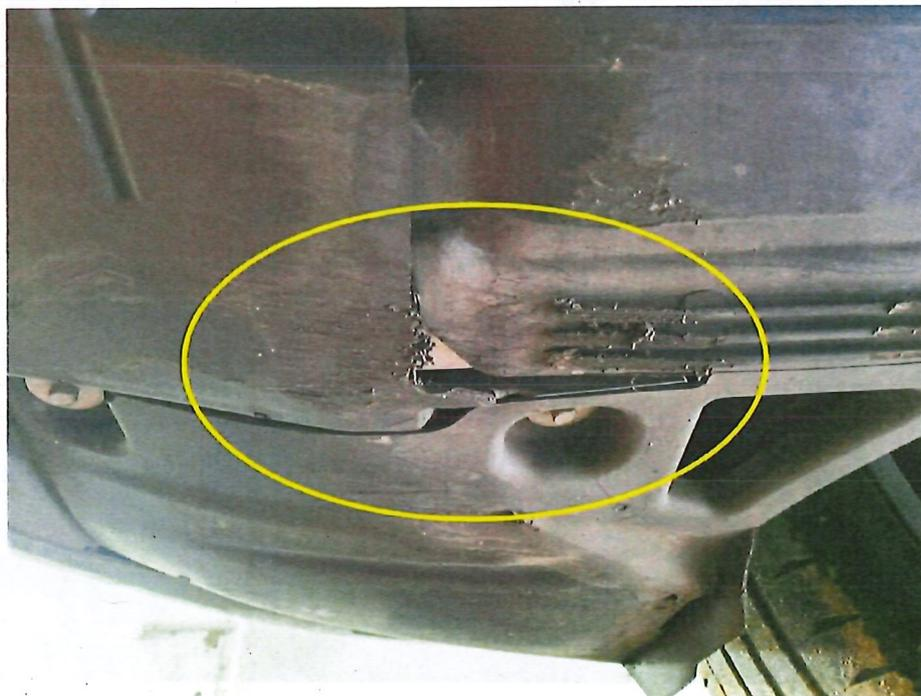
Bild 12 : Unterbodenverkleidung gebrochen
