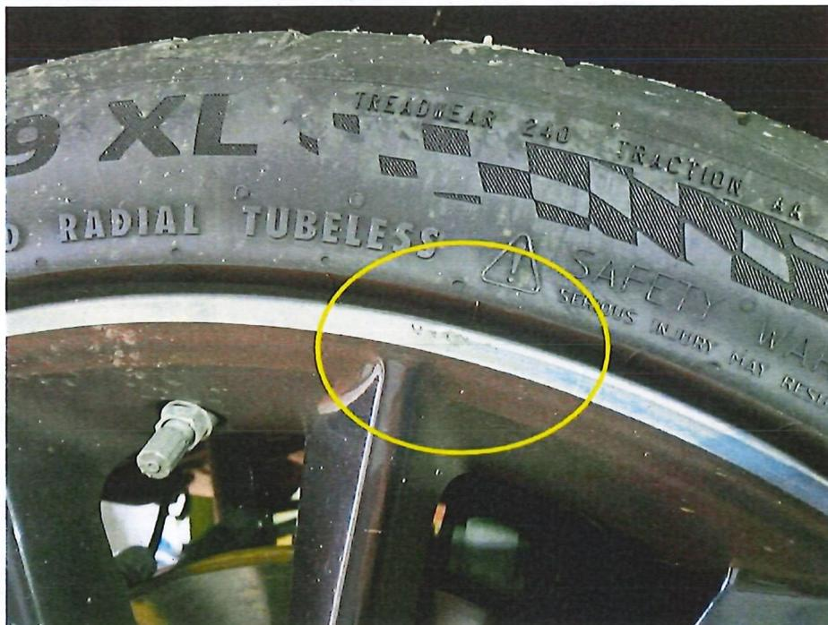
Bild 20 : - Felge hinten rechts zerkratzt
