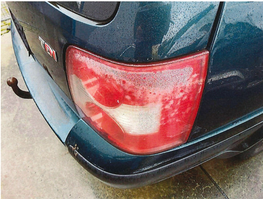
Bild 10 : Schlussleuchte mit Feuchtigkeitseintritt
