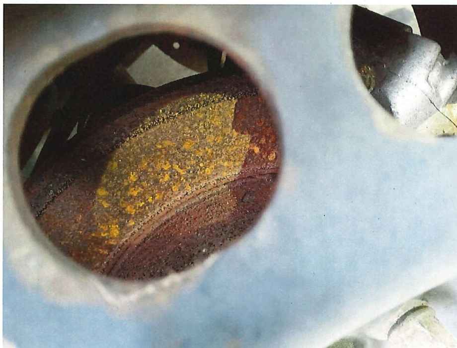
Bild 12 : Bremsscheiben massiv verrostet
