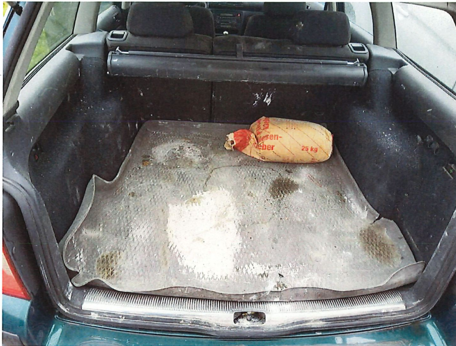
Bild 15 : Innenraum mit Feuchtigkeitseintritt / verunreinigt
