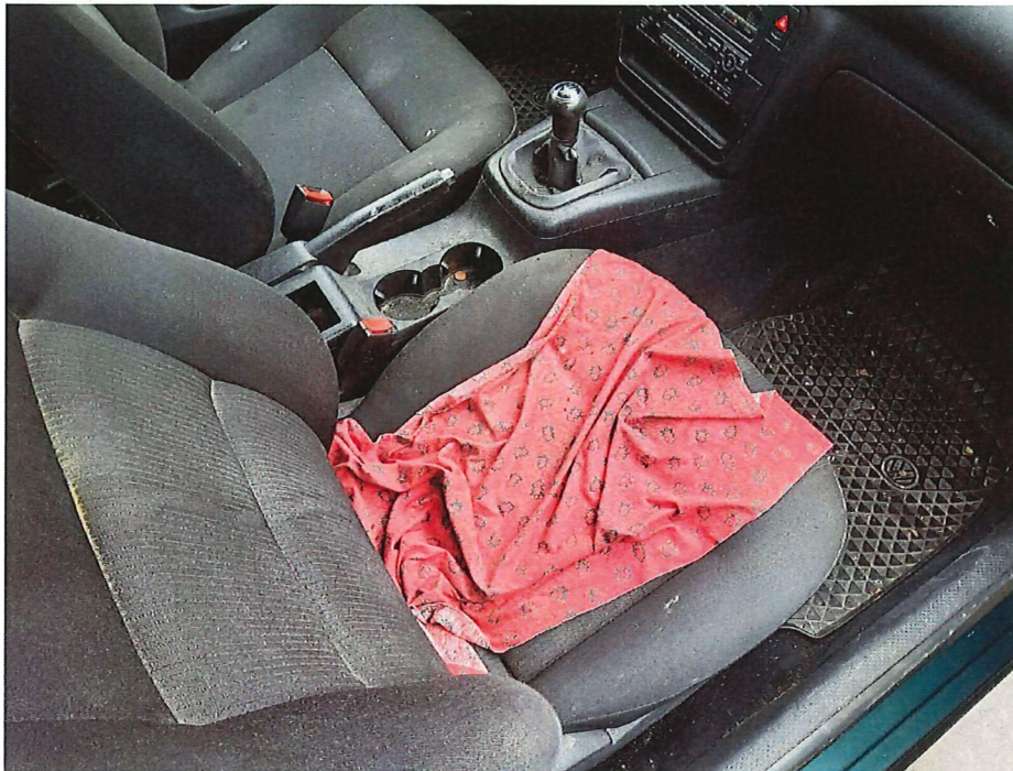
Bild 13 : Innenraum mit Feuchtigkeitseintritt / verunreinigt
