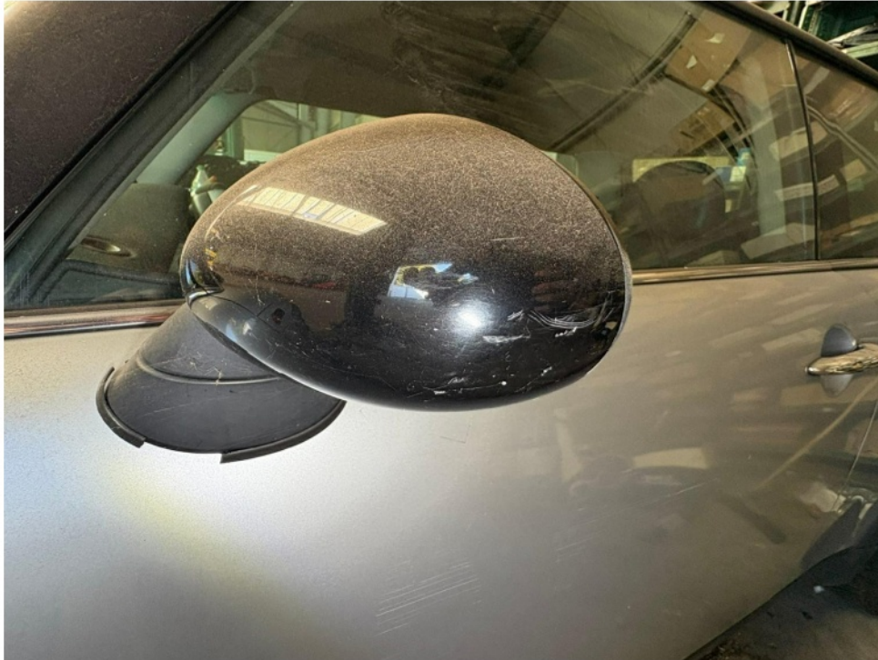
Bild 15 : Außenspiegelgehäuse links verschrammt
