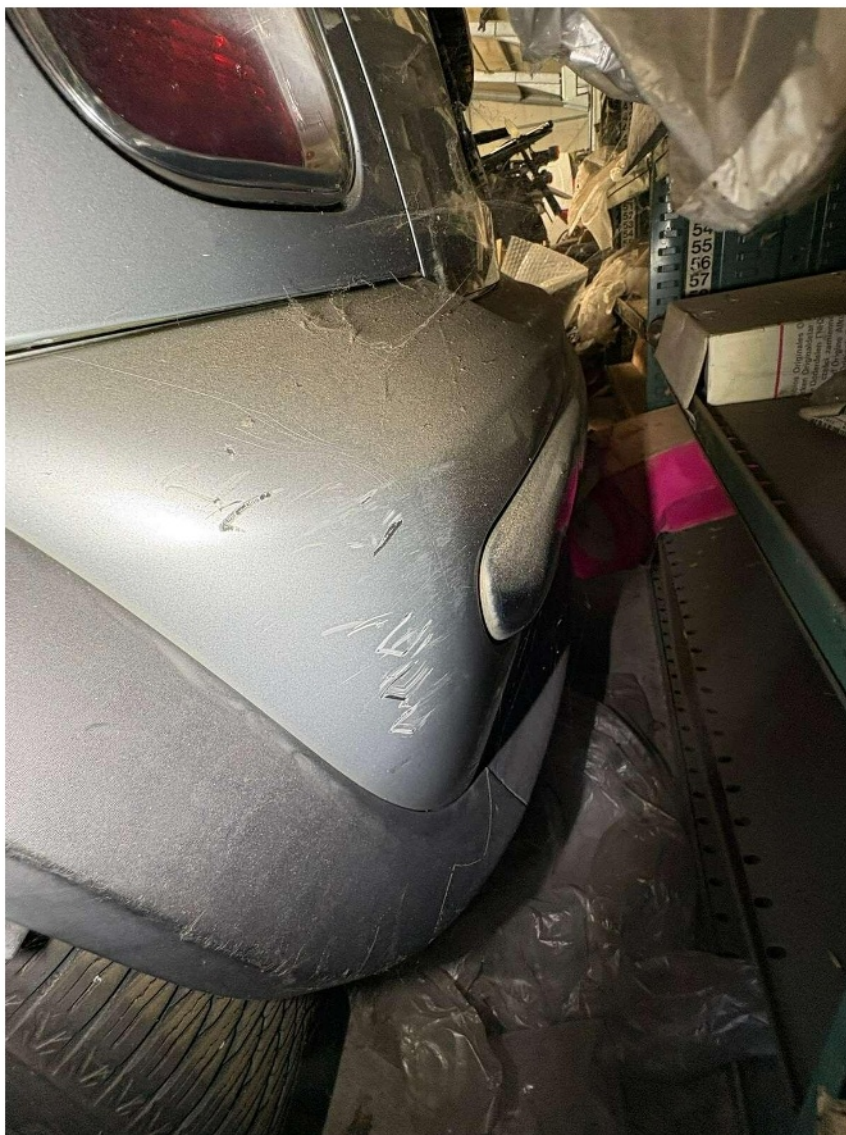
Bild 14 : Stoßfänger hinten verschrammt
