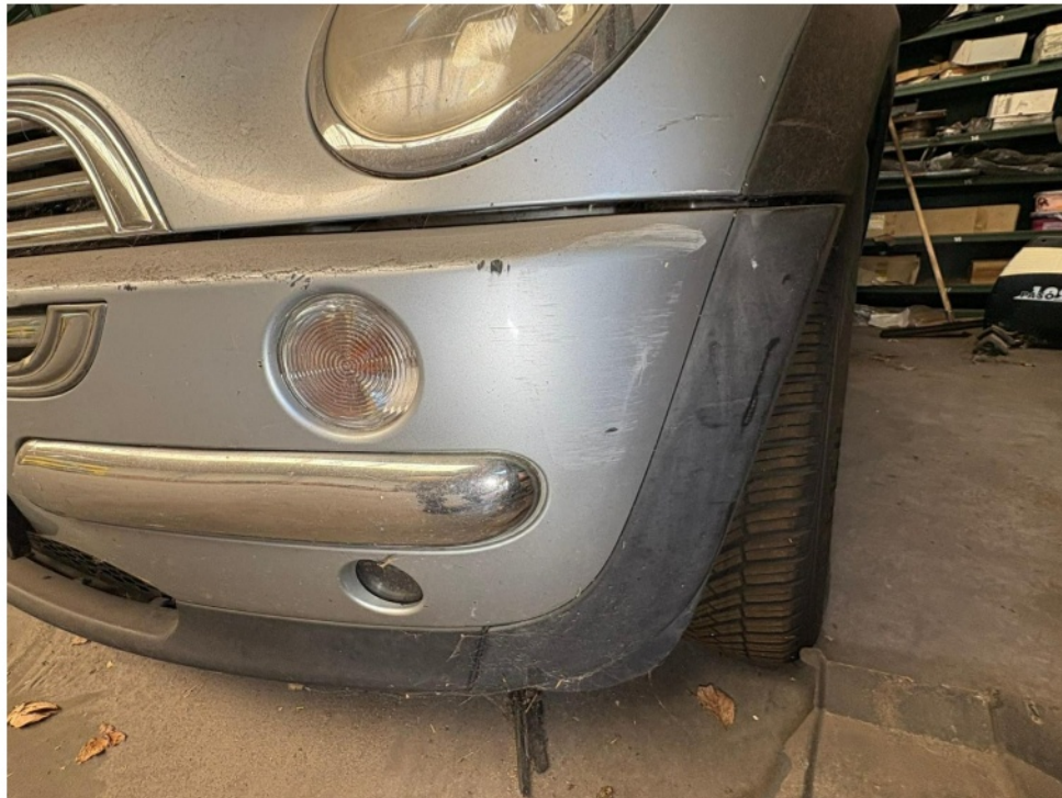
Bild 9 : Stoßfänger vorne links verschrammt
