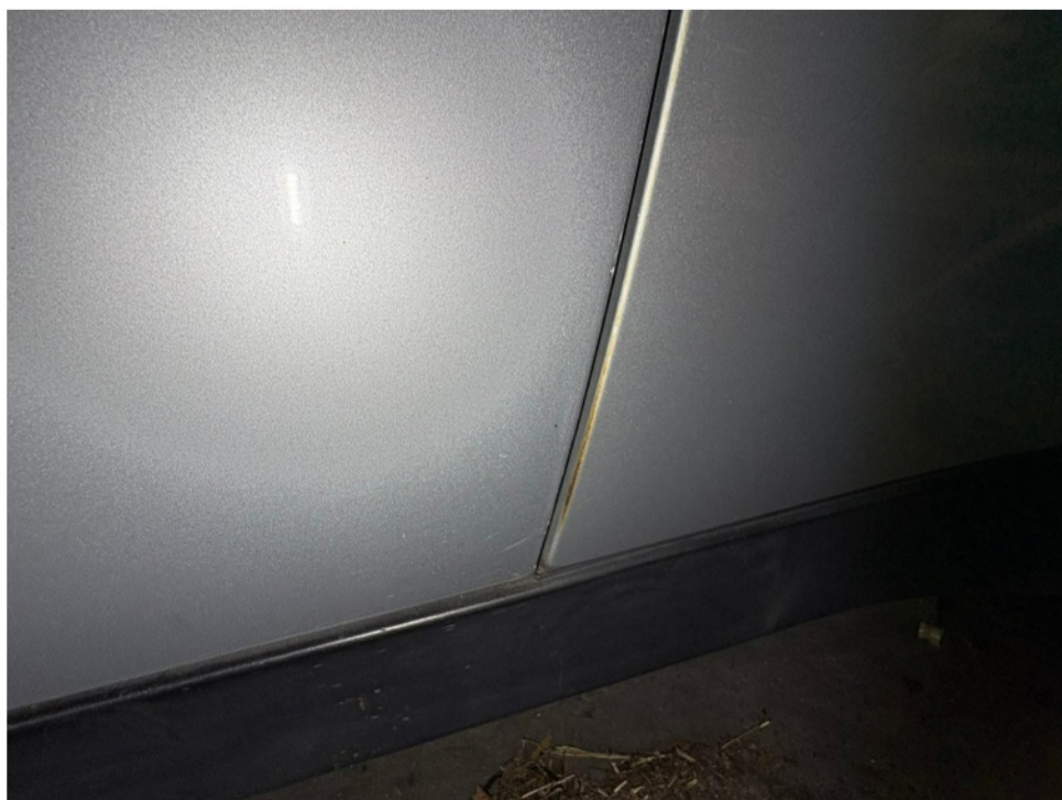
Bild 12 : Seitenteil hinten links korrodiert
