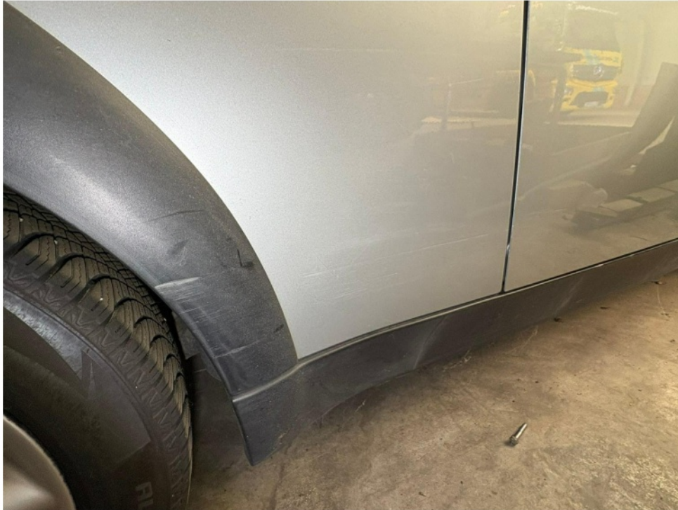
Bild 7 : Seitenteil hinten rechts verschrammt Radlauf hinten rechts verschrammt
