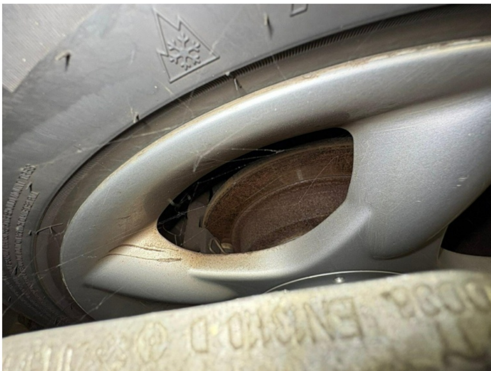
Bild 8 : Bremsscheiben 1. und 2. Achse korrodiert
