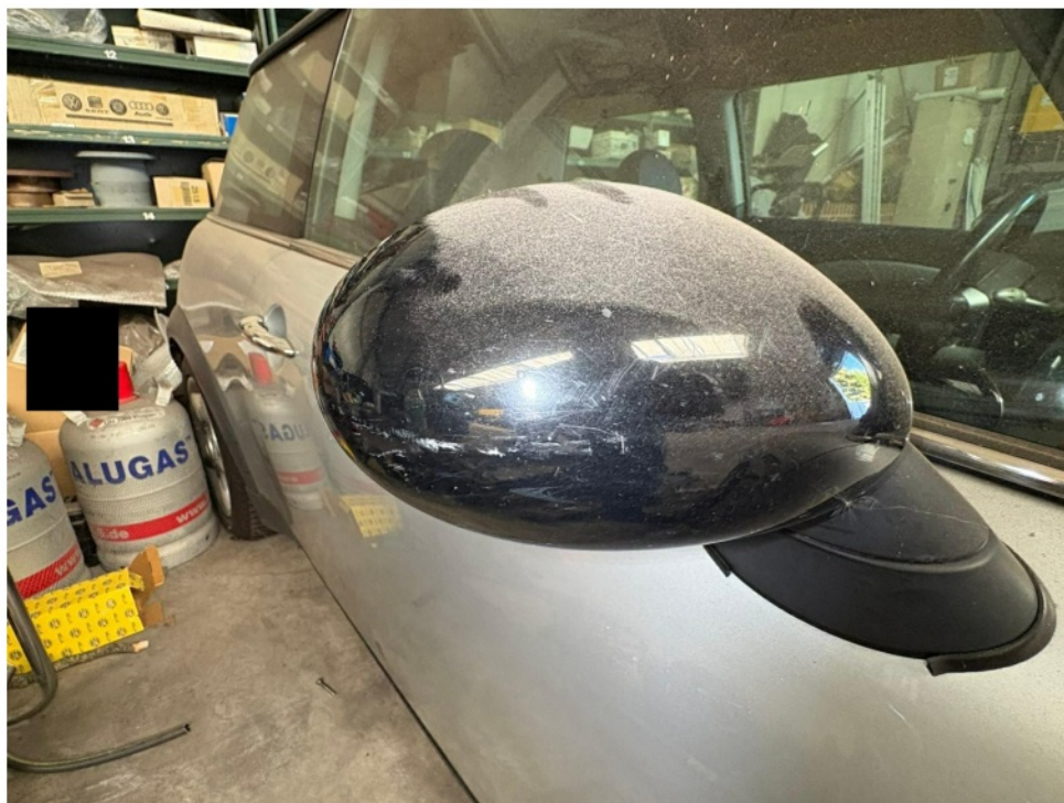
Bild 11 : Außenspiegelgehäuse rechts verschrammt
