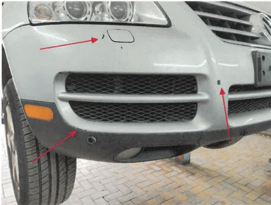
Bild 13 : Stoßfänger vorne Lackierung zerkratzt, lackieren mit Lackaufbau
