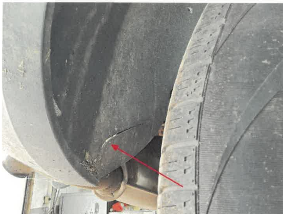
Bild 17 : Radhausverkleidung hinten rechts gebrochen
