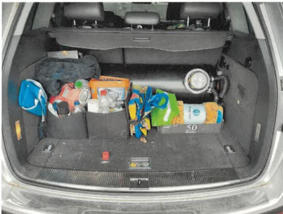
Bild 7 : Übersicht Laderaum mit Gastank
