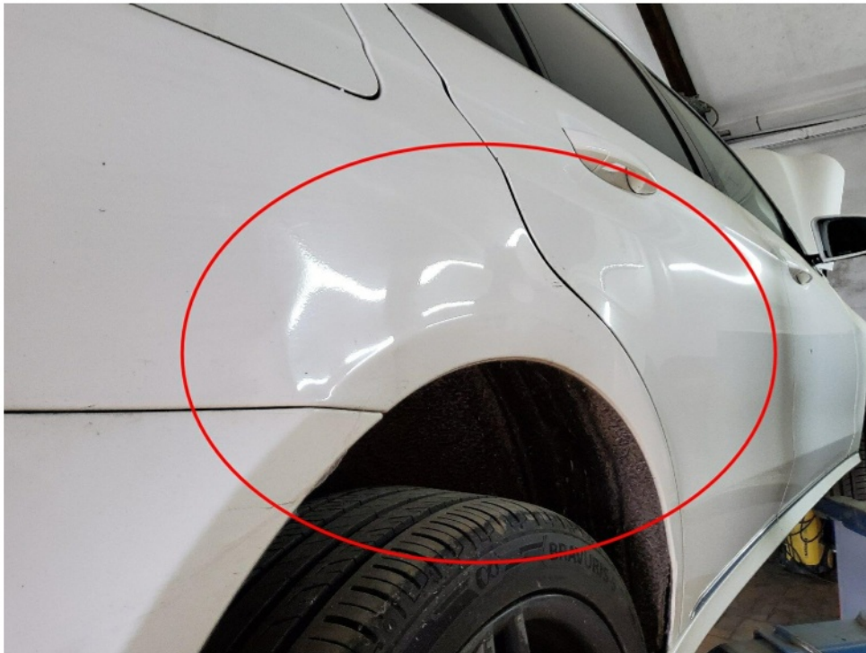
Bild 19 : Seitenwand rechts eingedrückt
