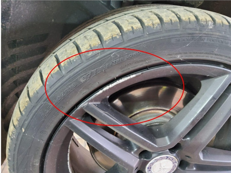
Bild 27 : Felge vorn links verkratzt
