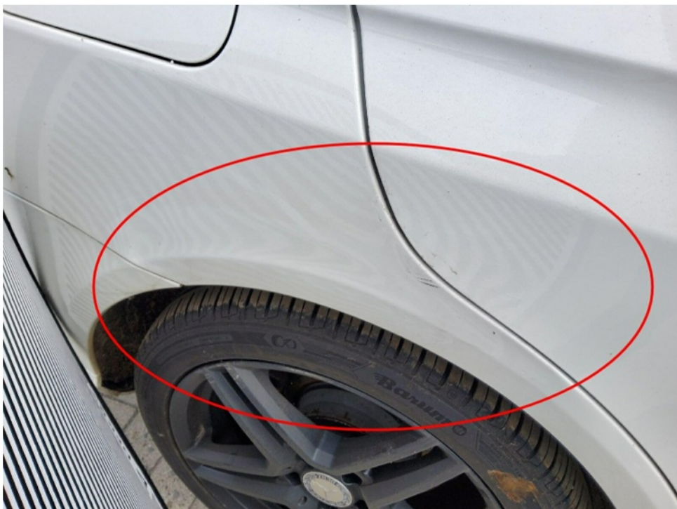
Bild 20 : Seitenwand rechts eingedrückt
