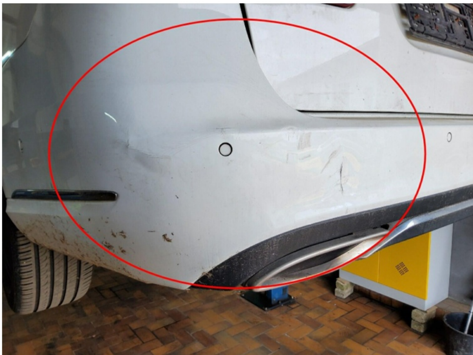
Bild 16 : Stoßfänger hinten gebrochen
