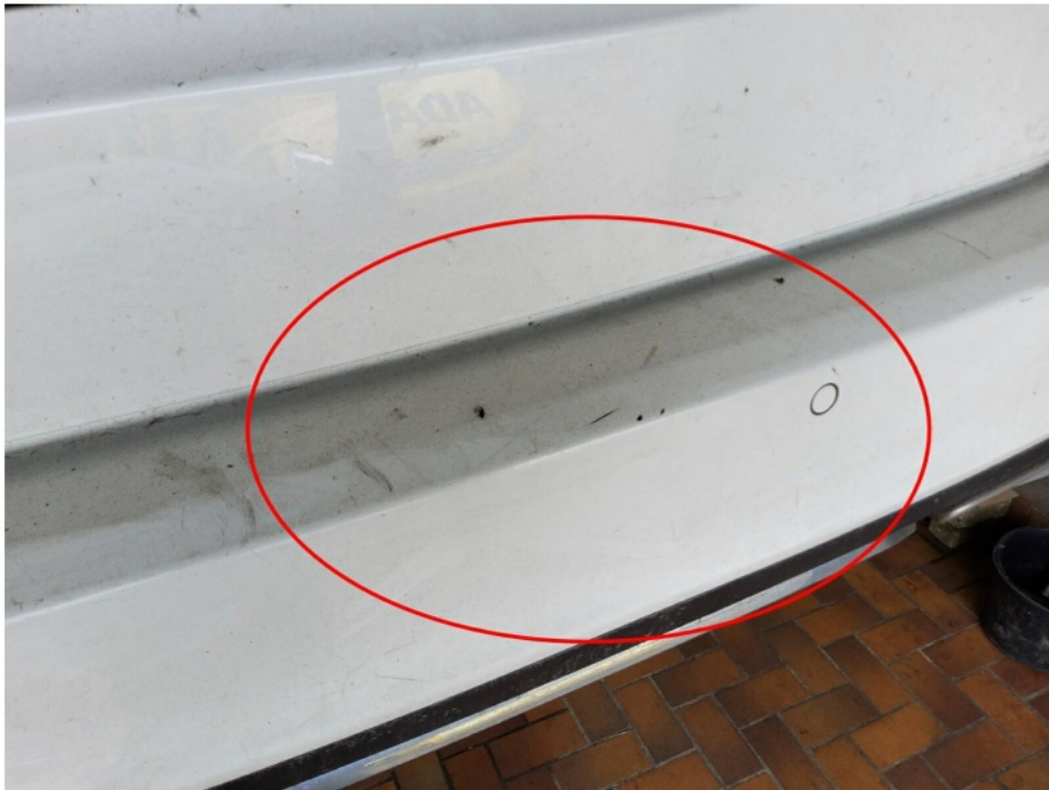
Bild 17 : Stoßfänger hinten verkratzt
