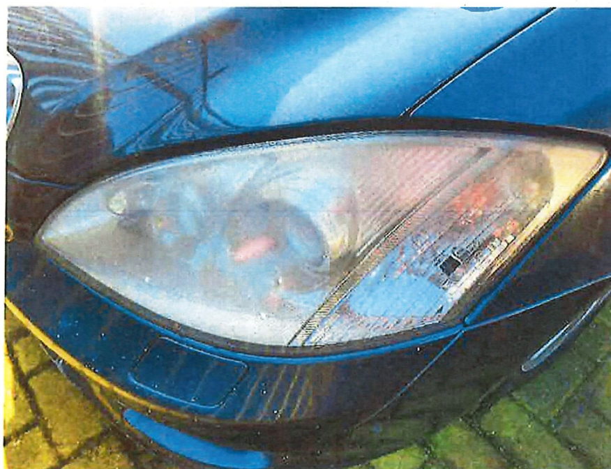
Bild 12 : Frontscheinwerfer links und rechts matt
