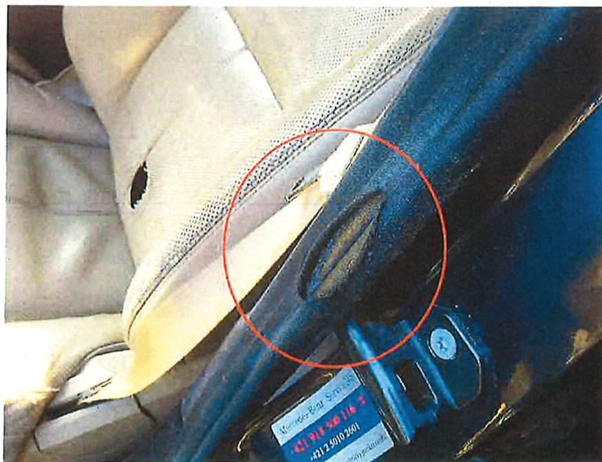
Bild 8 : Türdichtung vorne links gerissen
