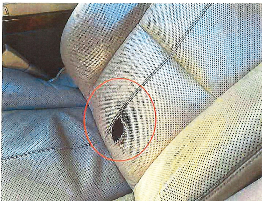
Bild 7 : Lehnenbezug vorne links gerissen
