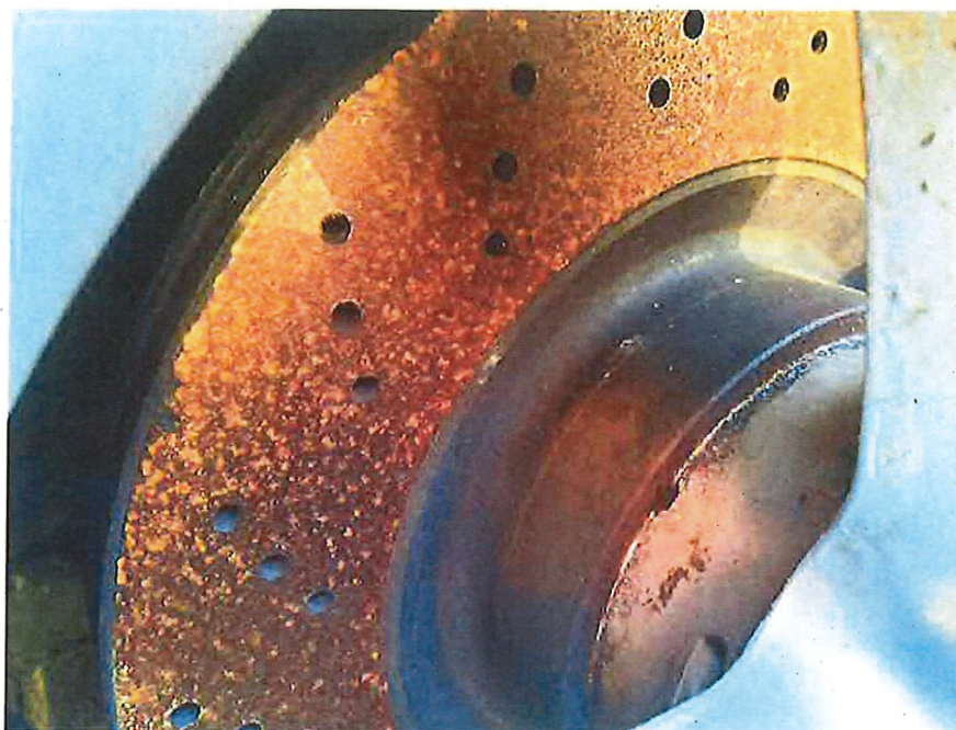
Bild 11 : Bremsscheiben Vorderachse Korrosion
