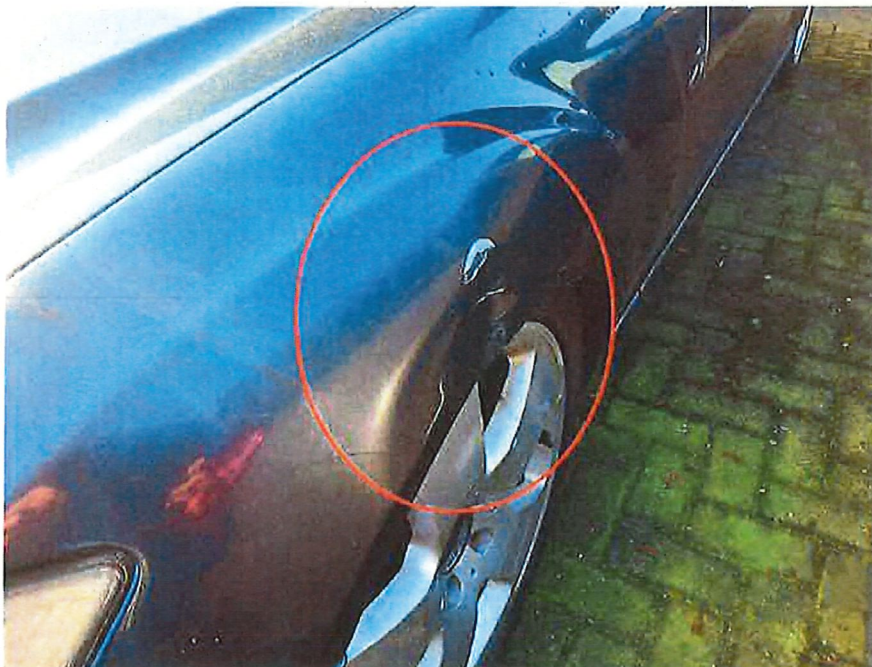
Bild 10 : Kotflügel vorne links verformt
