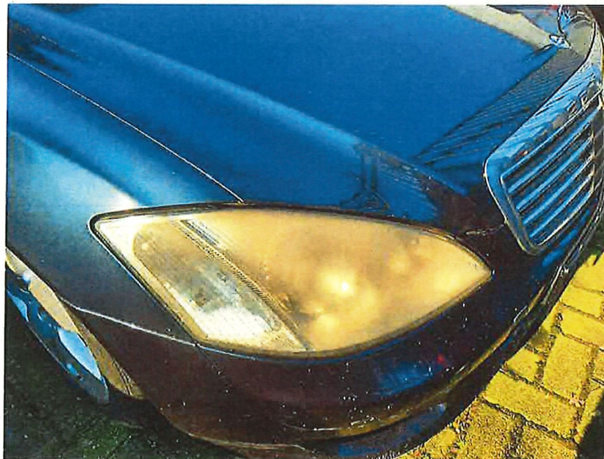
Bild 16 : Frontscheinwerfer links und rechts matt
