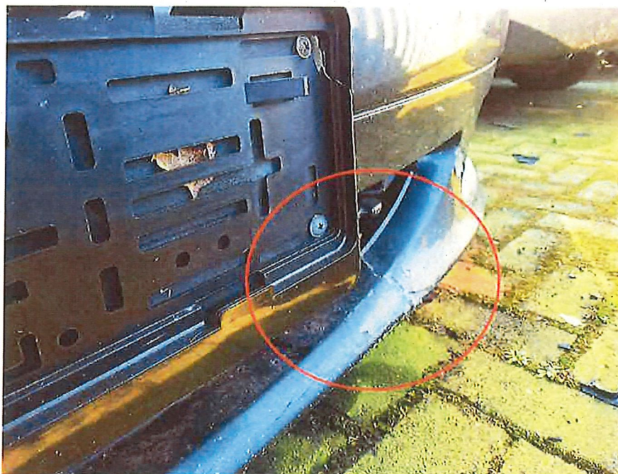
Bild 13 : Stoßfänger vorne verschrammt und gebrochen
