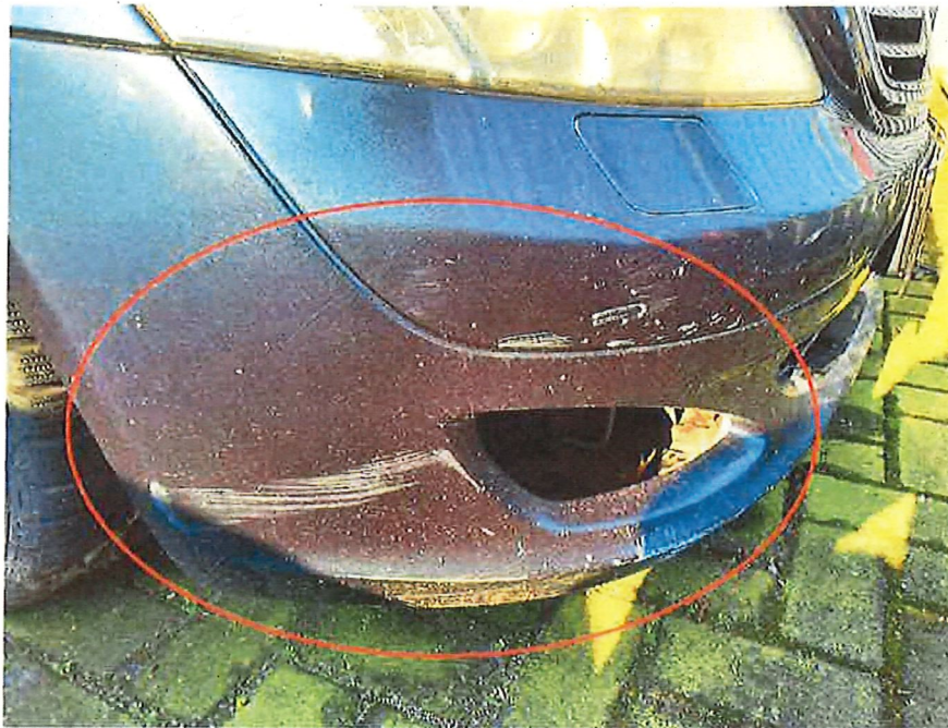
Bild 15 : Stoßfänger vorne verschrammt und gebrochen
