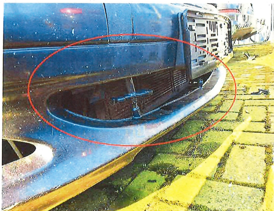
Bild 14 : Lüftungsgitter vorne unten fehlen
