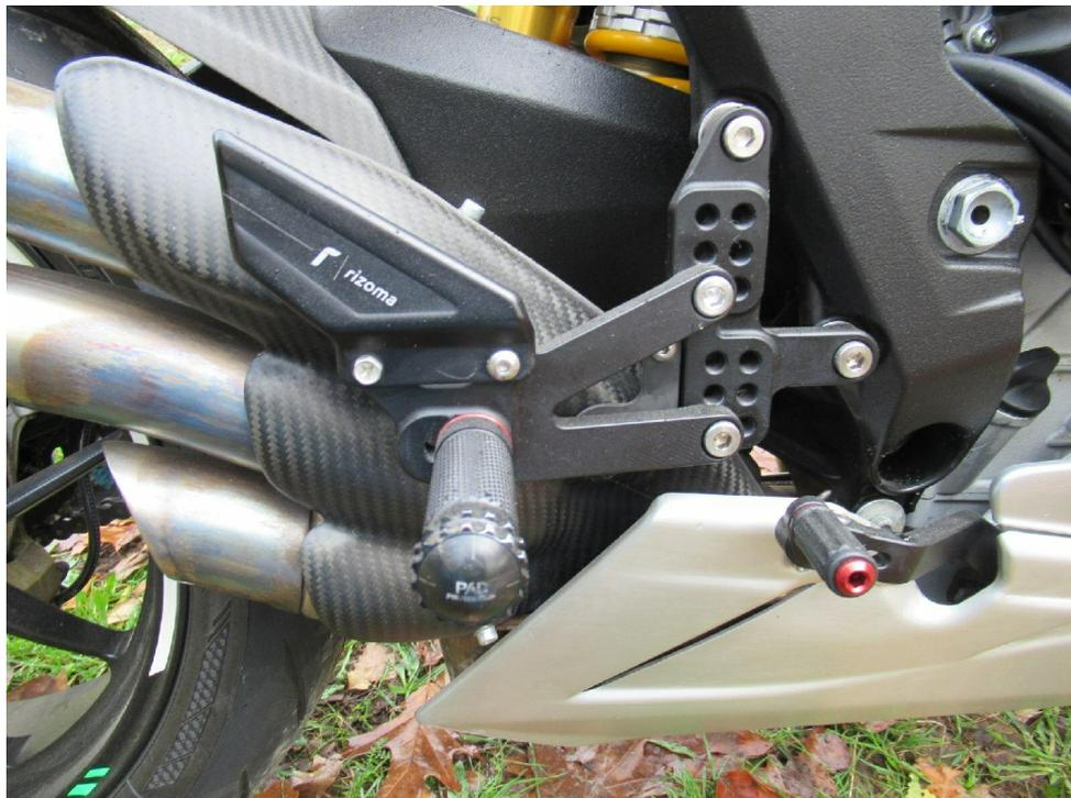
Bild 18 : Fußrastenanlage ( Zubehör )
