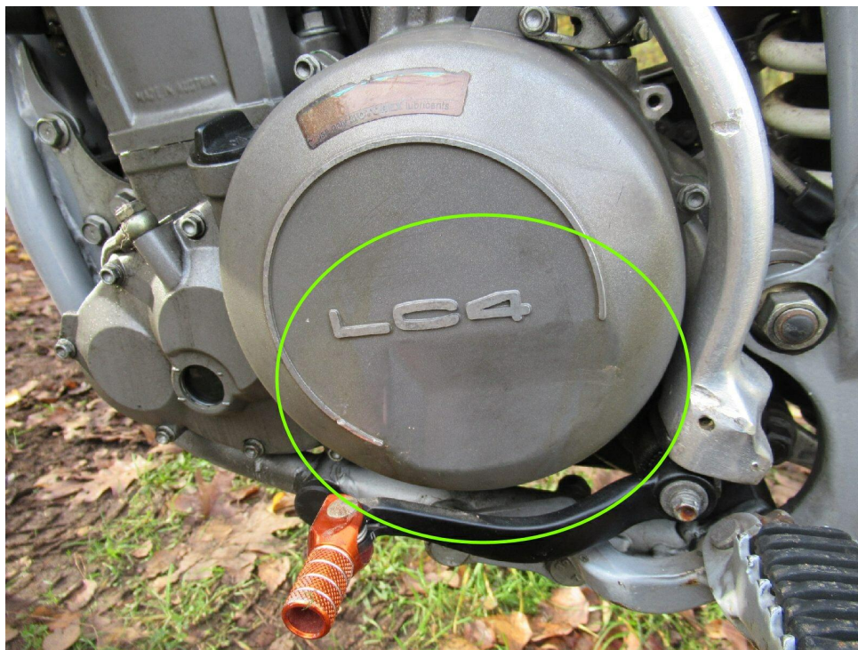
Bild 4 : Motordeckel links eingedellt
