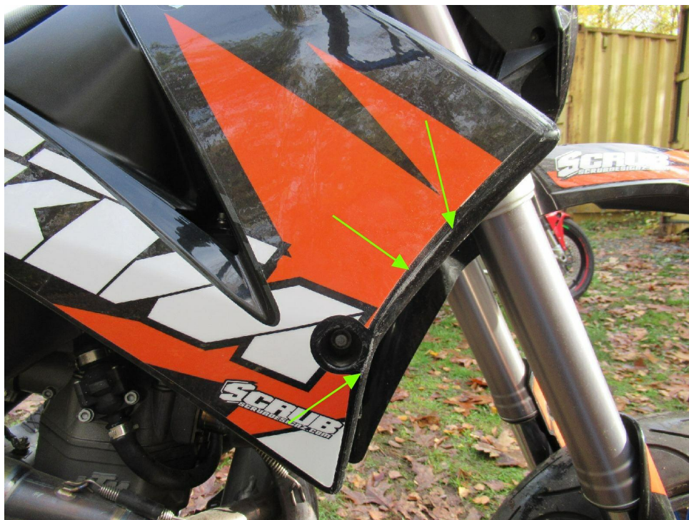
Bild 9 : Verkleidung rechts zerkratzt
