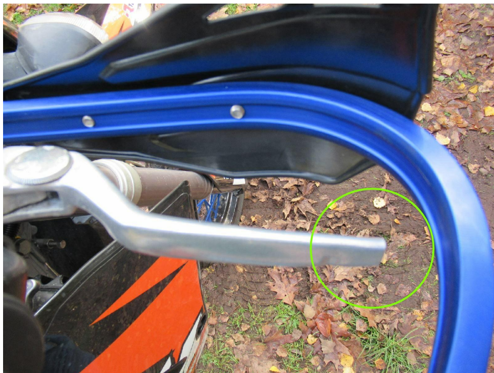
Bild 7 : Bremshebel gekürzt ( nicht zulässig )
