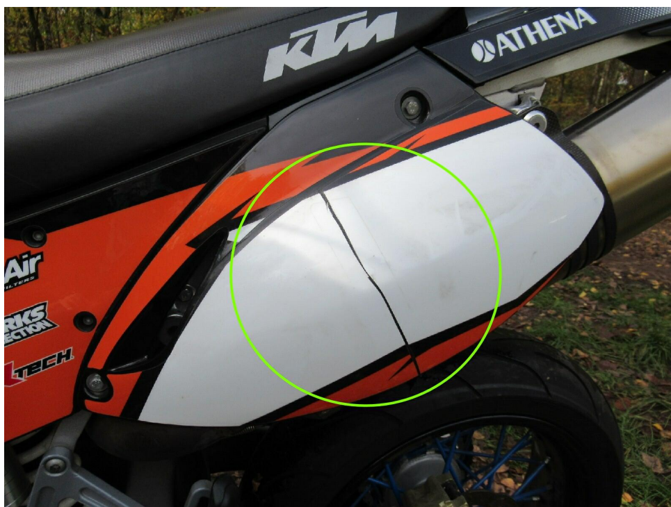
Bild 10 : Verkleidung links zerkratzt
