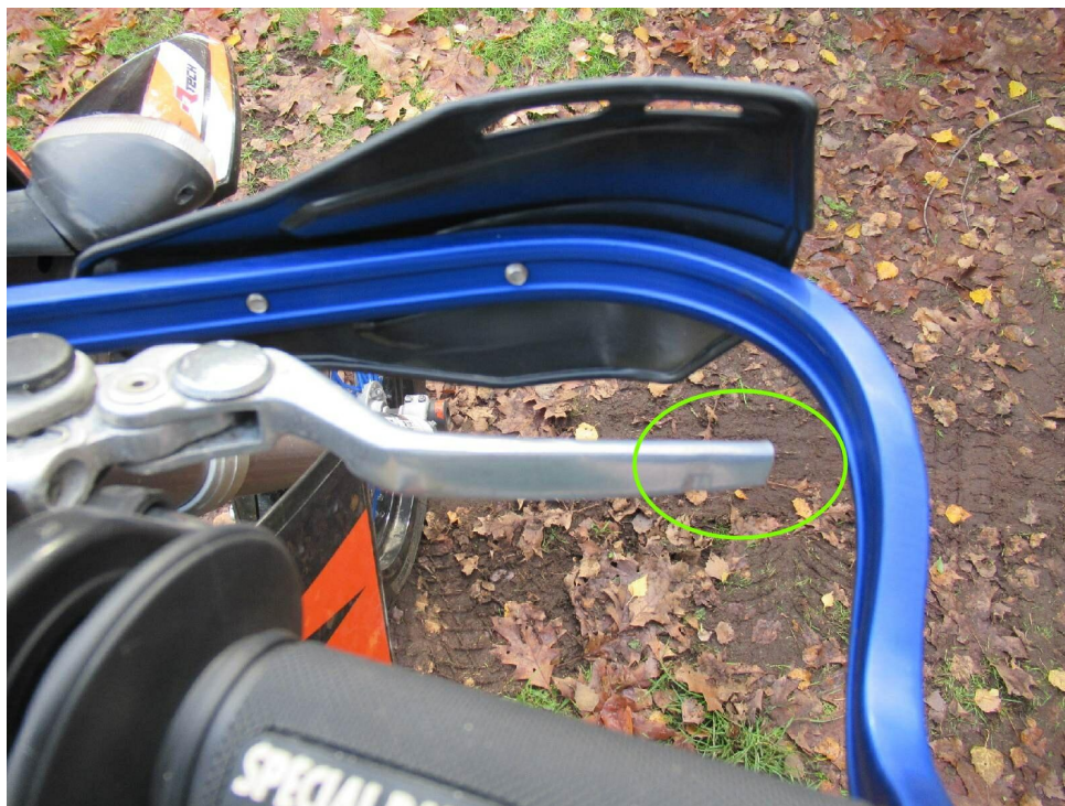
Bild 6 : Kupplungshebel gekürzt ( nicht zulässig )
