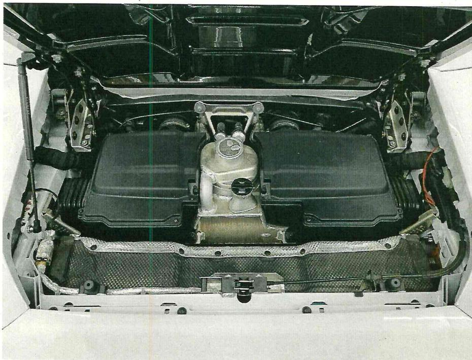
Bild 16 : Servicezugang Motorklappe
