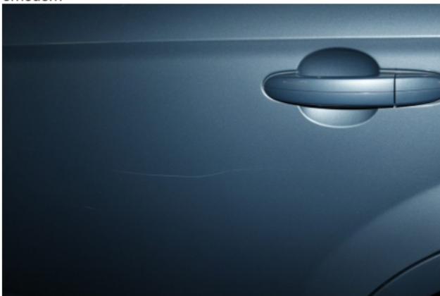
Beschädigung 9: Tür hinten links: Tür - Kratzer - lackieren
