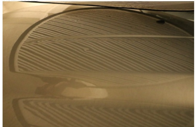
Beschädigung 12: Motorhaube: Motorhaube - Hagelschade... instandsetzen
