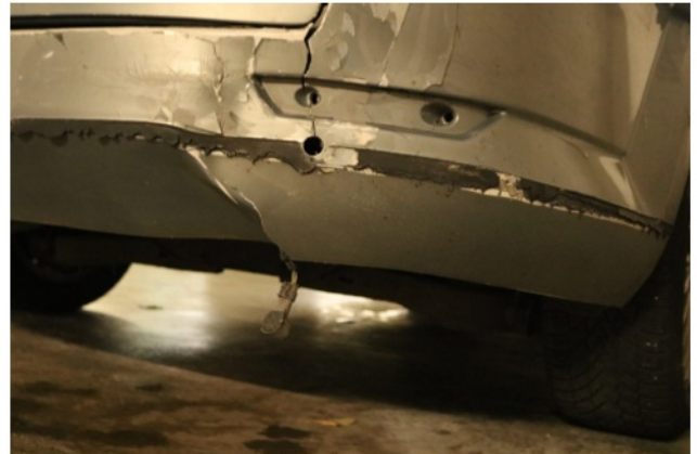
Beschädigung 8: Stossfänger hinten: Stossfänger hinten - defekt - erneuern
