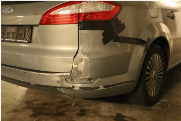
Beschädigung 8: Stossfänger hinten: Stossfänger hinten - defek... erneuern
