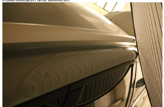
Beschädigung 11: Fahrzeugdach: Dach - Hagelschaden - instandsetzen
