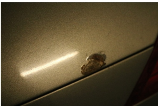
Beschädigung 10: Heckklappe/-tür: Heckklappe - Korrosion - instandsetzen und lackieren
