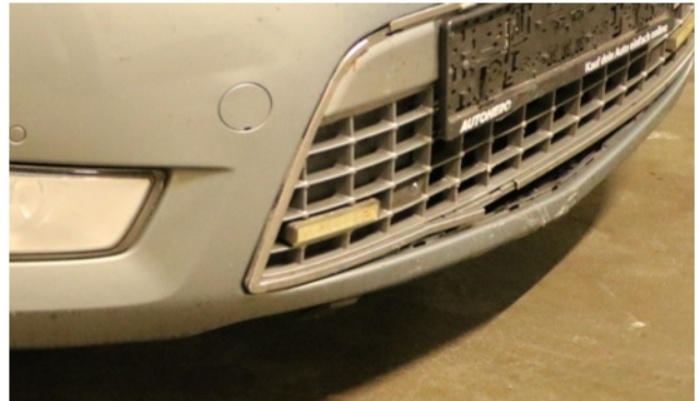
Beschädigung 5: Stossfänger vorn: Stossfänger vorn - gebrochen / gerissen - erneuern
