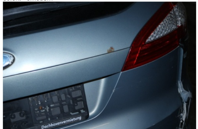
Beschädigung 10: Heckklappe/-tür: Heckklappe - Korrosion - instandsetzen und lackieren
