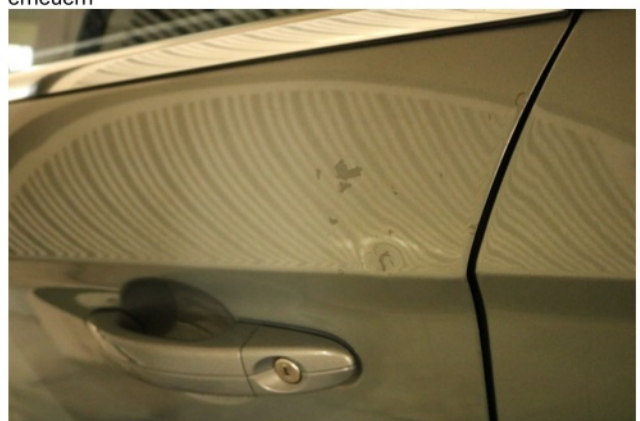
Beschädigung 7: Tür vorn links: Tür - Delle / Lackschaden - instandsetzen und lackieren
