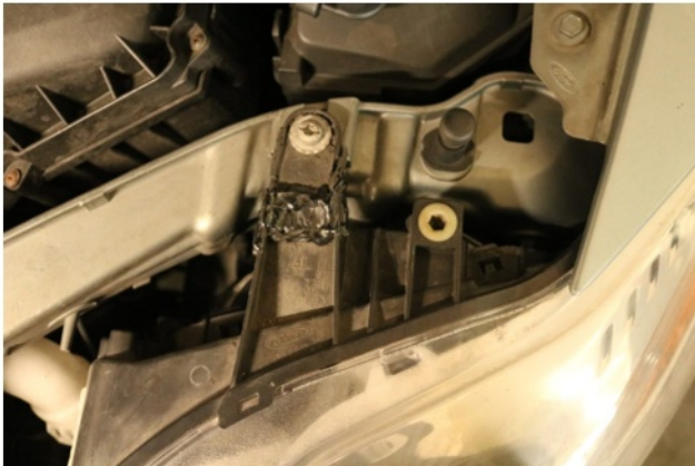
Beschädigung 13: Scheinwerfer: Scheinwerfer links - gebrochen / gerissen - erneuern
