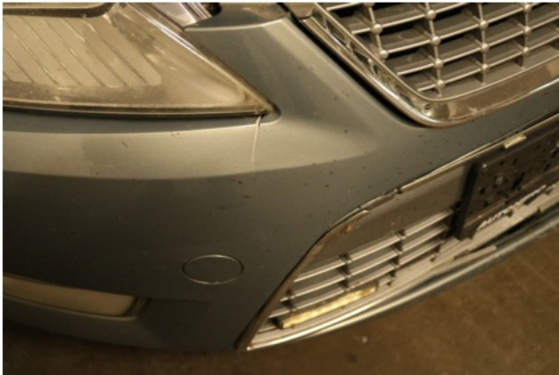
Beschädigung 5: Stossfänger vorn: Stossfänger vorn - gebrochen / gerissen - erneuern
