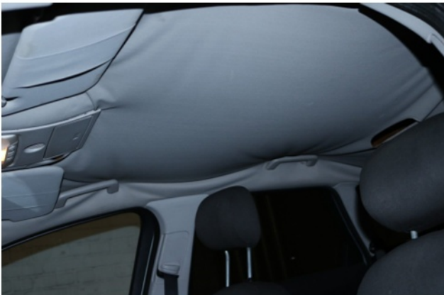
Beschädigung 1: Verkleidungen/Abdeckungen: Dachhimmel - lo...
