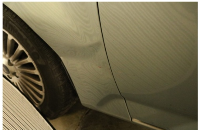
Beschädigung 6: Kotflügel links: Kotflügel links - verformt - erneuern
