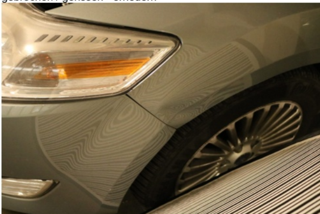
Beschädigung 6: Kotflügel links: Kotflügel links - verformt - erneuern
