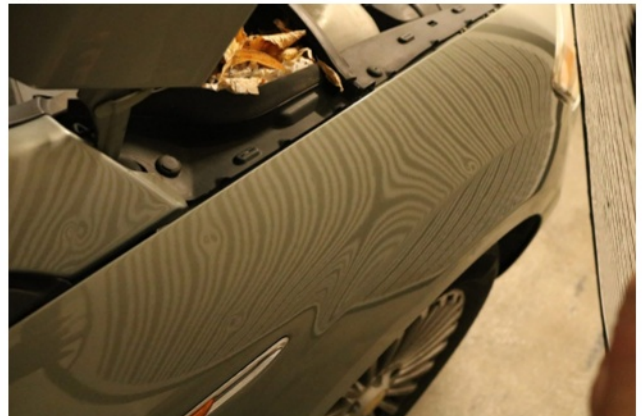
Beschädigung 2: Kotflügel rechts: Kotflügel rechts - Delle(n) - sanft instandsetzen
