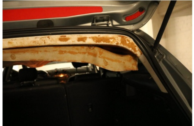
Beschädigung 1: Verkleidungen/Abdeckungen: Dachhimmel - lose -
