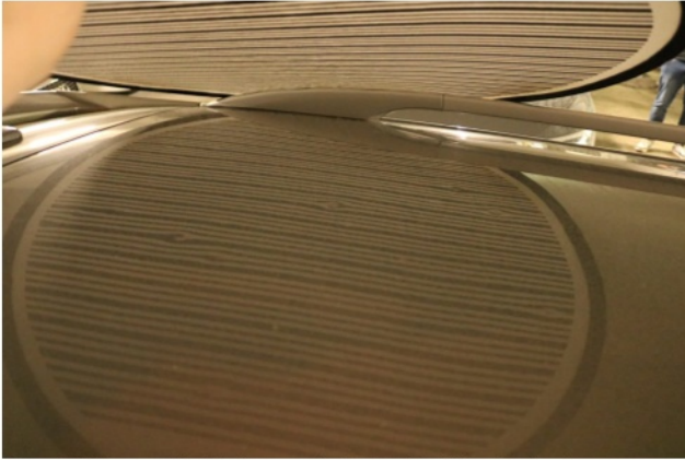
Beschädigung 11: Fahrzeugdach: Dach - Hagelschaden - instandsetzen
