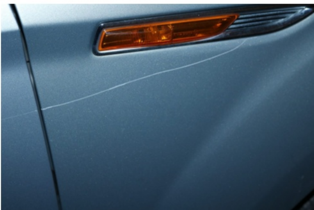
Beschädigung 3: Kotflügel rechts: Kotflügel rechts - Kratzer - Smart Repair
