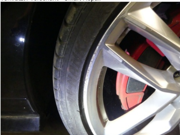
Beschädigung #8: Rad/Reifen: Leichtmetallfelge vorn rechts - verkratzt / verschürft - Smart Repair
