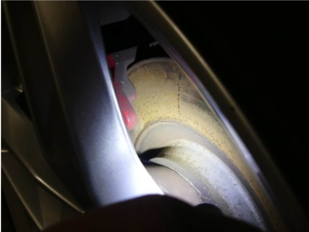
Beschädigung #15: Bremsanlage: Bremsscheiben und Beläge vorn (Stand Schäden) - Korrosion - erneuern
