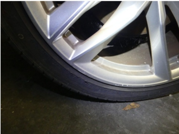
Beschädigung #6: Rad/Reifen: Leichtmetallfelge hinten rechts - verkratzt / verschürft - Smart Repair
