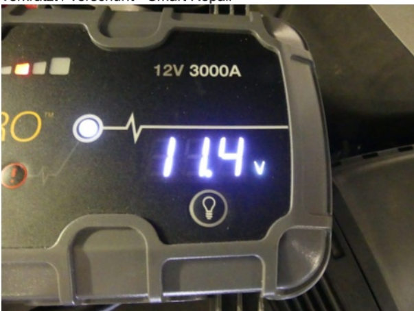
Beschädigung #13: elektrisches System: Batterie (Batterie tiefenentladen - Überbrückungshilfe) - defekt - erneuern
