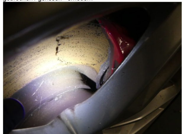
Beschädigung #14: Bremsanlage: Bremsscheiben und Belä... hinten (Stand Schäden) - Korrosion - erneuern
