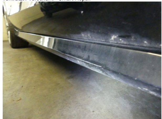
Beschädigung #9: Schweller rechts: Verkleidung - verkratzt / verschürft - Smart Repair
