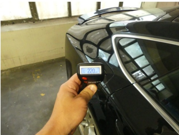
Nachlackierung 5: Seitenwand rechts
