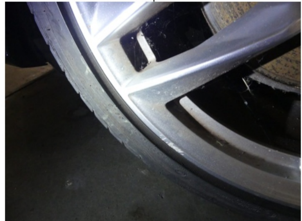
Beschädigung #7: Rad/Reifen: Leichtmetallfelge vorn links - verkratzt / verschürft - Smart Repair
