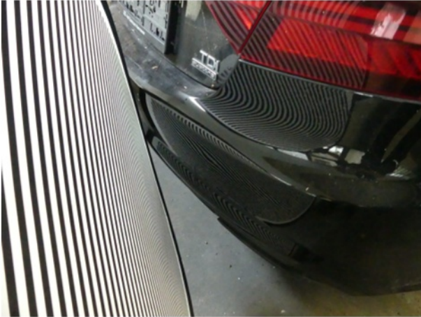
Beschädigung #10: Stossfänger hinten: Stossfänger hinten - Delle / Lackschaden - Smart Repair
