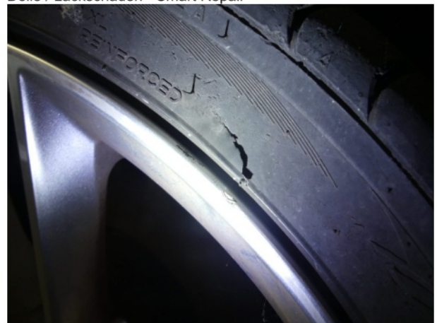
Beschädigung #12: Rad/Reifen: Reifen vorn rechts - gebrochen / gerissen - erneuern
