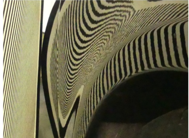
Beschädigung #16: Kotflügel rechts: Kotflügel rechts (Wellig, Staubeinschlüsse) - nicht fachgerecht instandgesetzt -
