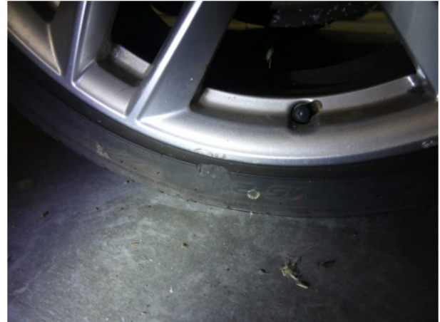
Beschädigung #5: Rad/Reifen: Leichtmetallfelge hinten links - verkratzt / verschürft - Smart Repair
