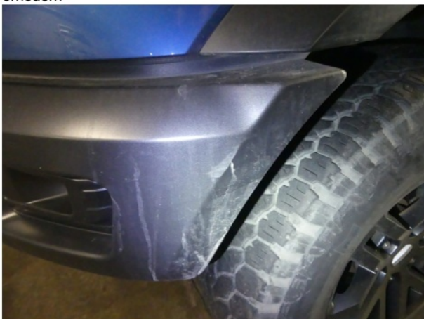
Beschädigung #11: Stossfänger vorn: Stossfänger vorn (unlackiert) - verkratzt / verschürft - erneuern
