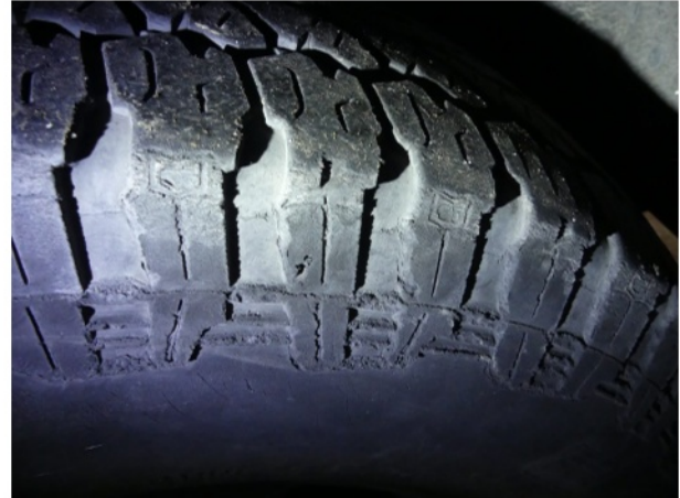
Beschädigung #9: Rad/Reifen: Reifen vorn - porös / rissig - erneuern
