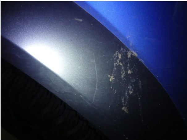
Beschädigung #4: Seitenwand rechts: Radlauf - Kratzer - Smart Repair
