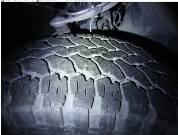
Beschädigung #9: Rad/Reifen: Reifen vorn - porös / rissig - erneuern
