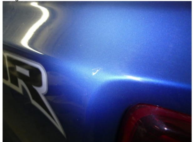
Beschädigung #5: Seitenwand links: Seitenwand - Kratzer - Smart Repair
