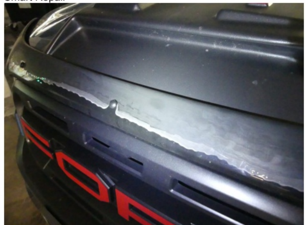
Beschädigung #7: Motorhaube: Luftgitter (Steinschlagschutz... gebrochen / gerissen - erneuern
