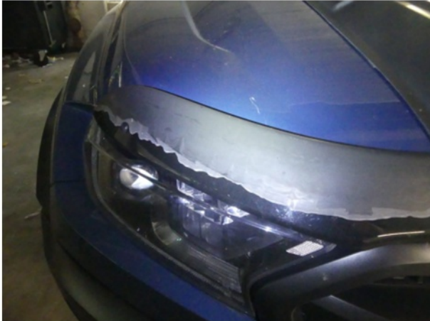
Beschädigung #7: Motorhaube: Luftgitter (Steinschlagschutz) - gebrochen / gerissen - erneuern
