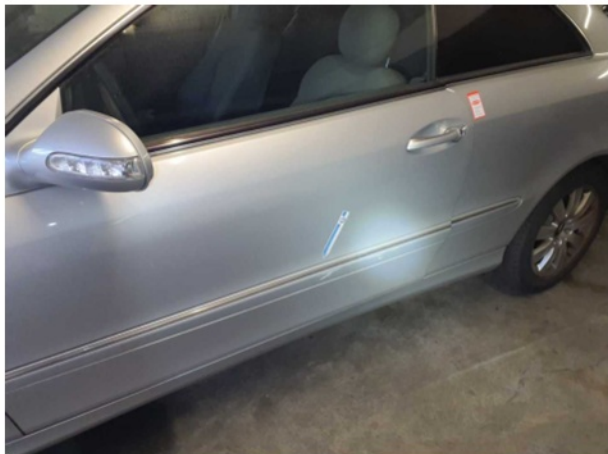
Beschädigung 5: Tür vorn links: Zierleiste Mitte - verkratzt / verschürft - Smart Repair
