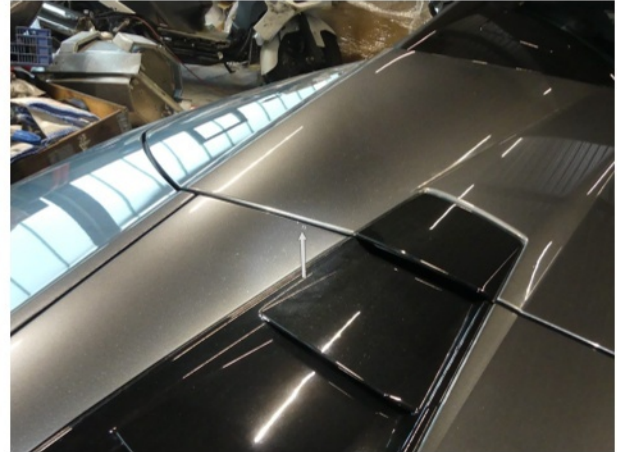
Beschädigung #21: Heckklappe/-tür: Heckklappe - Kratzer
