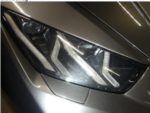
Beschädigung #13: Scheinwerfer: Scheinwerfer rechts - Steinschlag
