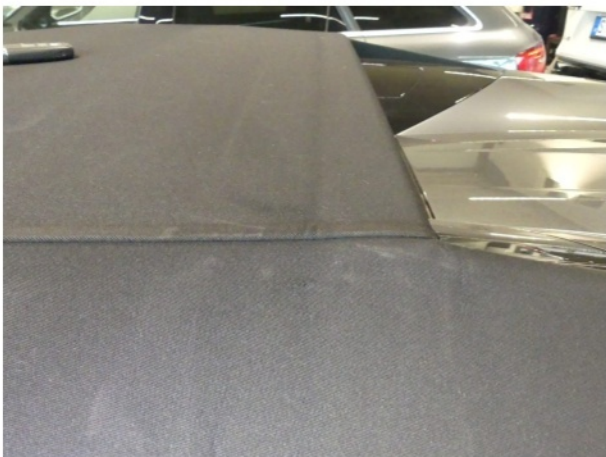
Beschädigung #10: Fahrzeugdach: Verdeck (Hochdruckreiniger Spuren) - beschädigt
