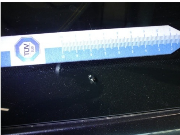
Beschädigung #7: Verglasung: Frontscheibe (Rissbildung) - Steinschlag
