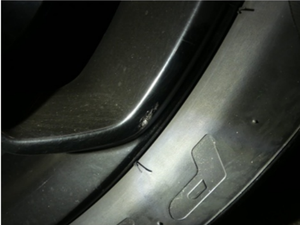
Beschädigung #20: Rad/Reifen: Leichtmetallfelge hinten rechts - Kratzer
