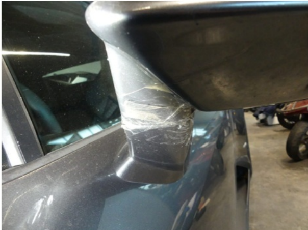
Beschädigung #1: Außenspiegel links: Außenspiegel - gebroche... gerissen
