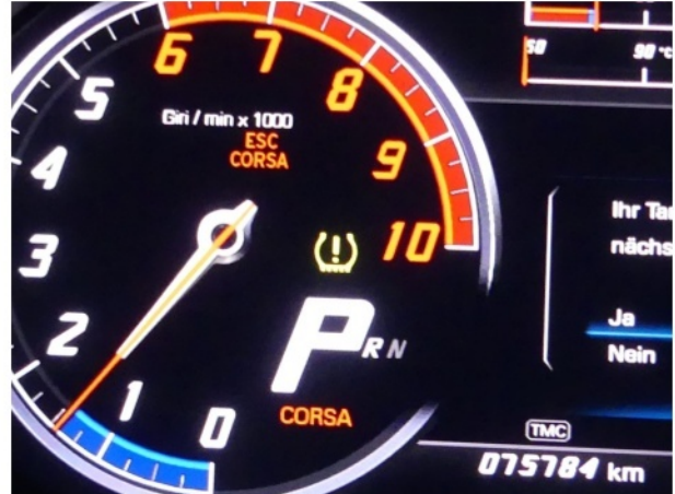
Beschädigung #2: Instrumententafel: Kontrollleuchte (Reifenluftdruck) - leuchtet
