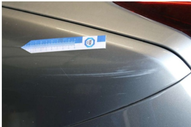
Beschädigung 10: Seitenwand links: Seitenwand - Kratzer - lackieren
