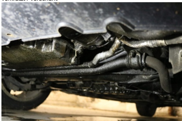
Beschädigung 5: Motor: Motor - undicht - Diagnose durchführen
