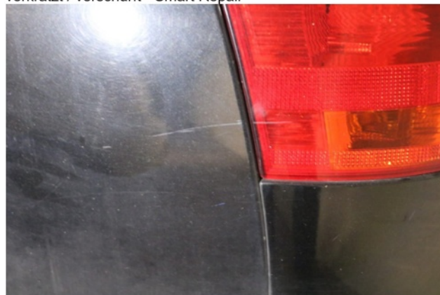
Beschädigung 4: Seitenwand links: Seitenwand - Kratzer - Smart Repair
