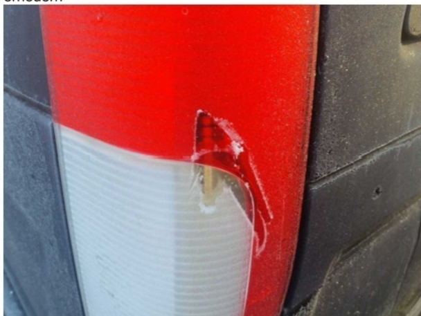
Beschädigung 4: Heckleuchte: Heckleuchte rechts - gebrochen / gerissen - erneuern
