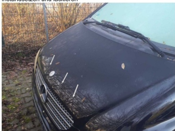
Beschädigung 9: Motorhaube: Motorhaube - verformt - instandsetzen und lackieren
