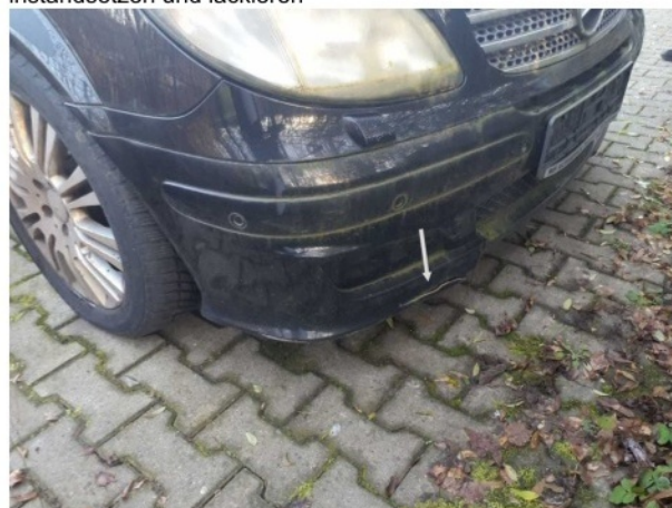
Beschädigung 6: Stossfänger vorn: Stossfänger vorn - gebrochen / gerissen - erneuern
