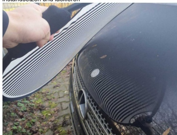
Beschädigung 9: Motorhaube: Motorhaube - verformt - instandsetzen und lackieren
