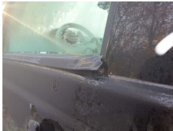
Beschädigung 2: Tür vorn links: Zierleiste oben - verformt - erneuern
