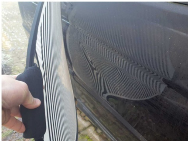
Beschädigung 1: Schiebetür rechts: Schiebetür - verformt - erneuern
