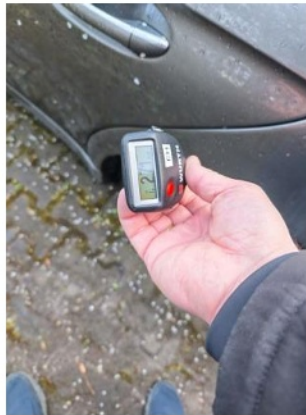
Lackschichtdicke SÄeitenteil hinten links
