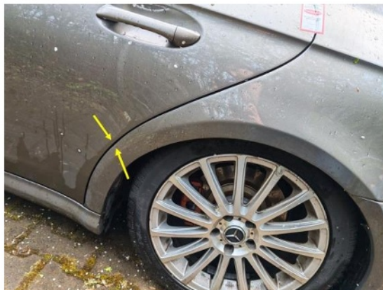
Seitenteil hinten links - Übergang zur Tür hinten links passen die Spaltmasse nicht.
