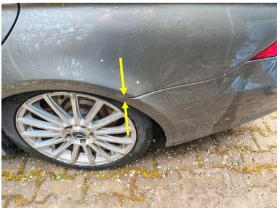
Stoßfängerverkleidung hinten - Übergang zur Seitenwand hinten links passt nicht.
