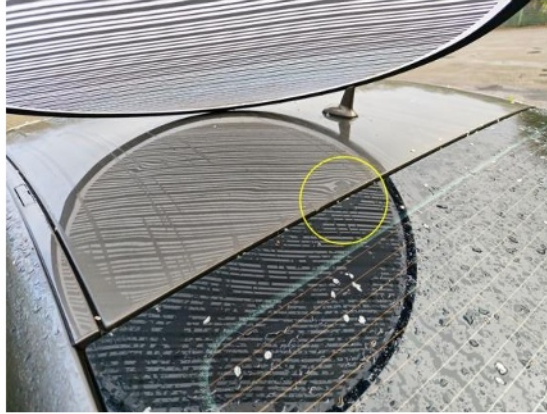
Dach mehrfach eingedellt
