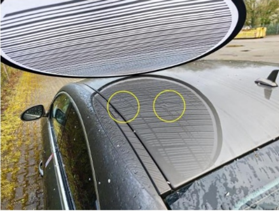
Dach mehrfach eingedellt
