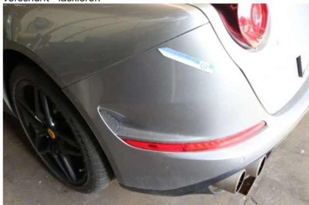
Beschädigung 7: Stossfänger hinten: Stossfänger hinten - Kratzer - lackieren
