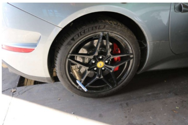
Beschädigung 2: Rad/Reifen: Leichtmetallfelge hinten rechts - verkratzt / verschürft - Smart Repair
