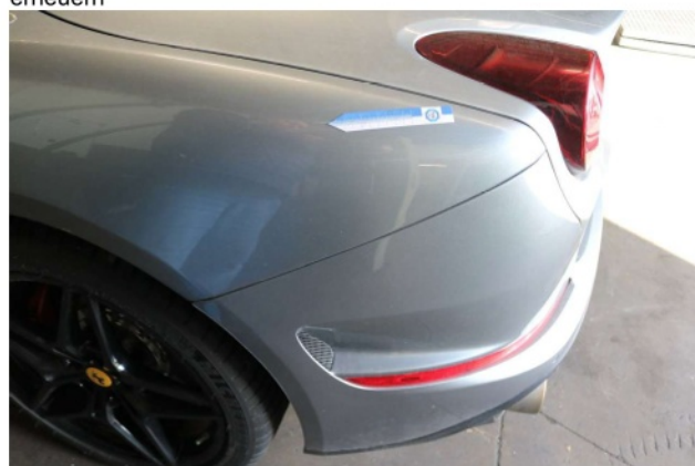
Beschädigung 10: Seitenwand links: Seitenwand - Kratzer - lackieren
