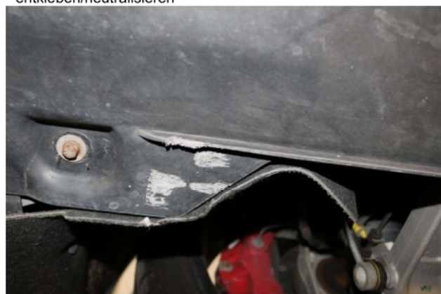
Beschädigung 4: Karosserie: Unterbodenverkleidung - gebrochen / gerissen - erneuern
