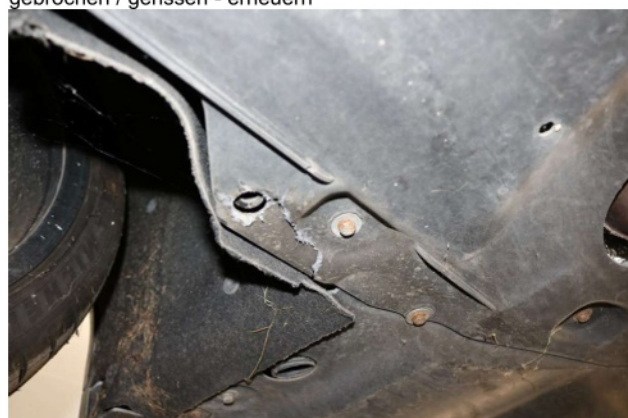
Beschädigung 4: Karosserie: Unterbodenverkleidung - gebrochen / gerissen - erneuern
