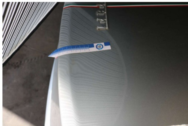
Beschädigung 8: Heckklappe/-tür: Heckklappe - verformt - instandsetzen und lackieren
