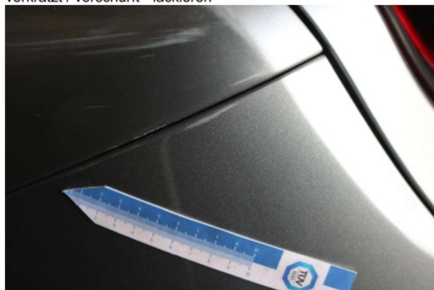
Beschädigung 7: Stossfänger hinten: Stossfänger hinten - Kratzer - lackieren
