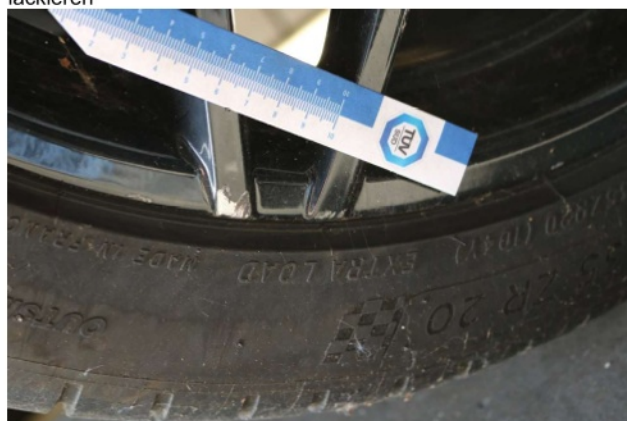
Beschädigung 2: Rad/Reifen: Leichtmetallfelge hinten recht... verkratzt / verschürft - Smart Repair
