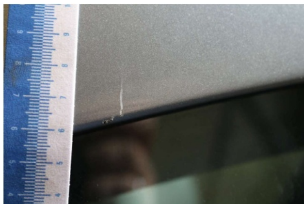
Beschädigung 1: Karosserie: C-Säule links - Kratzer - lackieren
