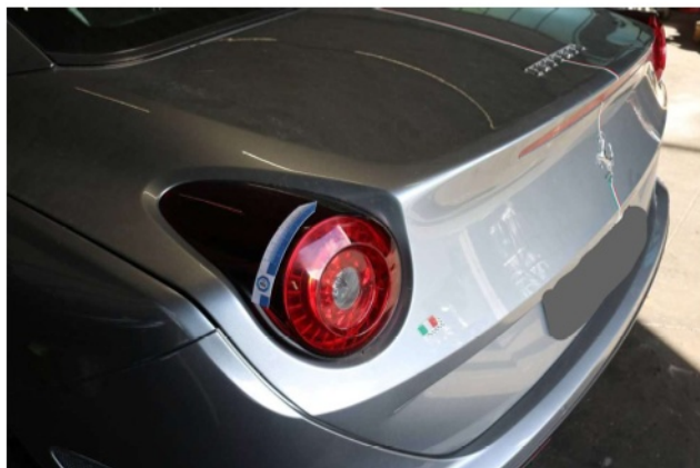
Beschädigung 5: Heckleuchte: Lampenträger links - Kratzer - erneuern
