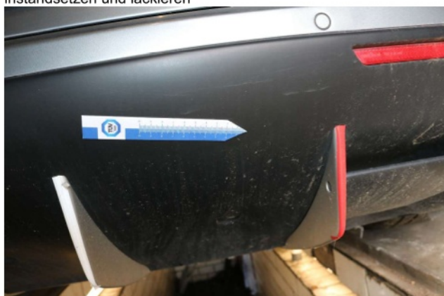
Beschädigung 9: Heckklappe/-tür: Heckspoiler - Kratzer - erneuern
