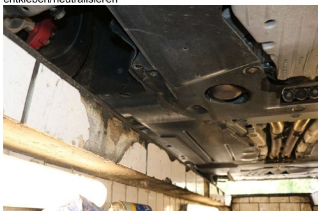
Beschädigung 4: Karosserie: Unterbodenverkleidung - gebrochen / gerissen - erneuern
