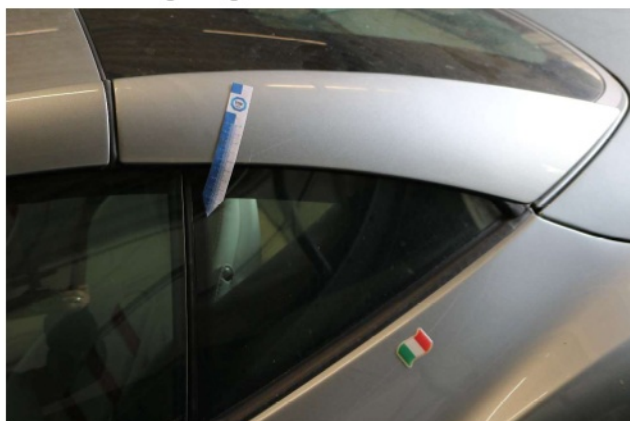
Beschädigung 1: Karosserie: C-Säule links - Kratzer - lackieren
