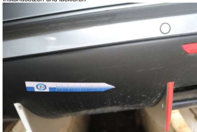
Beschädigung 9: Heckklappe/-tür: Heckspoiler - Kratzer - erneuern
