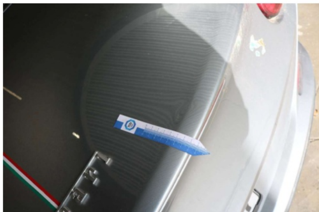
Beschädigung 8: Heckklappe/-tür: Heckklappe - verformt - instandsetzen und lackieren
