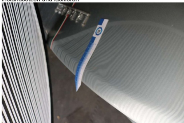
Beschädigung 8: Heckklappe/-tür: Heckklappe - verformt - instandsetzen und lackieren
