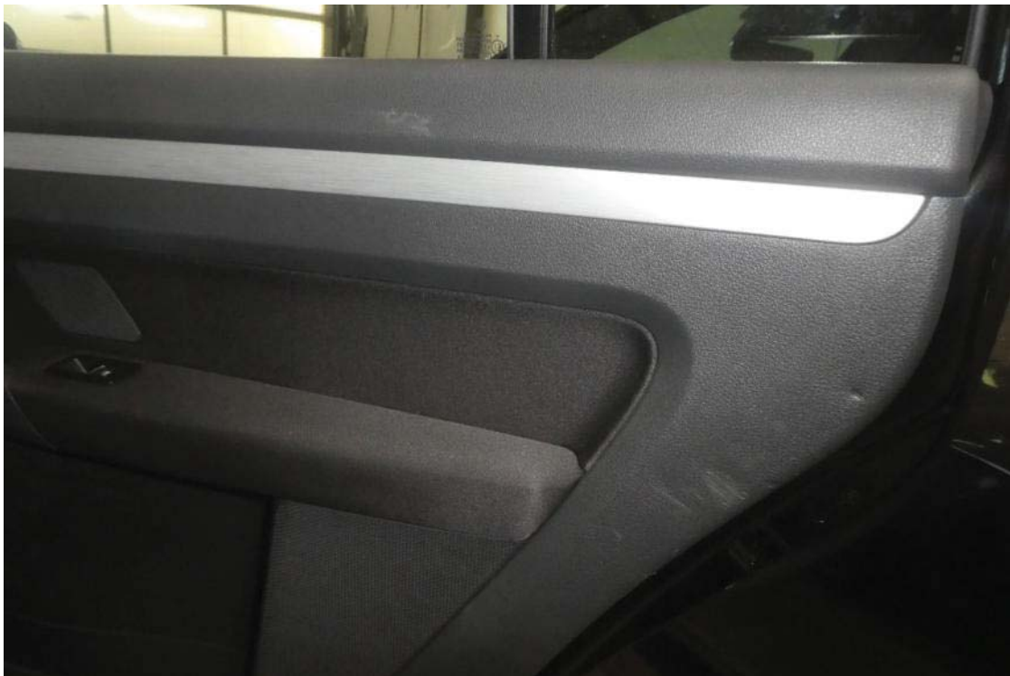
Lackschäden Türen rechts und Beschädigte Verkleidung Tür hinten rechts
