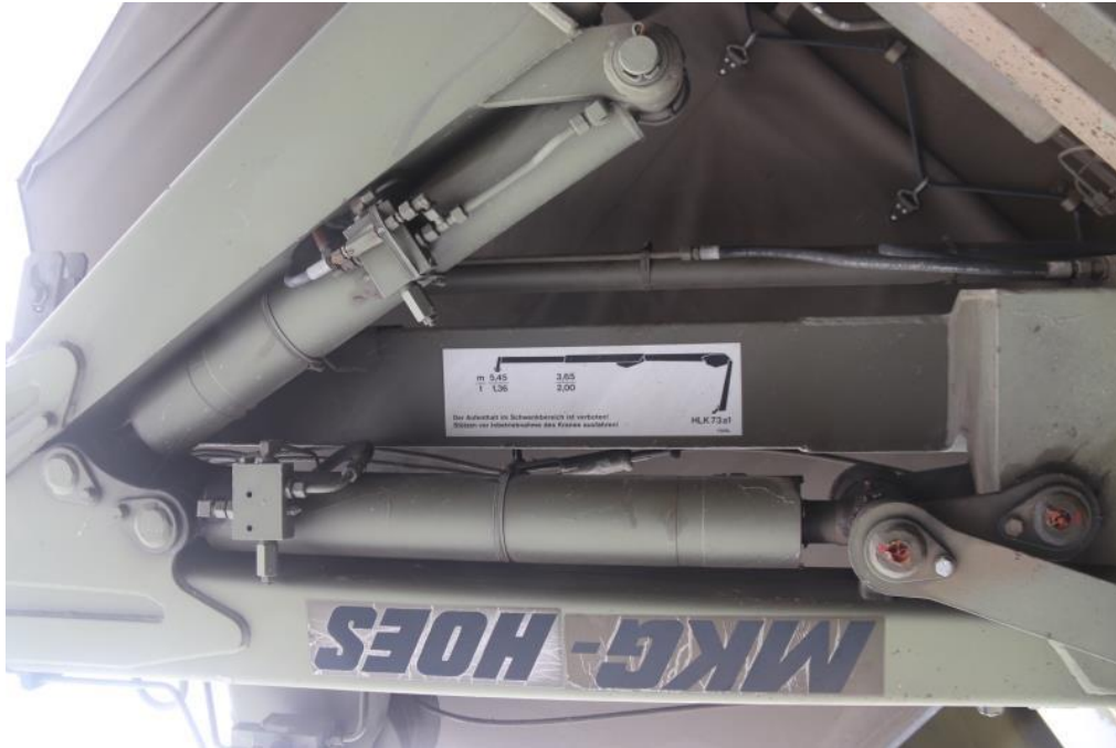
Bild 11: Detail: Ladekran Lastdiagramm
