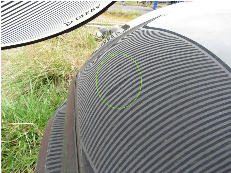
Bild 7 : Motordeckel mehrfach eingedellt
