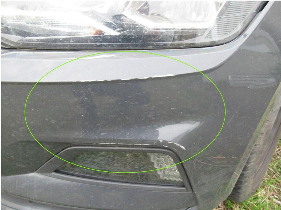
Bild 9 : Stoßfänger linksseitig verschrammt
