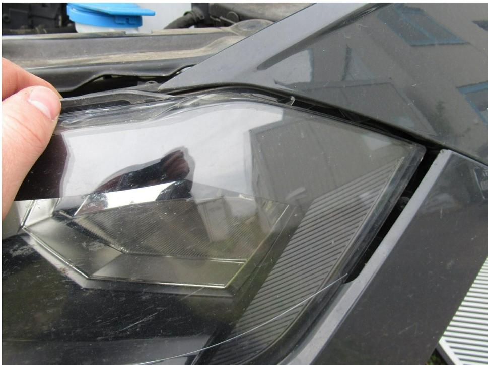
Bild 10 : Hauptscheinwerfer vorne links ist lose/Halterungen gebrochen
