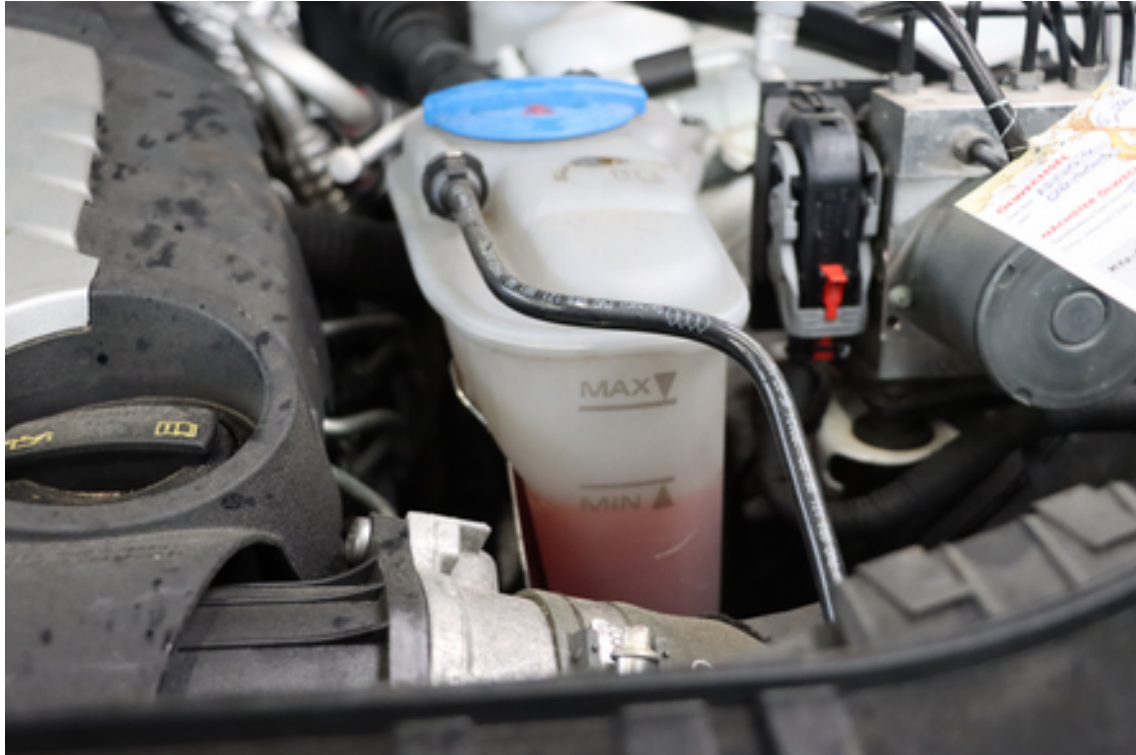
Ausgleichsbehälter Kühlflüssigkeit (Stand der Kühlflüssigkeit unter Min.)
