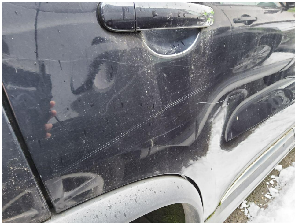
Bild 11 : Türen rechts verkratzt
