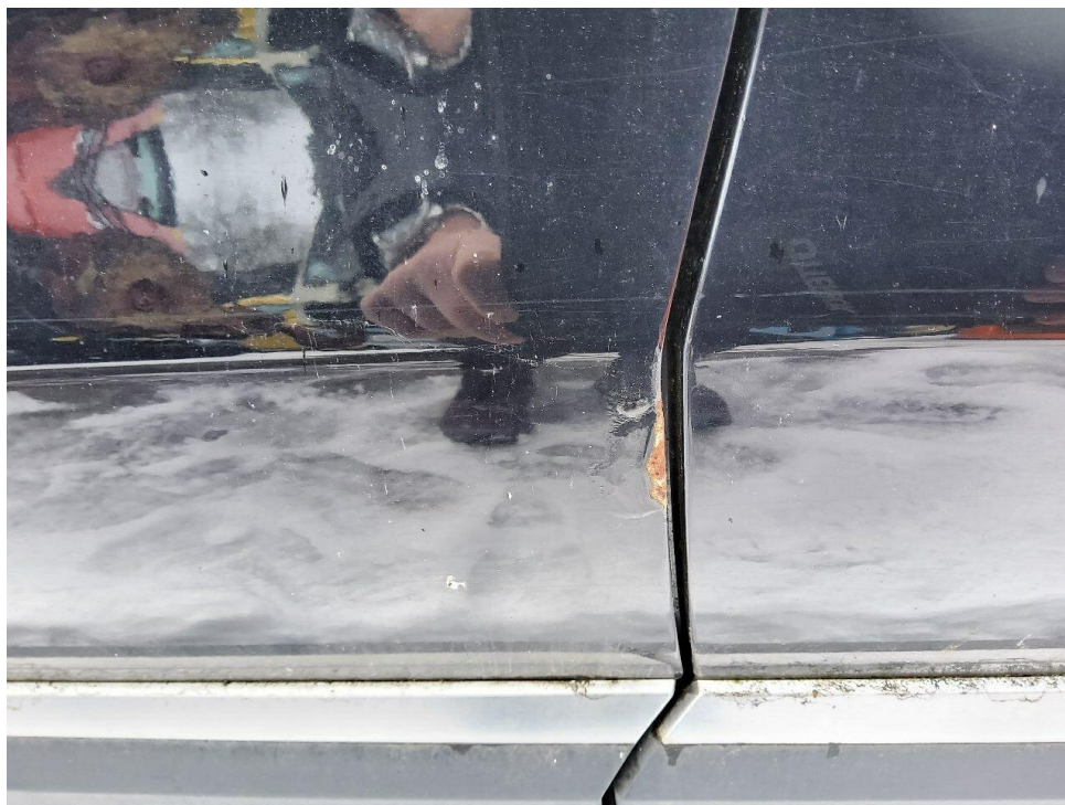
Bild 7 : Korrosionsbildung im Bereich der vorderen Türkante hinten
