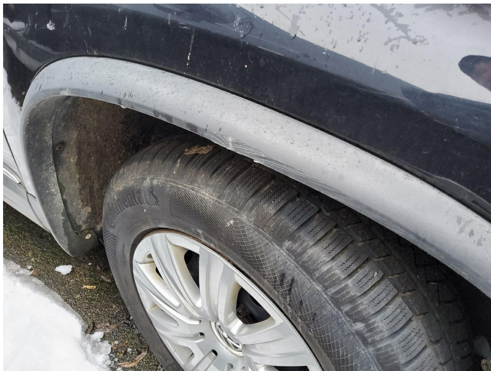
Bild 9 : Radlaufblende vorn rechts verkratzt
