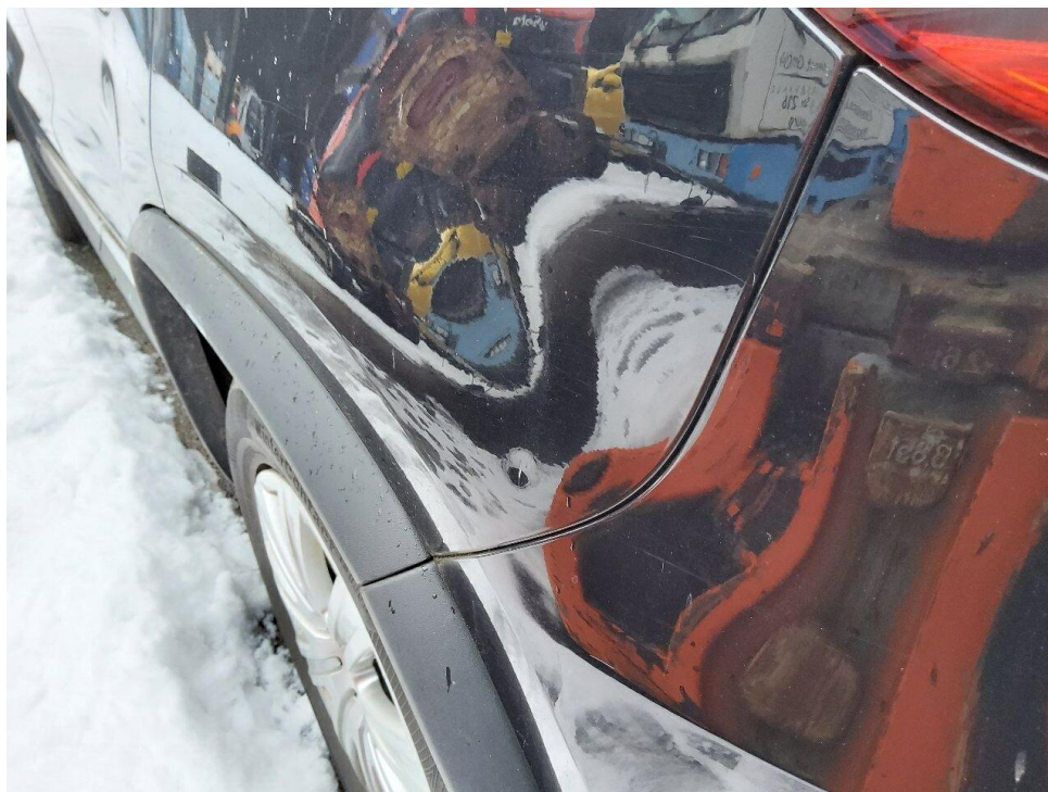
Bild 5 : Seitenteil links eingedellt und verkratzt
