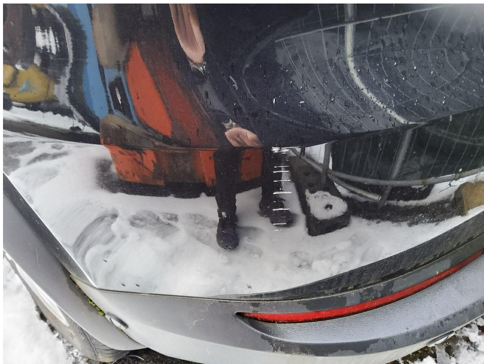
Bild 4 : Stoßfängerverkleidung hinten links verschrammt
