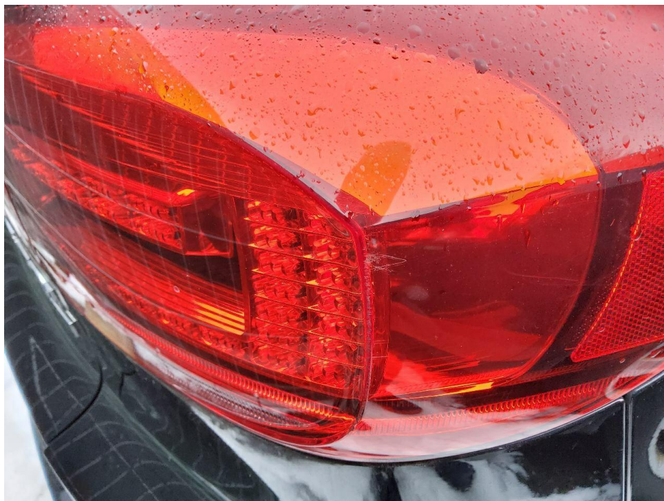
Bild 13 : Seitenteil rechts und Rückleuchte rechts verkratzt
