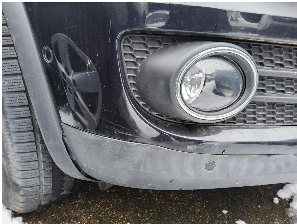
Bild 8 : Stoßfängerverkleidung vorn rechts verkratzt und Radlaufblende ausgebrochen
