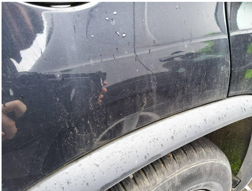
Bild 12 : Seitenteil rechts und Rückleuchte rechts verkratzt
