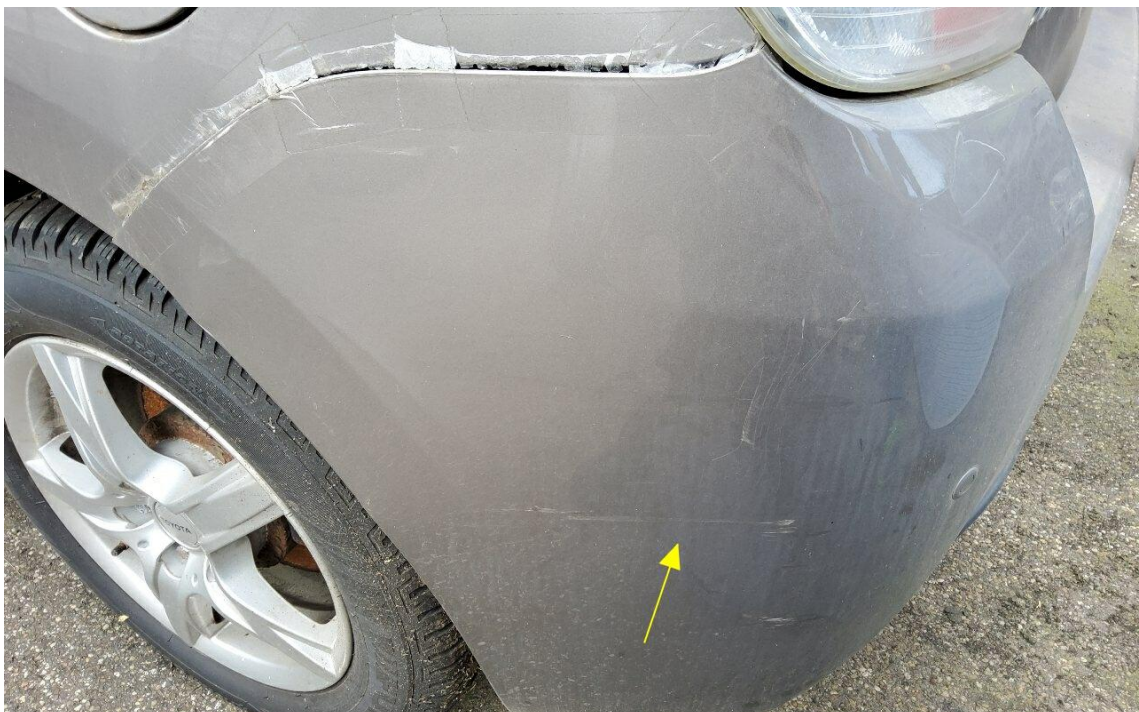
Bild 18 : Stoßfänger hinten verkratzt, plastisch verformt und gebrochen
