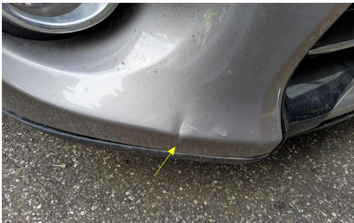
Bild 12 : Stoßfänger vorne verschrammt und plastisch verformt
