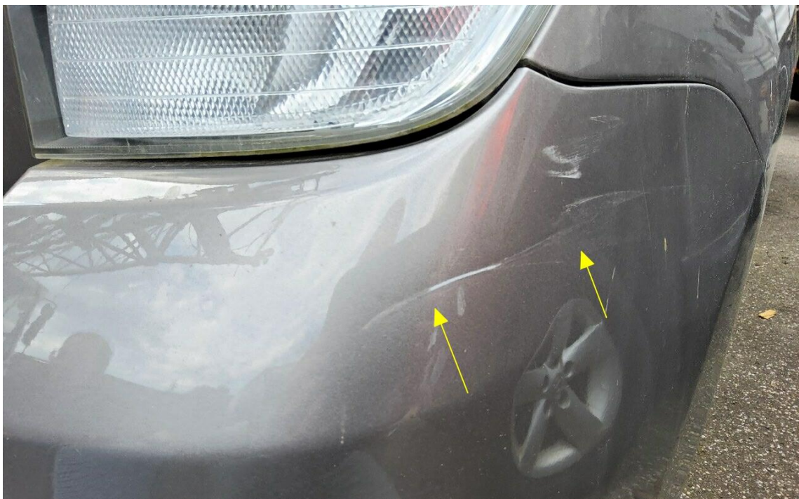
Bild 20 : Stoßfänger hinten verkratzt, plastisch verformt und gebrochen
