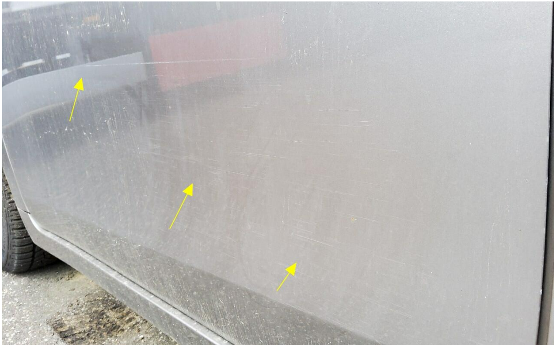
Bild 17 : Tür vorne links zerkratzt
