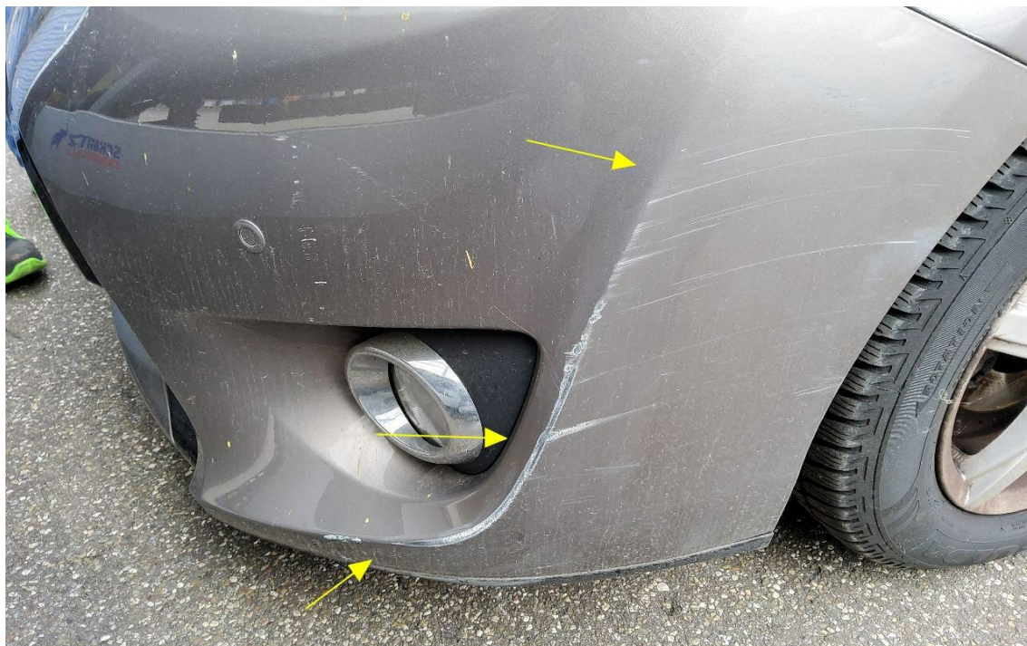
Bild 11 : Stoßfänger vorne verschrammt und plastisch verformt
