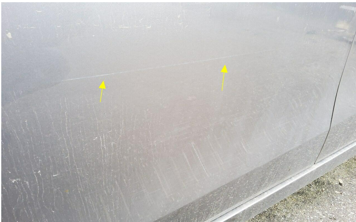
Bild 16 : Tür vorne links zerkratzt
