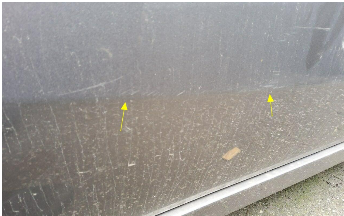
Bild 26 : Tür hinten rechts verkratzt
