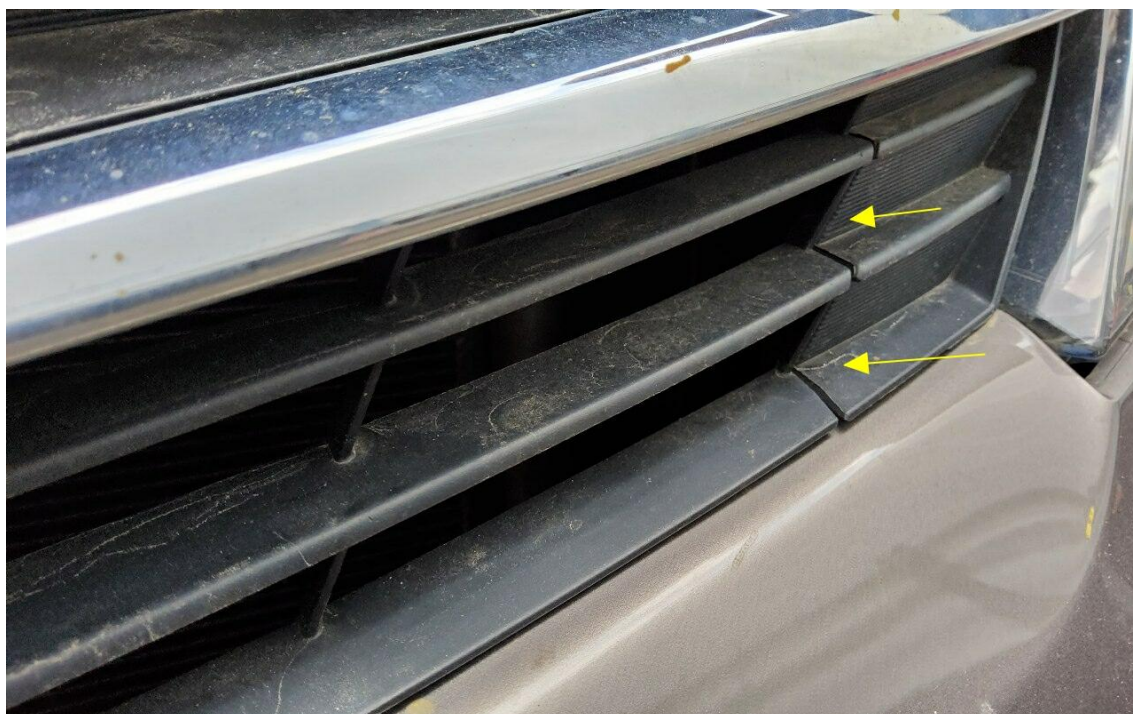
Bild 28 : Kühlergrill links gebrochen
