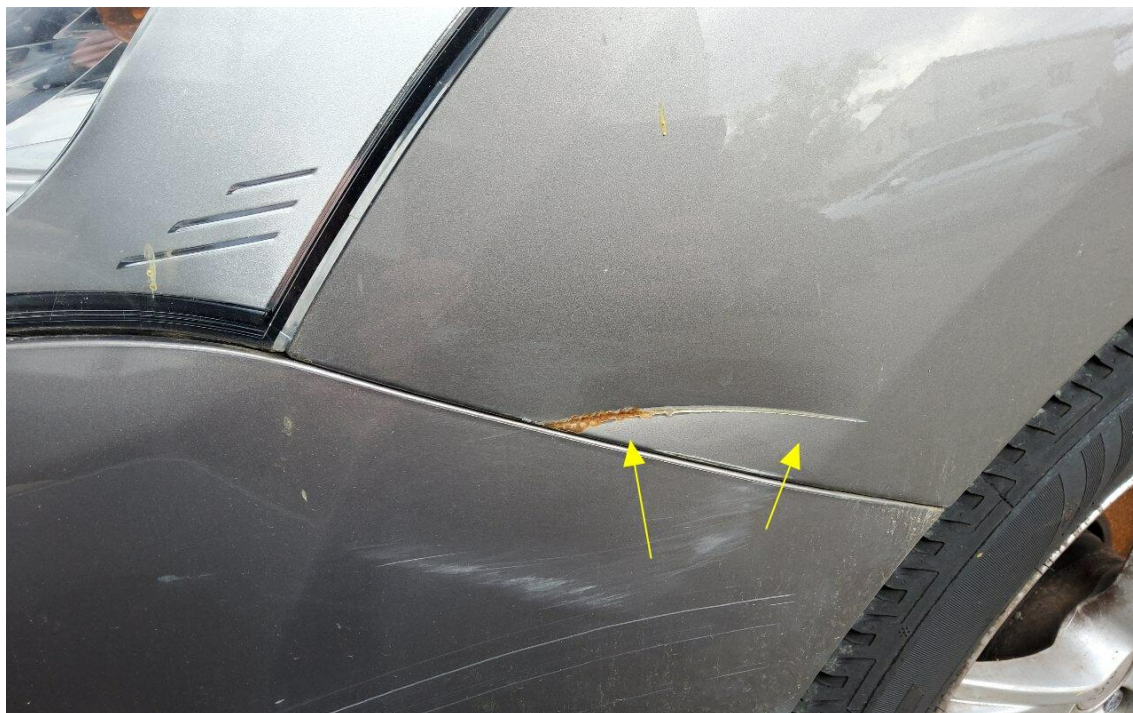
Bild 13 : Kotflügel vorne links deformiert und Rost
