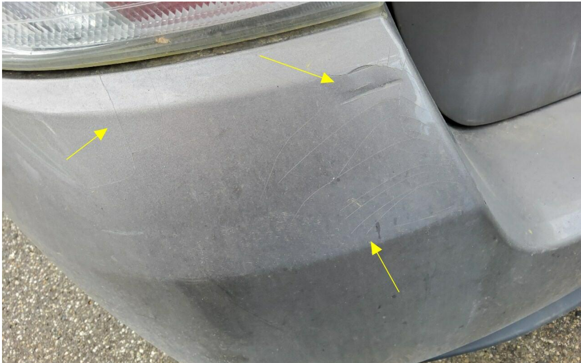
Bild 19 : Stoßfänger hinten verkratzt, plastisch verformt und gebrochen
