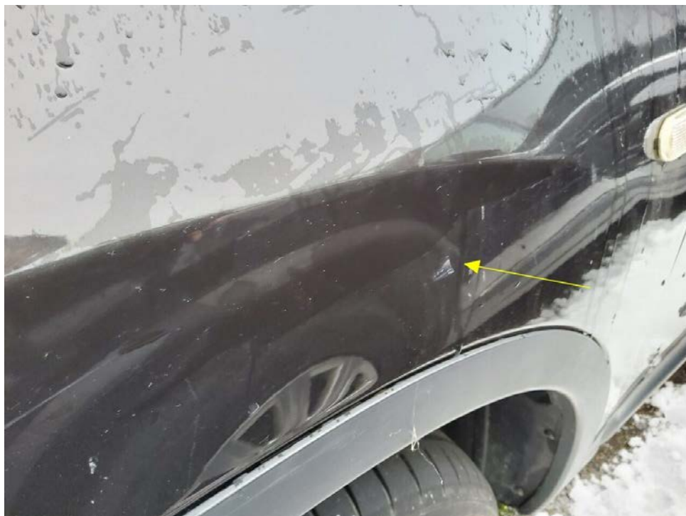
Bild 10 : Kotflügel links deformiert und verschrammt
