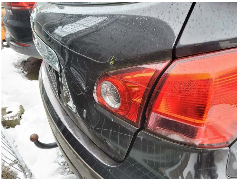
Bild 5 : Heckklappe mehrfach verformt und verschrammt
