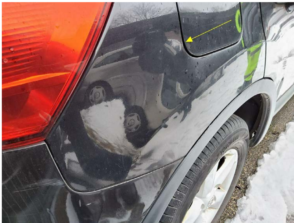
Bild 6 : Seitenteil rechts verschrammt und verformt
