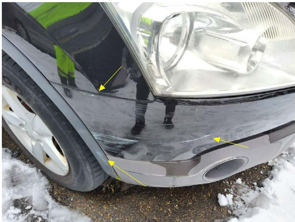
Bild 8 : Stoßfängerverkleidung vorn rechts verschrammt
