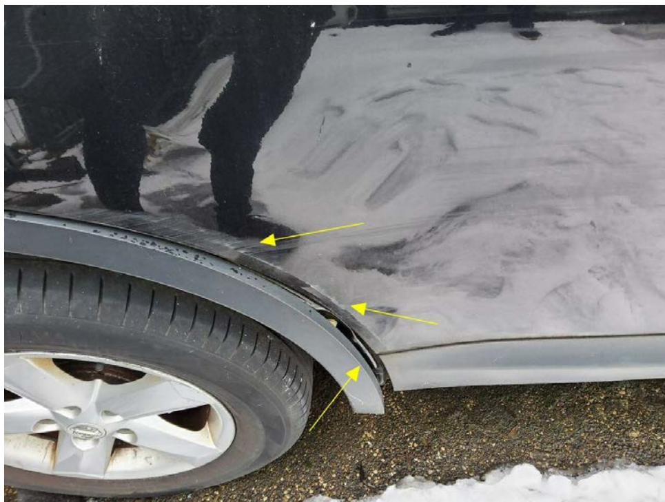
Bild 7 : Tür hinten rechts streifend verschrammt, Radlaufblende hinten rechts ausgebrochen
