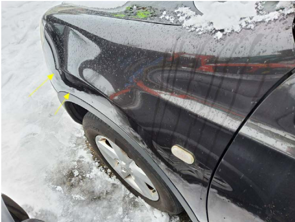
Bild 11 : Kotflügel links deformiert und verschrammt
